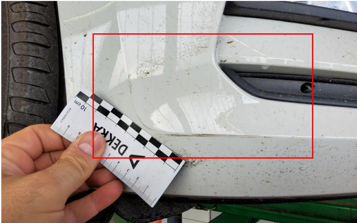
Bild 5 : Stoßfänger vorne Lackierung, verschrammt, smart repair
