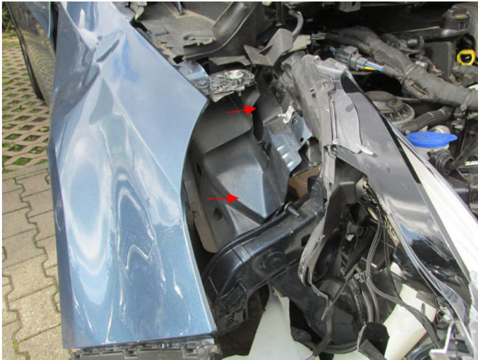
Bild 15 : Radhaus R verzogen teilweise eingeknickt
