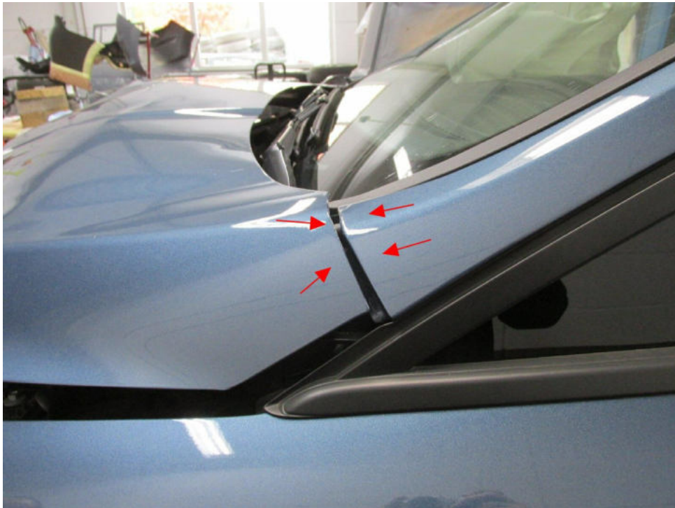
Bild 9 : Motorhaube hinten links gegen Dachrahmen gedrückt
