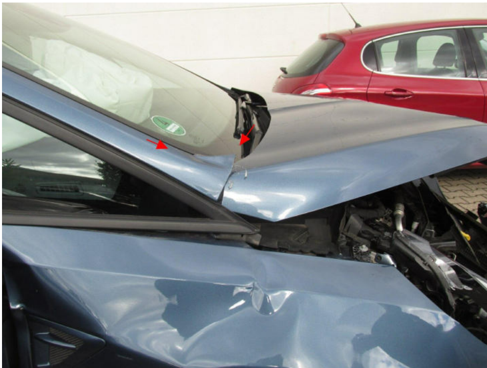
Bild 8 : Motorhaube hinten rechts gegen Dachrahmen gedrückt
