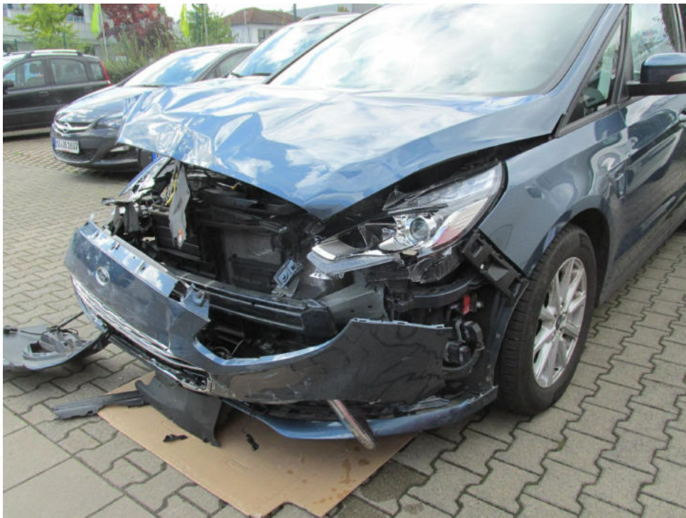
Bild 10 : Der Vorbau ist eingedrückt u. nach rechts hin verzogen. Alle Anbauteile wurden zerstört oder abgerissen
