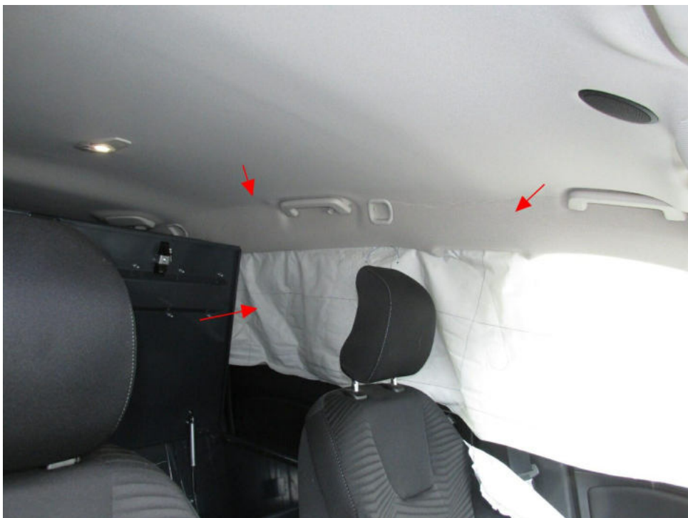
Bild 22 : Kopfairbag L ausgelöst
