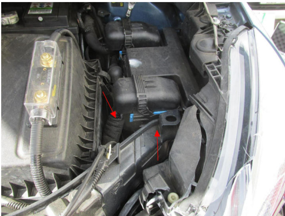
Bild 12 : Frontblech L nach hinten gedrückt, Teile im Radeinbau sind eingeklemmt
