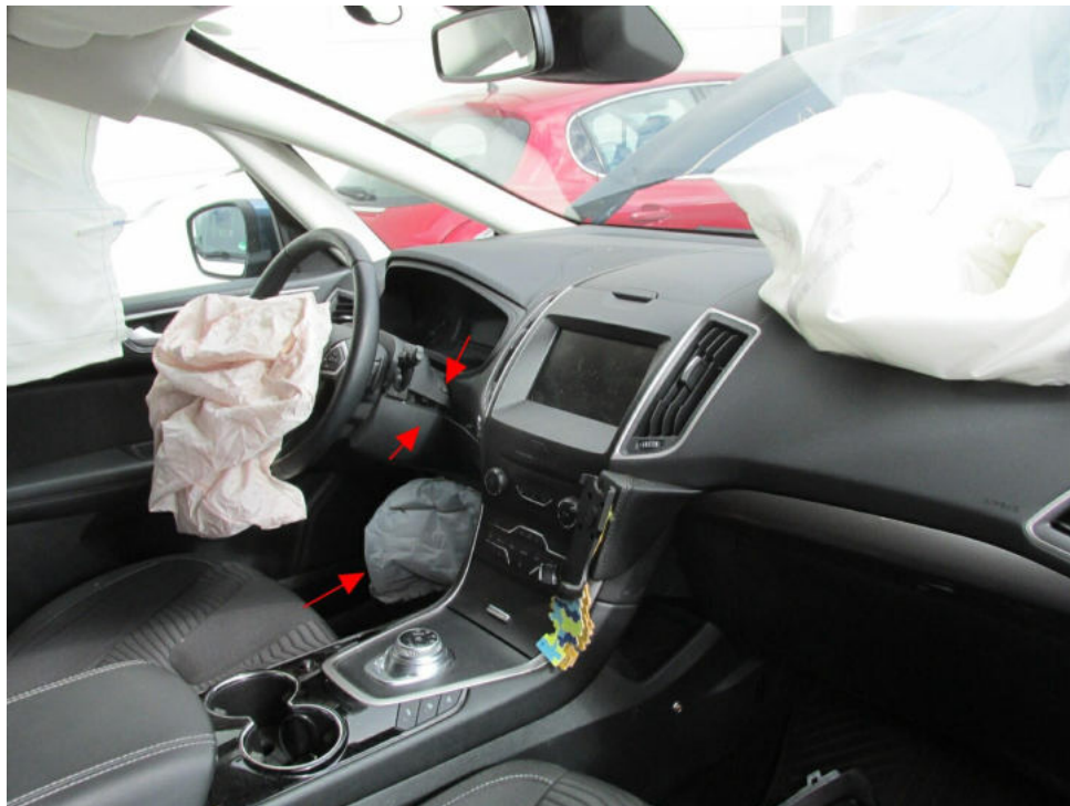
Bild 19 : Airbags V ausgelöst. Lenkradverkleidung auseinander gedrückt
