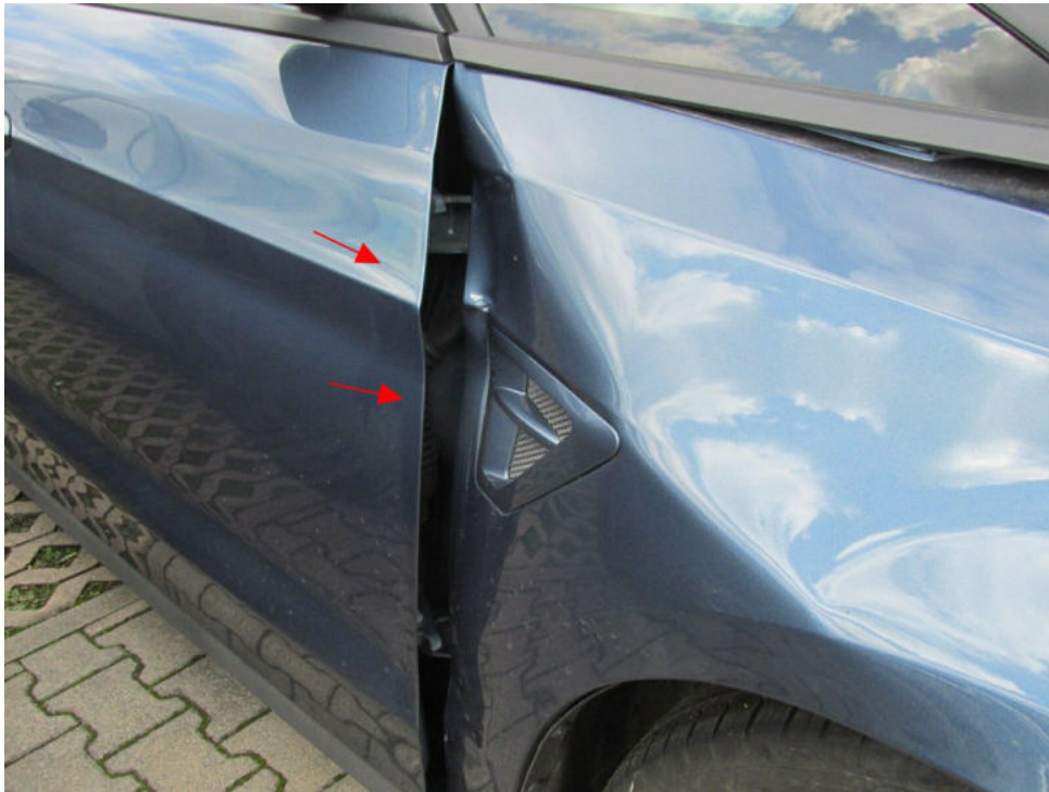
Bild 7 : Tür VR Kante angestoßen, ist wellig
