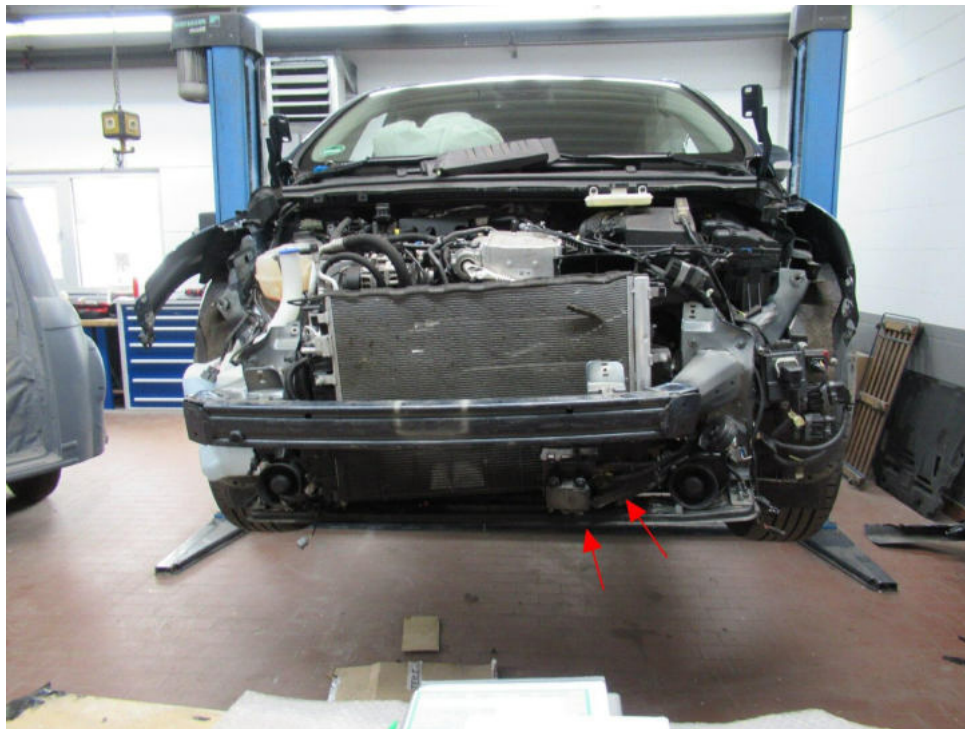
Bild 23 : 2. Besichtigung am 04.10.2022 nach dem Abbau der Anbauteile Drehzahlsensor mit Halter nach hinten gedrückt
