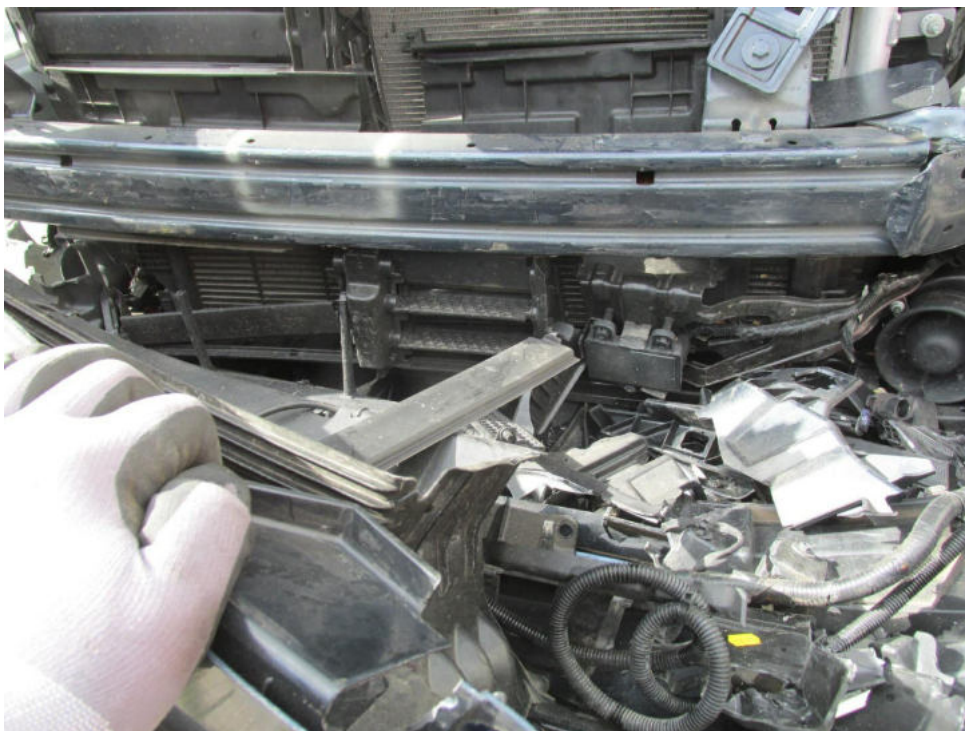
Bild 18 : Kühler-Paket mit Leitungen sowie Schläuchen eingeklemmt. Alle Verkleidungen V zerstört
