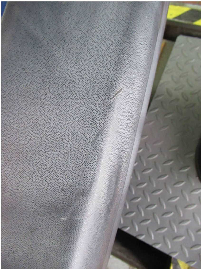
Bild 8 : Stoßfänger hinten eingekerbt
