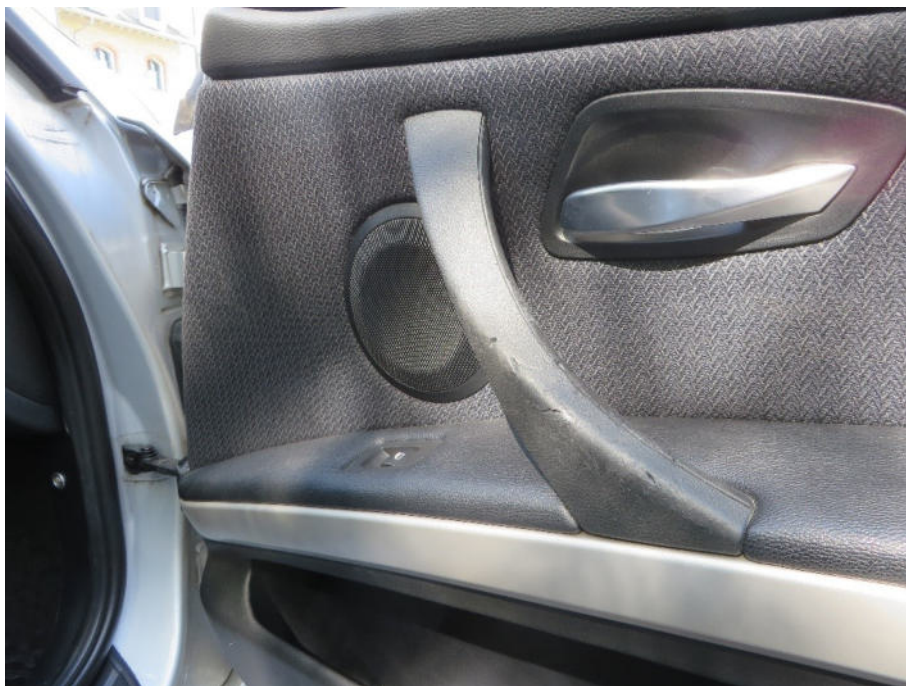
Tür vorne rechts, Beschädigungen an Türgriff und Türinnenverkleidung
