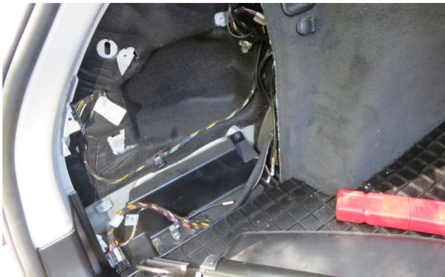
Laderaum hinten links, Bohrungen und Beschädigungen, bedingt durch ehemalige polizeispezifische Einbauten
