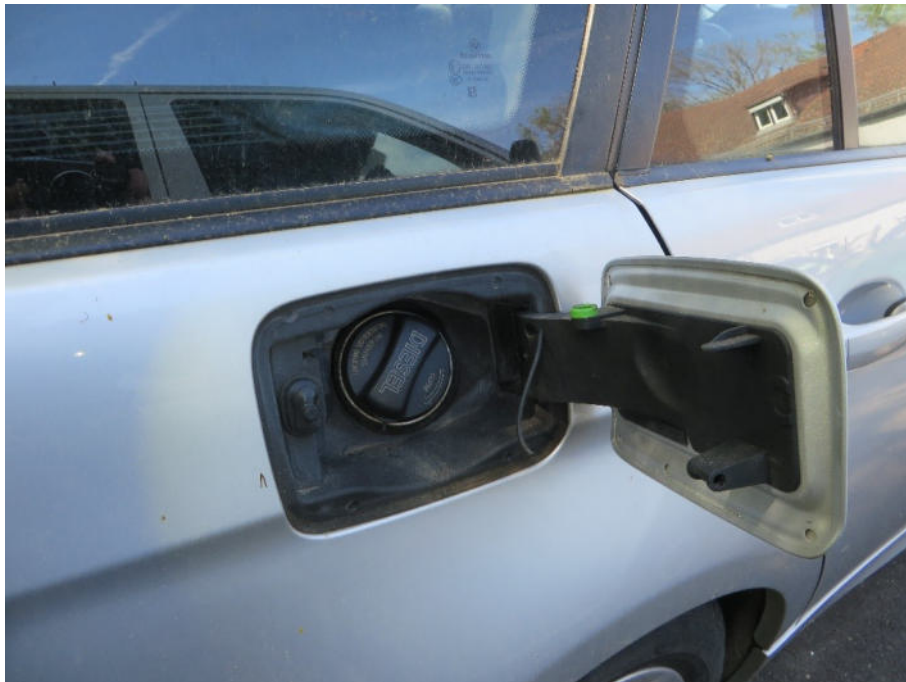
Ansicht seitlich hinten rechts, Tankdeckelverliersicherung defekt
