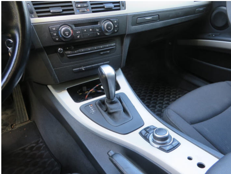
Mittelkonsole, Bohrungen und Beschädigungen durch Befestigungspunkte von ehemaligen polizeispezifischen Einbauten
