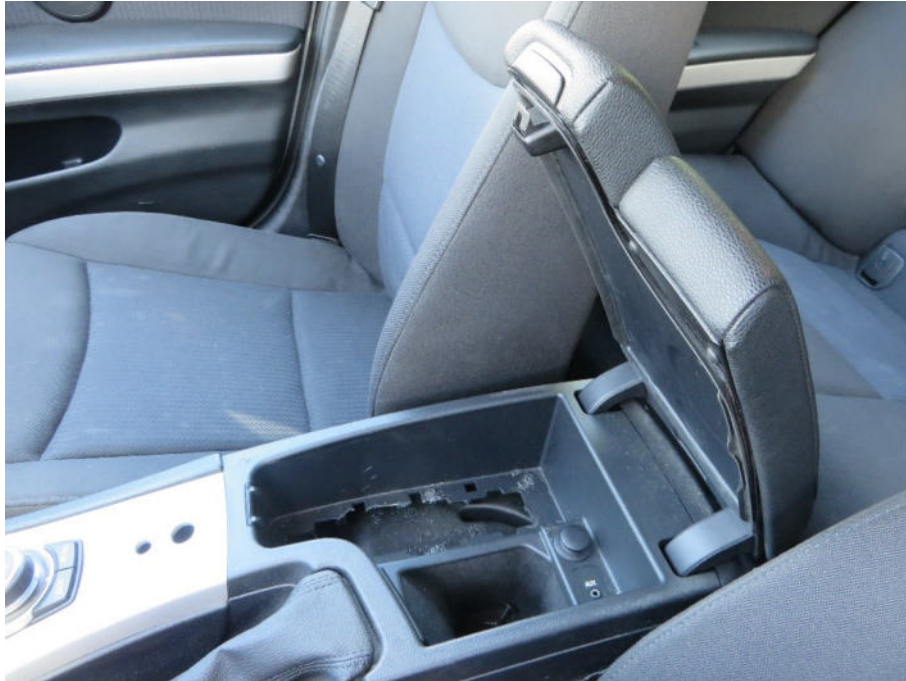
Mittelkonsole, Armauflage, defekte Abdeckungen, Bohrungen und Beschädigungen durch Befestigungspunkte von ehemaligen polizeispezifischen Einbauten
