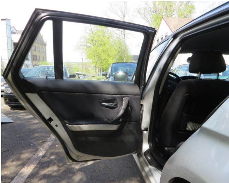
Tür hinten links, Beschädigungen an der Türinnenverkleidung
