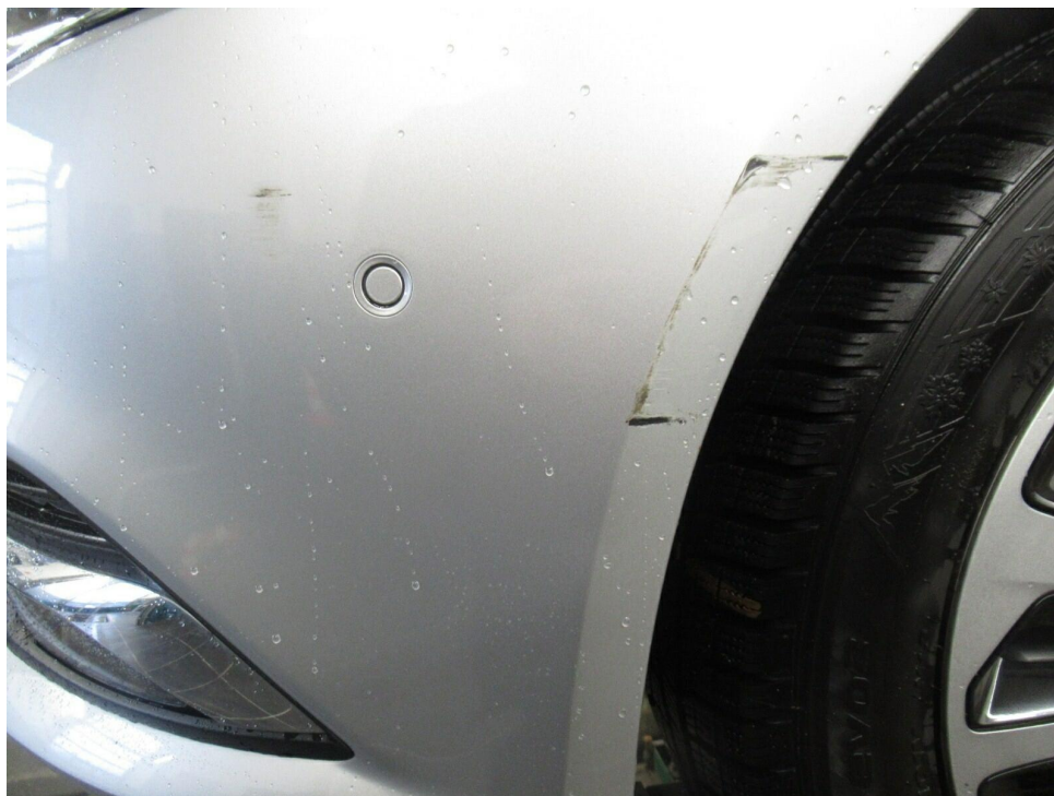
Bild 9 : Stoßfänger vorne Lackierung, verschrammt, lackieren mit Lackaufbau
