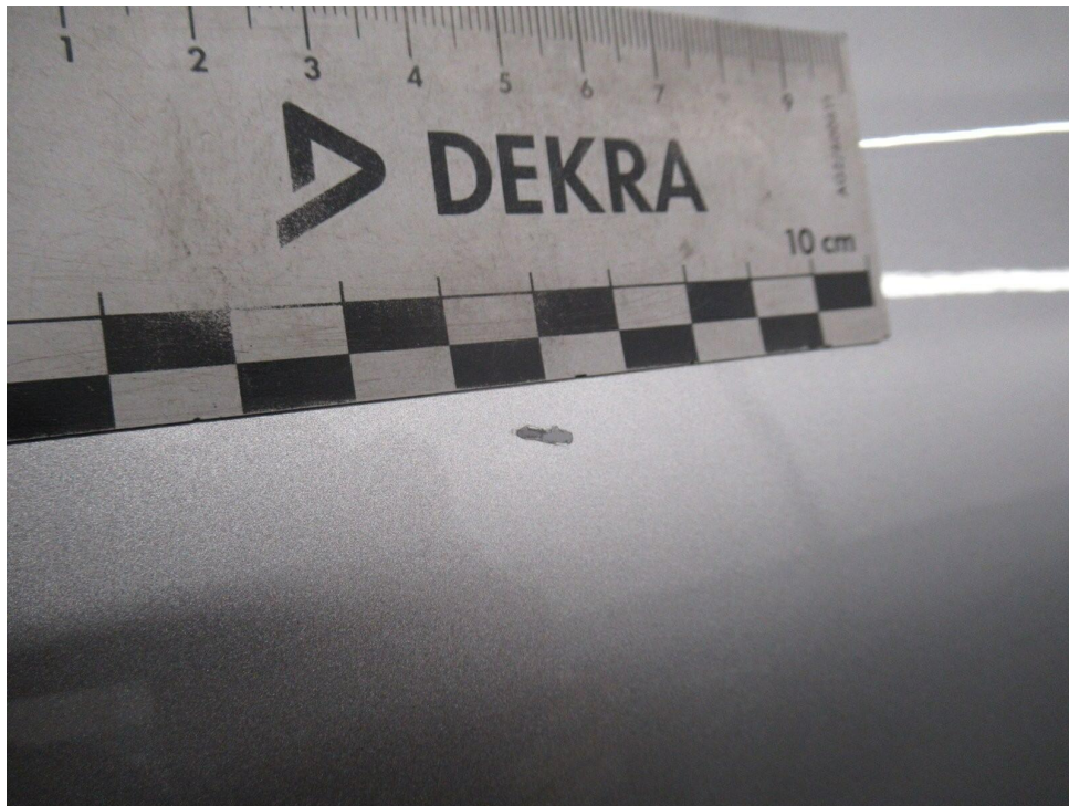
Bild 11 : Tür hinten links, deformiert, instandsetzen und lackieren mit Lackaufbau
