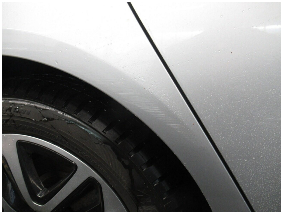
Bild 12 : Seitenteil hinten rechts Lackierung, verschrammt, lackieren
