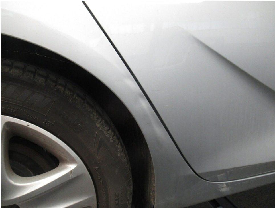
Bild 9 : Seitenteil hinten rechts, deformiert, instandsetzen und lackieren mit Lackaufbau Lackvorbereitung
