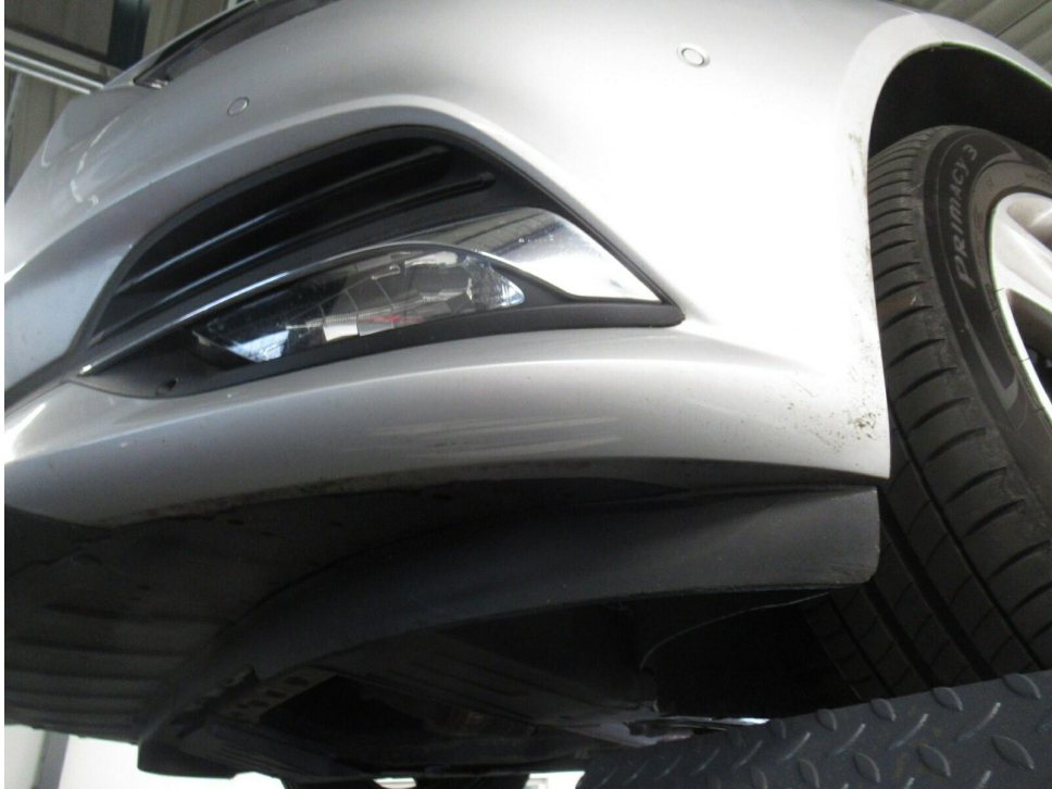
Bild 11 : Stoßfänger vorne Lackierung, verschrammt, lackieren mit Lackaufbau
