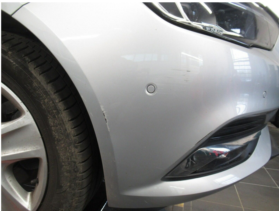
Bild 10 : Stoßfänger vorne Lackierung, verschrammt, lackieren mit Lackaufbau
