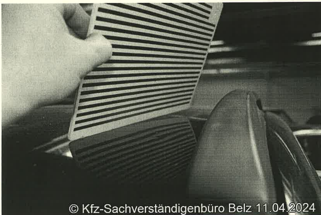
Foto 29: Delle im Dach
