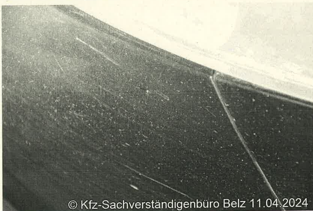
Foto 12: Kratzer Stoßfänger vorn
