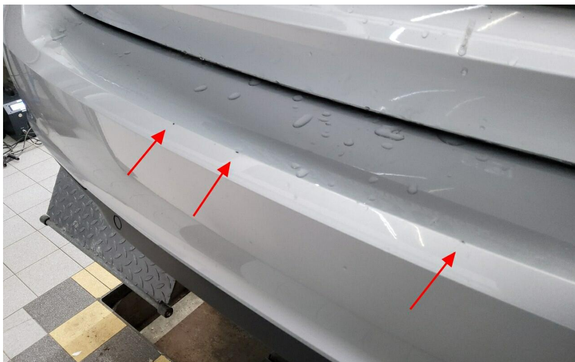
Bild 8 : Stoßfängerverkleidung hinten Lackbeschädigungen
