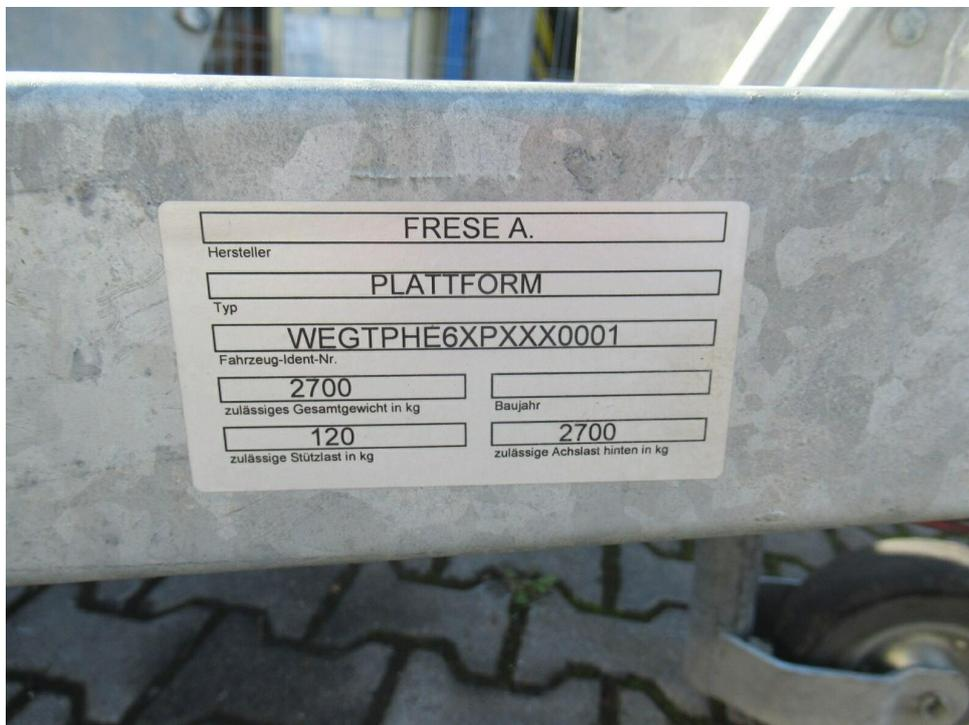
Bild 2 : Typenschild Anhänger
