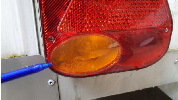
Beschädigung 1: Heckleuchte: Heckleuchte links - undicht - erneuern
