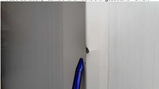
Beschädigung 3: Seitenwand rechts: Seitenwand - Delle / Lackschaden - Smart Repair
