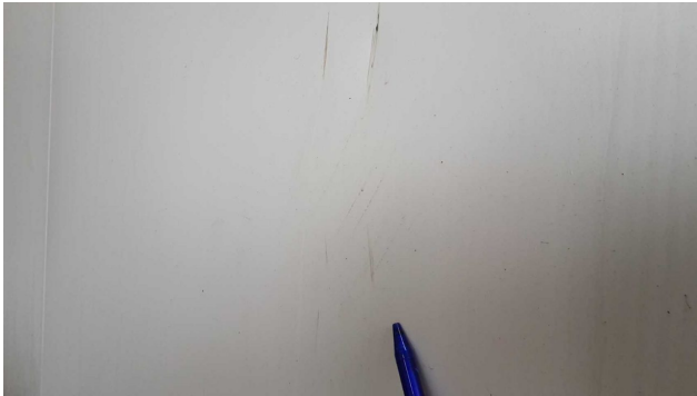
Beschädigung 5: Karosserie: Stirnwandverkleidung - Delle / Lackschaden - Smart Repair
