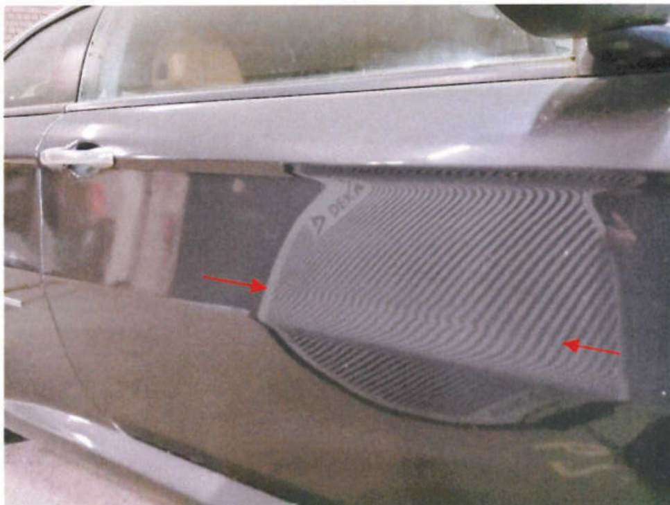
Bild 12 : Tür vorne rechts, verformt, instandsetzen und lackieren mit Lackaufbau
