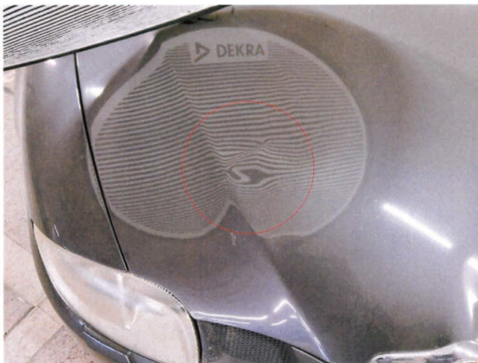
Bild 8 : Motorhaube, verformt, instandsetzen und lackieren mit Lackaufbau
