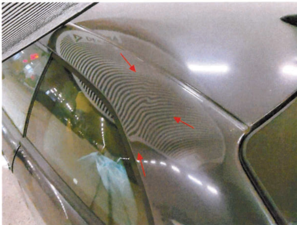
Bild 10 : Dachrahmen links, mehrfach eingedellt, instandsetzen und lackieren mit Lackaufbau
