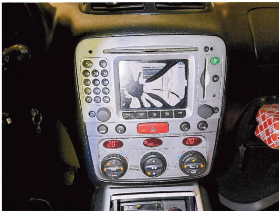
Bild 7 : Radio/Navi Display, beschädigt
