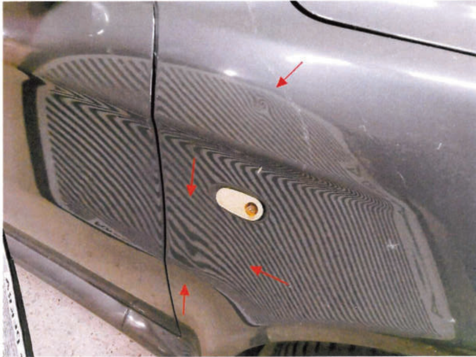
Bild 13 : Kotflügel vorne rechts, verformt, instandsetzen und lackieren mit Lackaufbau
