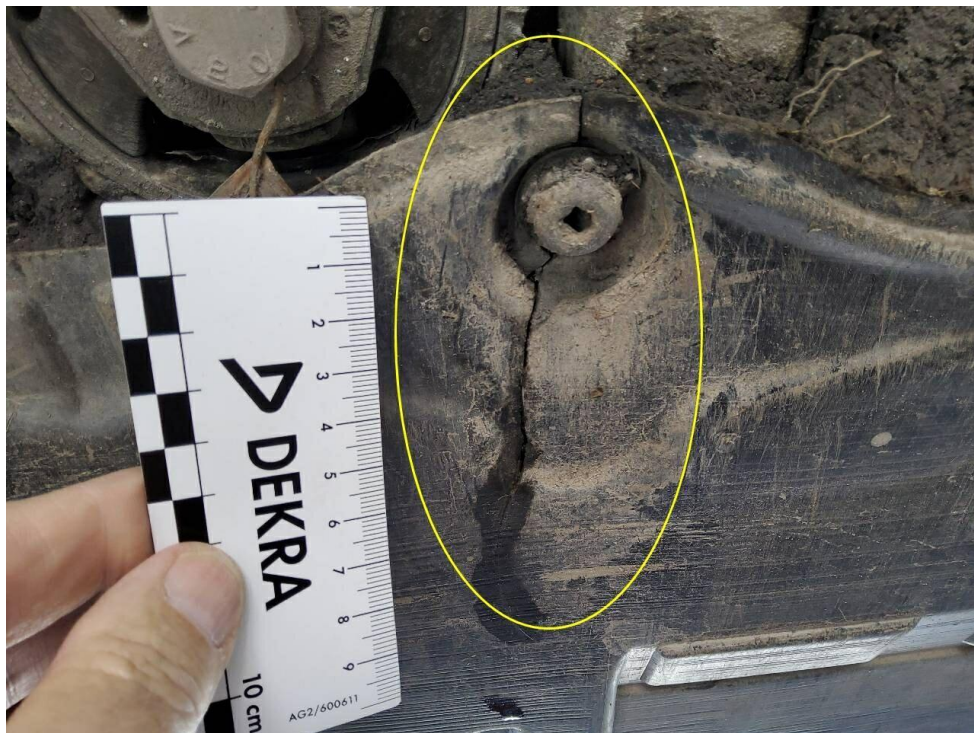
Bild 12 : Motorabdeckung unten gebrochen
