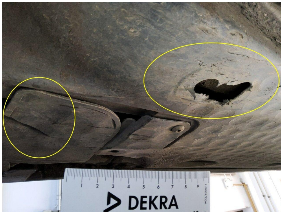
Bild 13 : Unterbodenverkleidung Mitte rechts und links gebrochen
