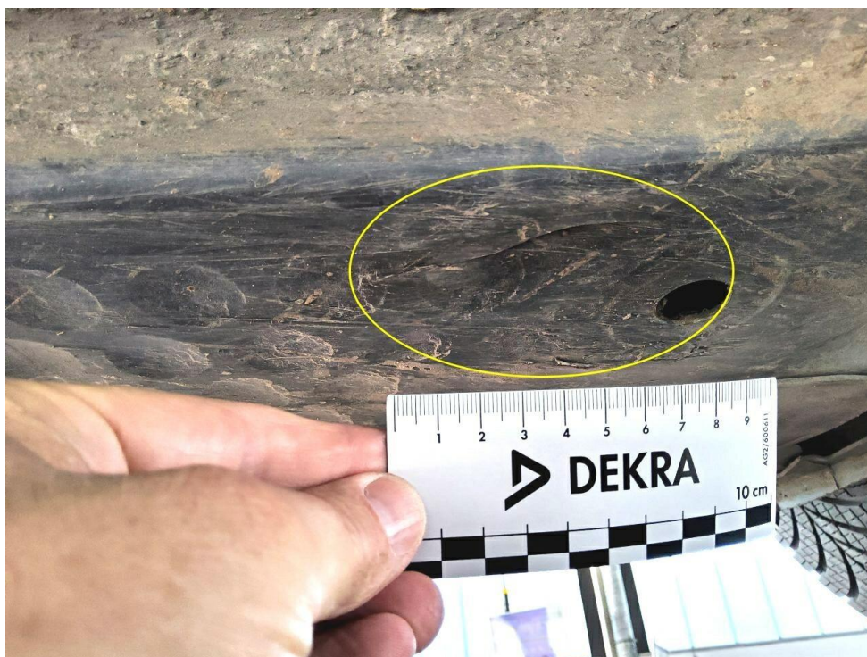
Bild 14 : Unterbodenverkleidung Mitte rechts und links gebrochen
