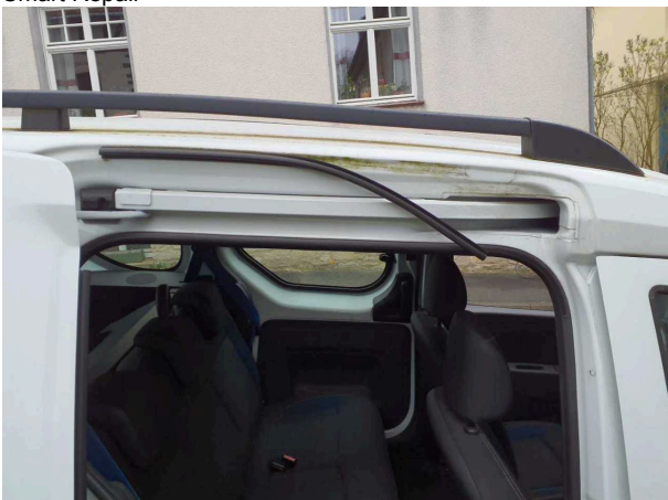
Beschädigung 6: Schiebetür rechts: Türdichtung - gebrochen / gerissen - erneuern
