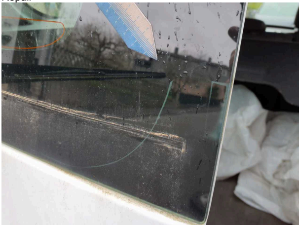
Beschädigung 11: Verglasung: Heckscheibe - undicht - Wertminderung
