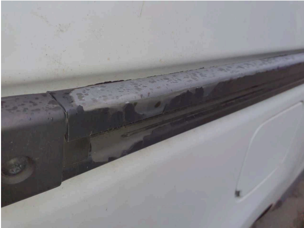
Beschädigung 3: Schiebetür rechts: Führungsschiene - verschlissen - Wertminderung
