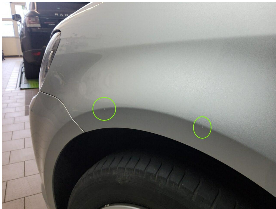
Bild 8 : Kotflügel vorne links Lackabplatzungen
