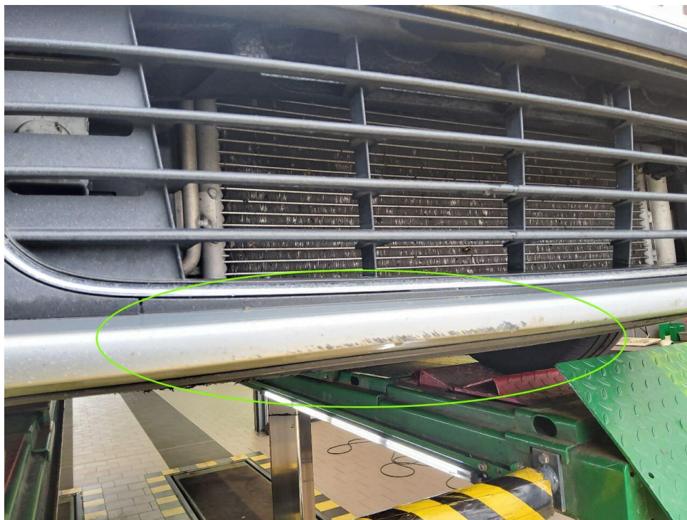
Bild 10 : Stoßfänger vorne deformiert und verschrammt
