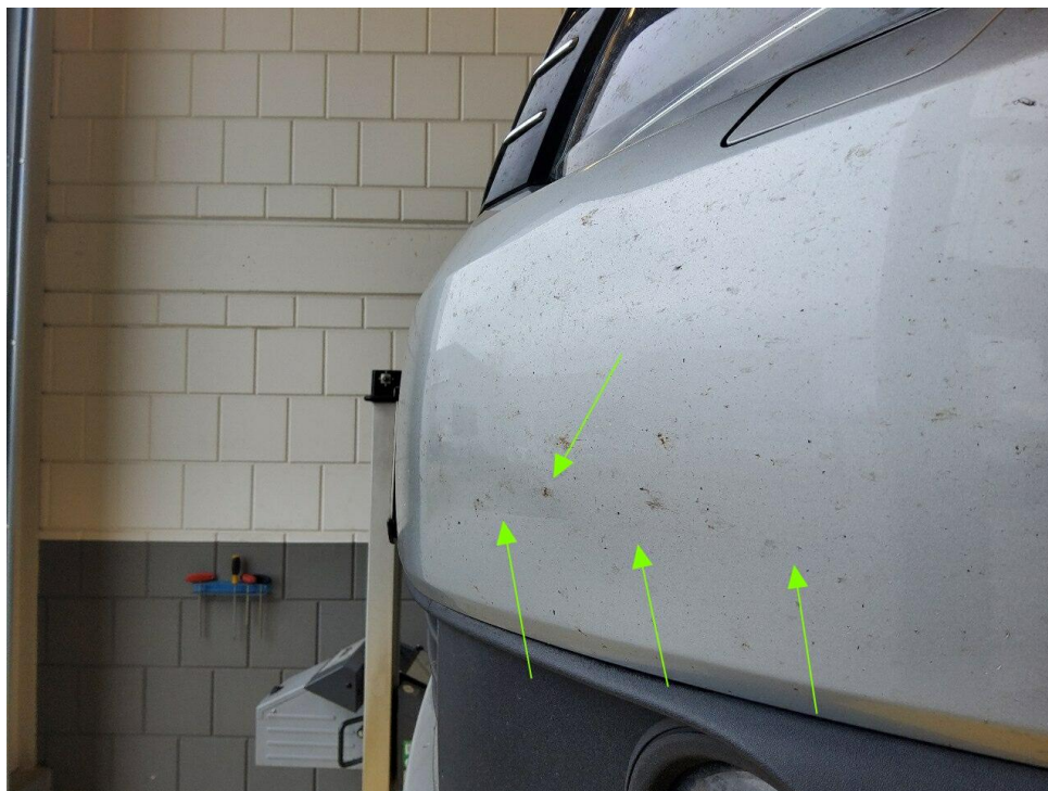
Bild 9 : Stoßfänger vorne deformiert
