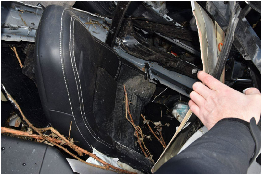
Bild 14 : Zustand Innenraum (Sitze verschimmelt)
