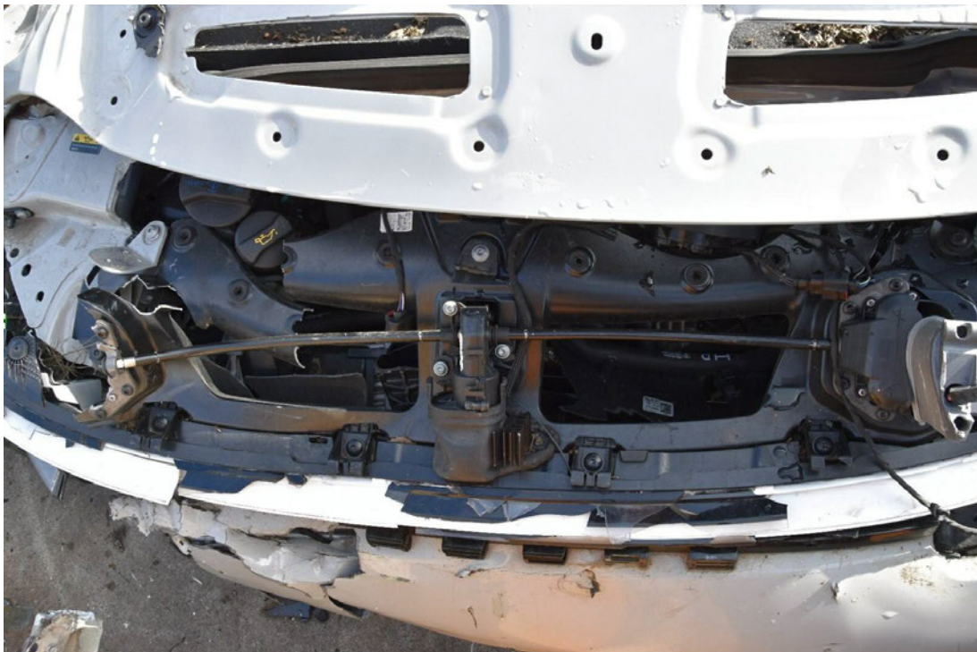
Bild 8 : Schäden Heckbereich; Zustand Motor
