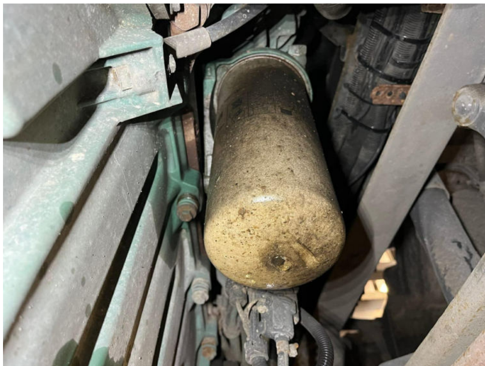
Bild 21 : Kraftstoffverlust am Filter
