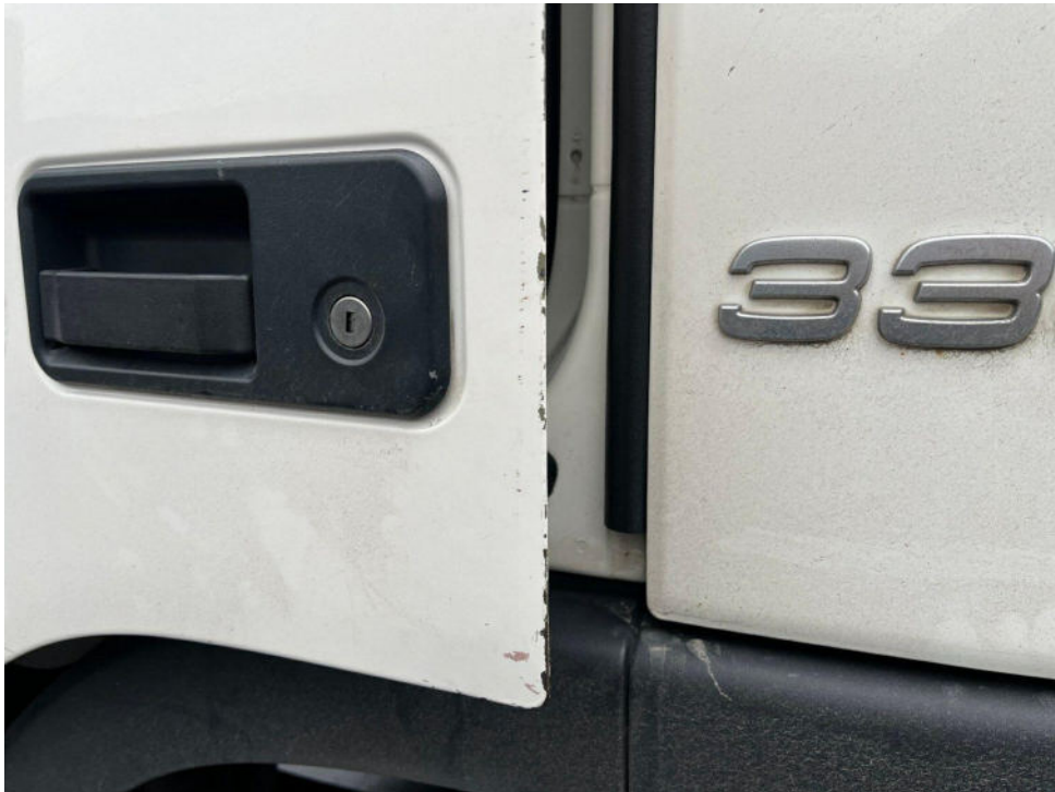
Bild 19 : Fahrertür und Beifahrertür verschrammt
