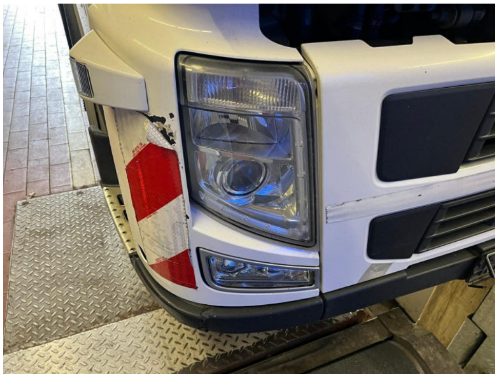
Bild 13 : Stoßfängerecke vorne rechts verschrammt und gebrochen
