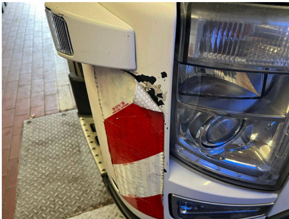
Bild 14 : Stoßfänger vorne rechts Lackablösung
