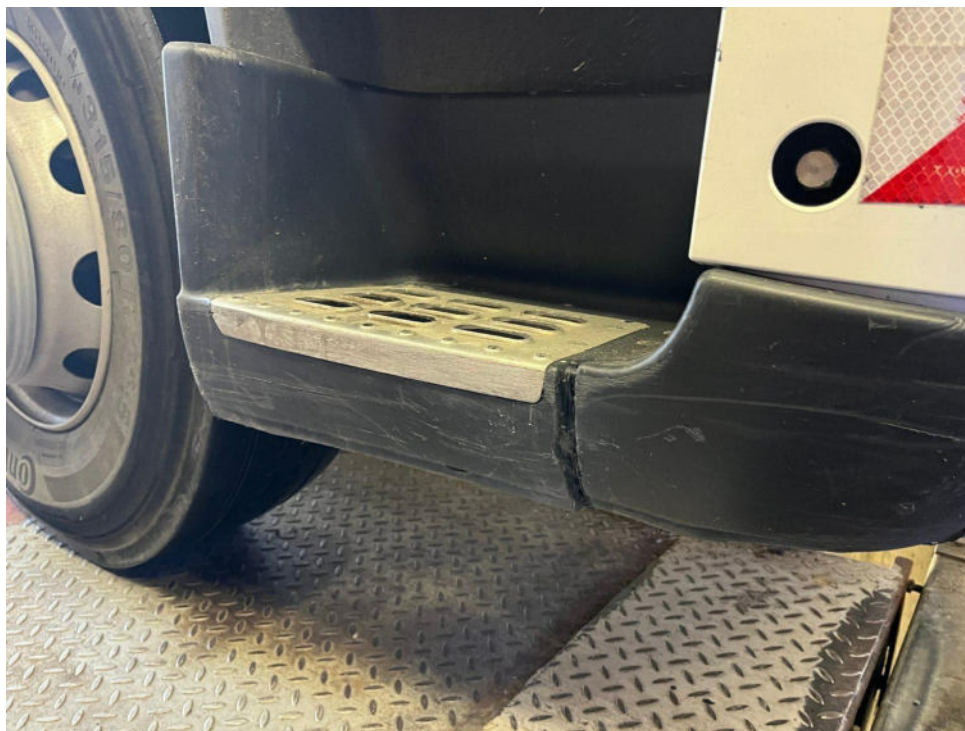
Bild 12 : Stoßfängerecke vorne rechts verschrammt und gebrochen
