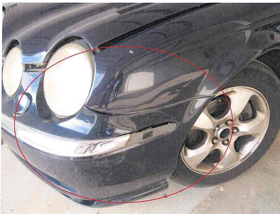
Bild 5 : Anfahrtschaden vorn links (Kotflügel/Stoßfänger deformiert)
