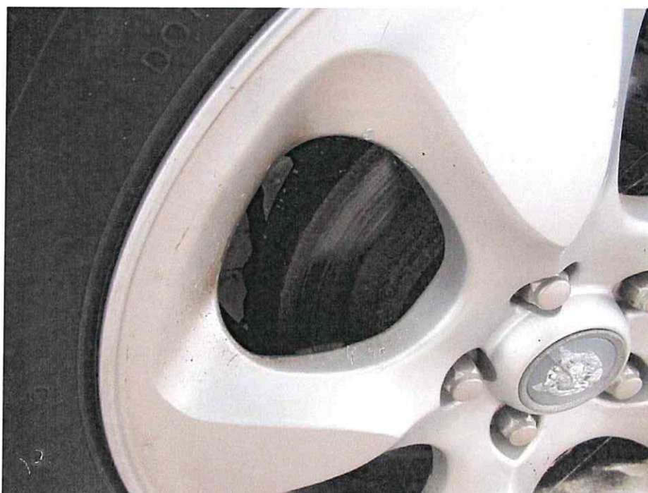
Bild 8 : Bremsscheiben hinten schlechtes Tragbild
