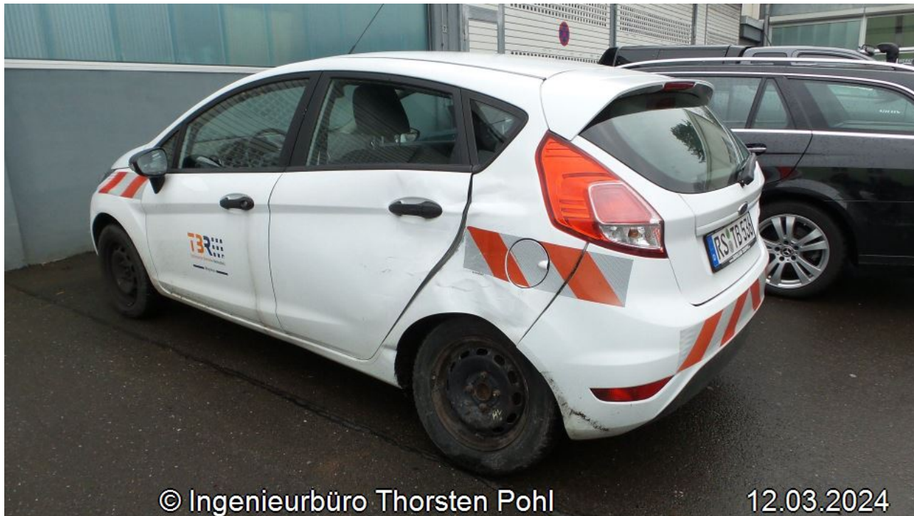
Foto 3: Beschädigung linke Fahrzeugseite
