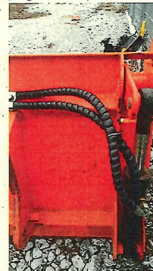
Bild Nr. 20 Klappschaufel, angerosteter Zylinder
