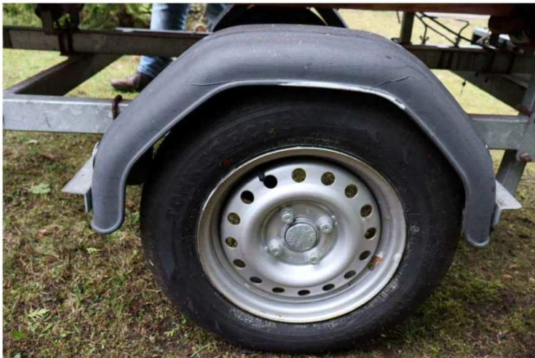
Bild 8 : Radabdeckung li. (Kotflügel) eingekerb/verkratzt
