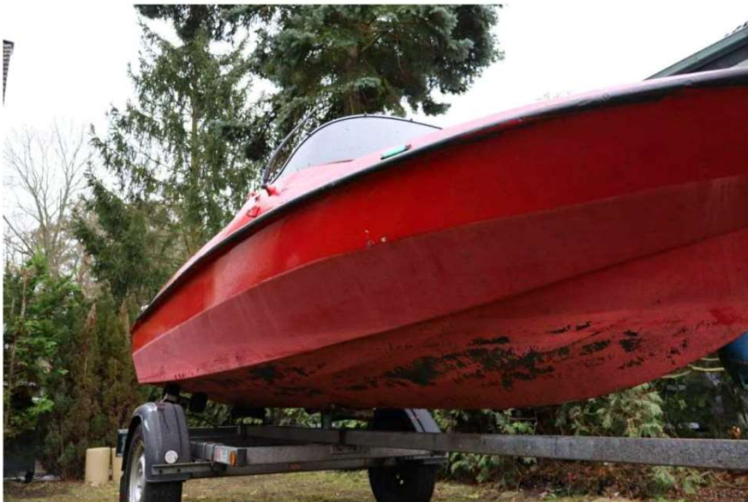
Bild 10 : Lackablösung im Unterwasserschiffbereich
