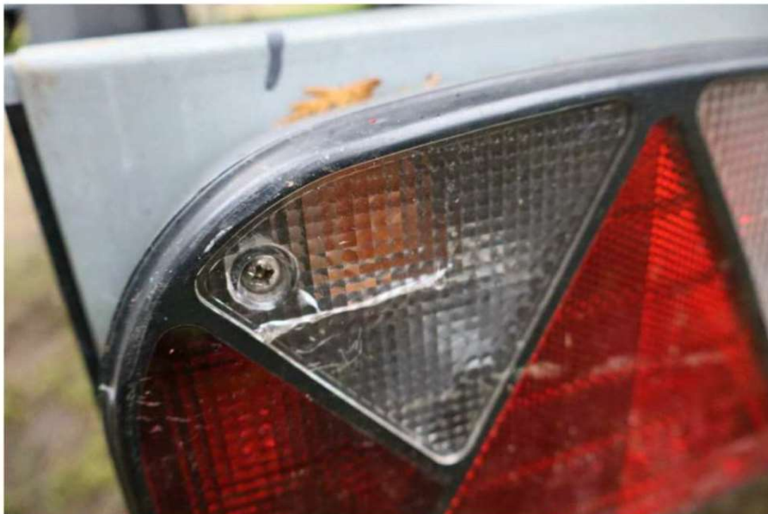
Bild 7 : Glas Rücklicht li.gebrochen
