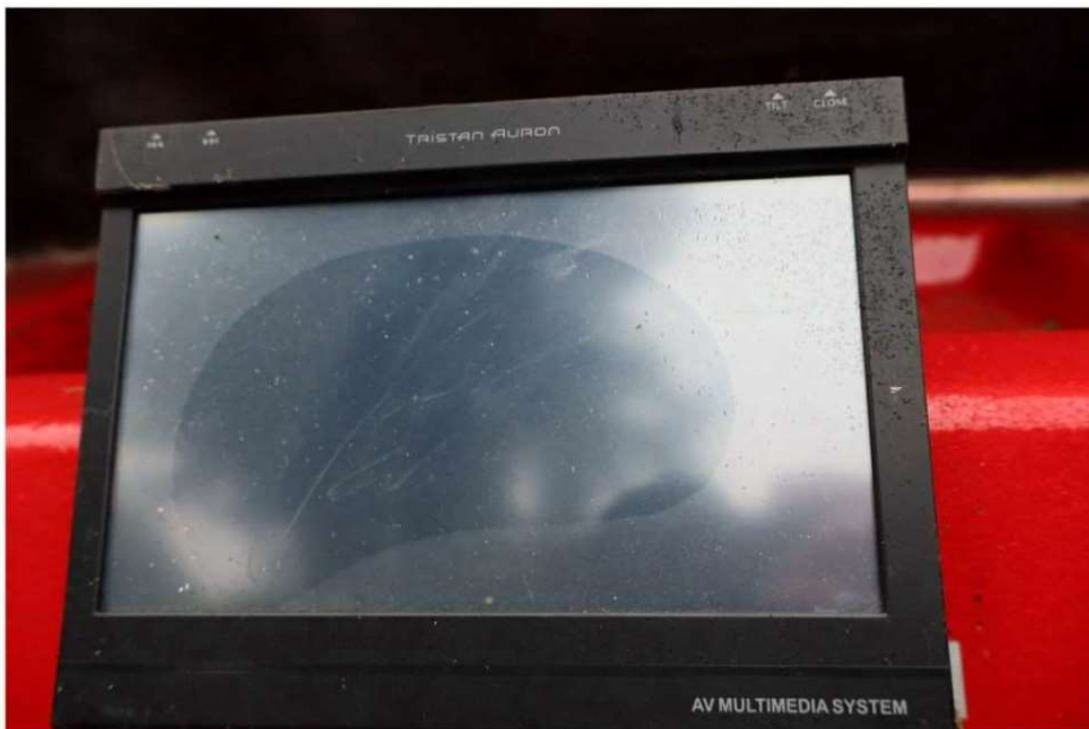
Bild 15 : Display Multimediasystem gebrochen
