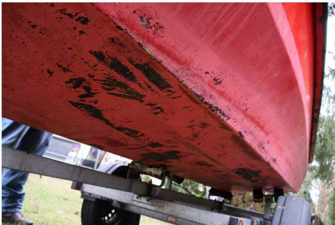
Bild 11 : Lackablösung im Unterwasserschiffbereich
