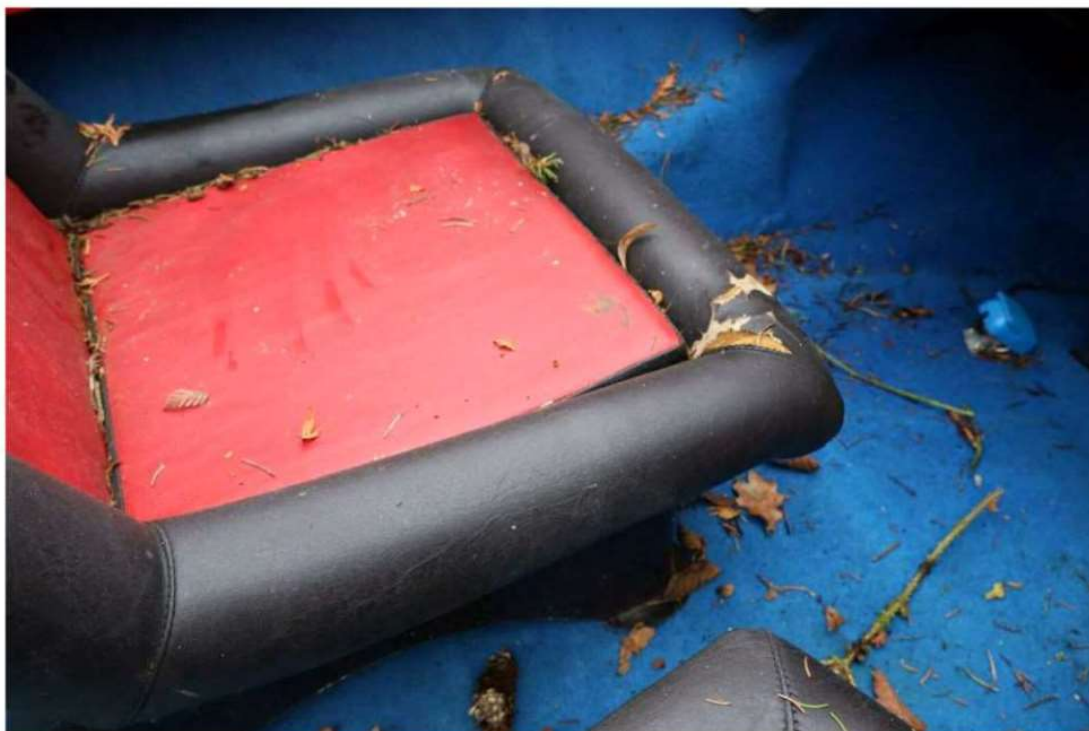
Bild 13 : Sitzpolster teilweise eingerissen
