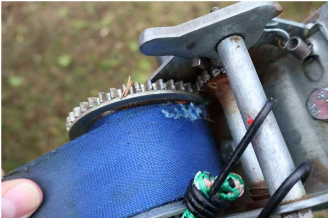
Bild 6 : Gurtband für Trailerwinde eingeschnitten
