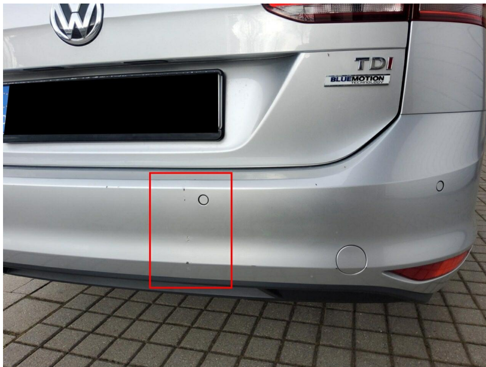
Bild 9 : Stoßfänger hinten Lackierung, verschrammt, lackieren mit Lackaufbau
