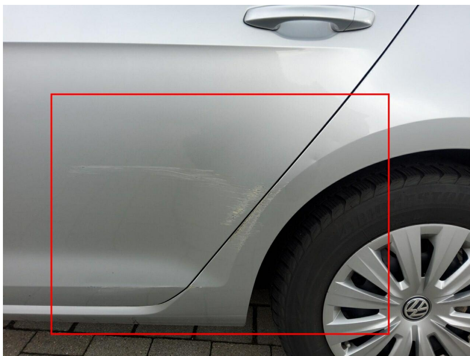
Bild 8 : Tür hinten links, deformiert, instandsetzen und lackieren mit Lackaufbau Seitenteil hinten links, deformiert, instandsetzen und lackieren mit Lackaufbau
