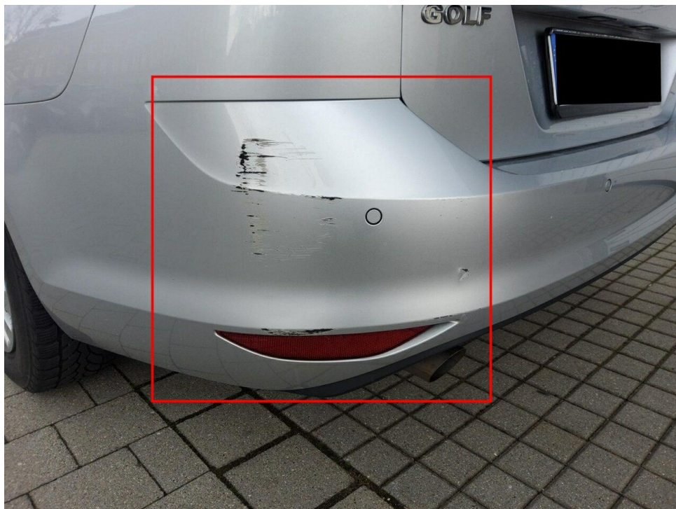
Bild 10 : Stoßfänger hinten Lackierung, verschrammt, lackieren mit Lackaufbau
