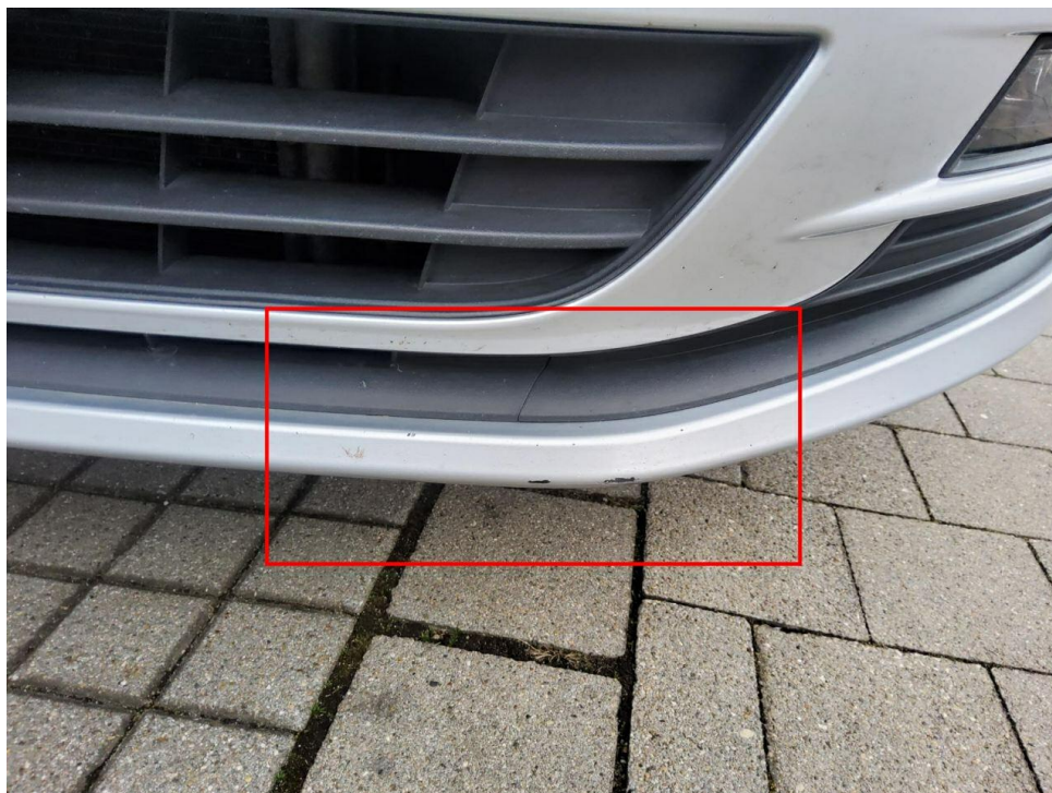
Bild 6 : Stoßfänger vorne Lackierung, zerkratzt, lackieren mit Lackaufbau
