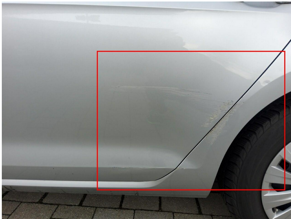
Bild 7 : Tür hinten links, deformiert, instandsetzen und lackieren mit Lackaufbau Seitenteil hinten links, deformiert, instandsetzen und lackieren mit Lackaufbau
