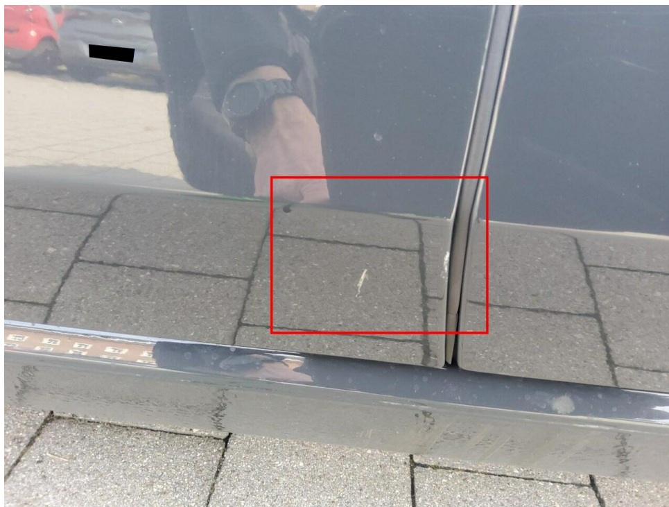
Bild 6 : Tür vorne links Lackierung, zerkratzt, smart repair
