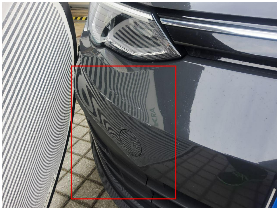
Bild 10 : Bestehender Anfahrtschaden vorn rechts
