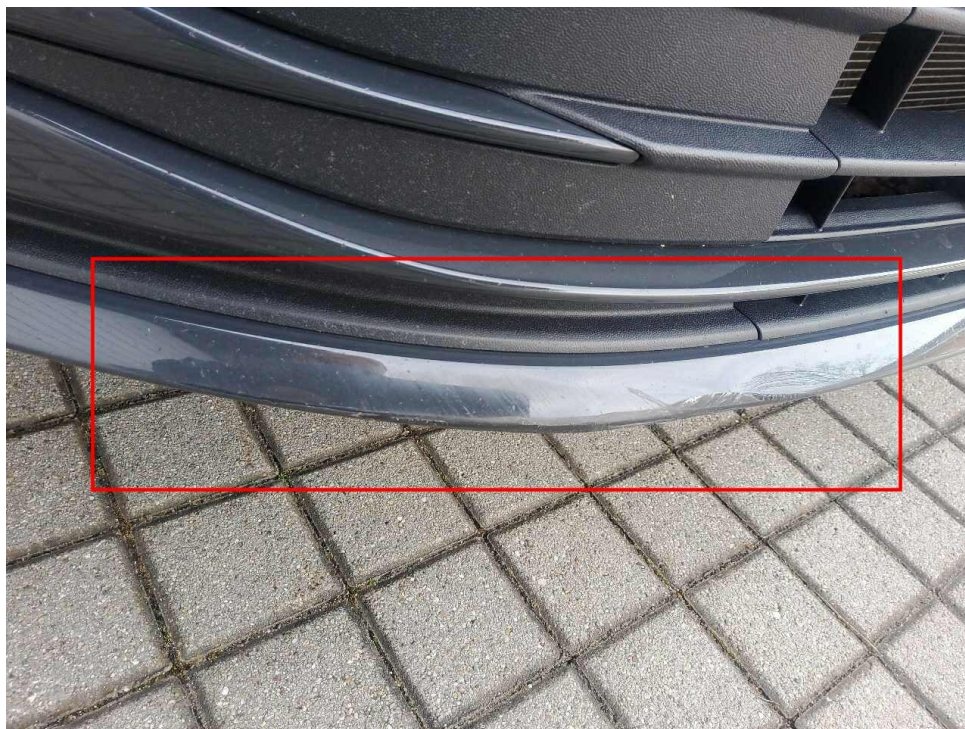
Bild 9 : Bestehender Anfahrtschaden vorn rechts
