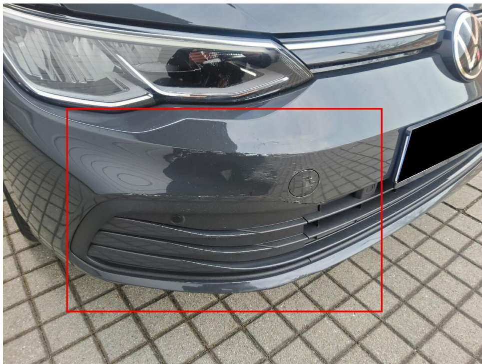
Bild 7 : Bestehender Anfahrtschaden vorn rechts
