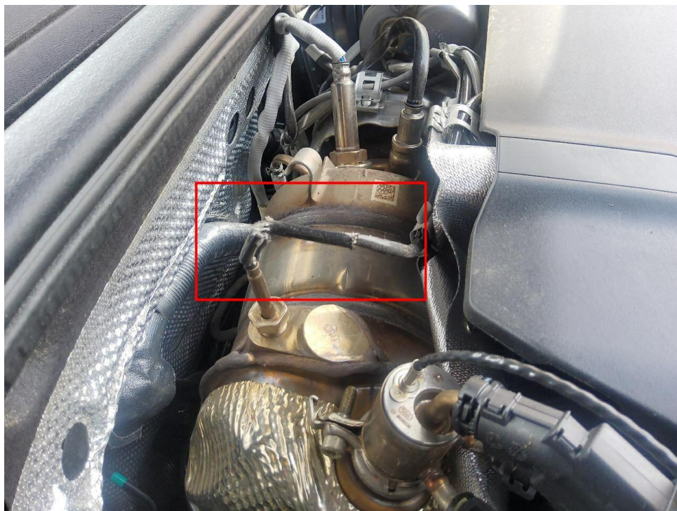
Bild 11 : Temperaturfühler Turbolader Marderschaden
