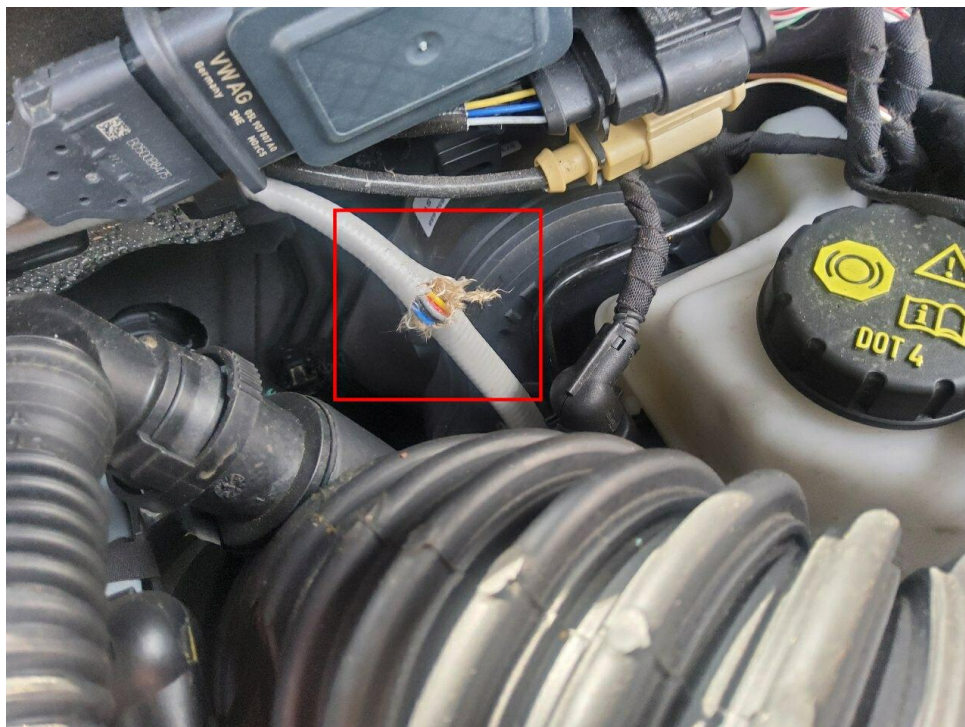
Bild 12 : Temperaturfühler hinten Marderschaden
