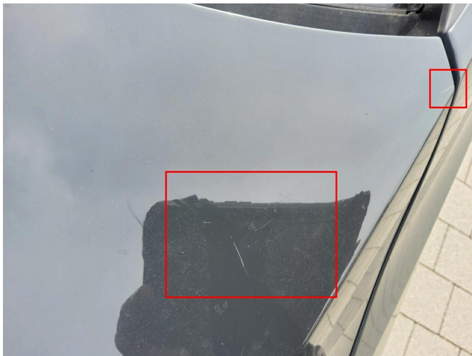
Bild 7 : Motorhaube Lackierung, zerkratzt, lackieren
