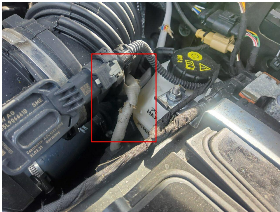
Bild 13 : Temperaturfühler hinten Marderschaden
