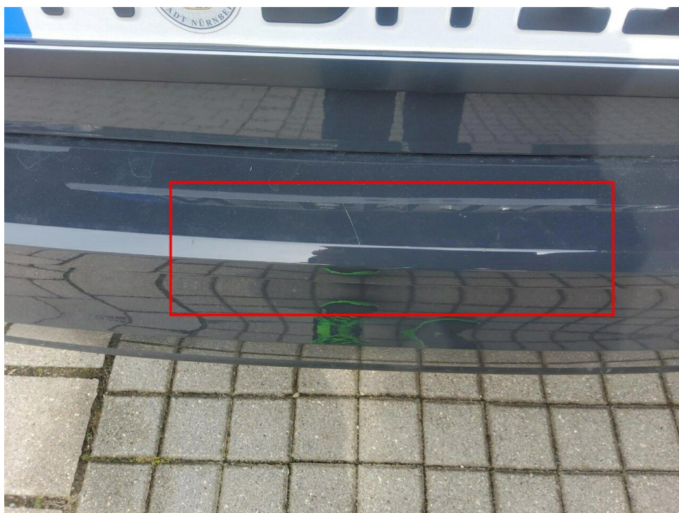
Bild 6 : Stoßfänger hinten Lackierung, zerkratzt, Gebrauchsspur
