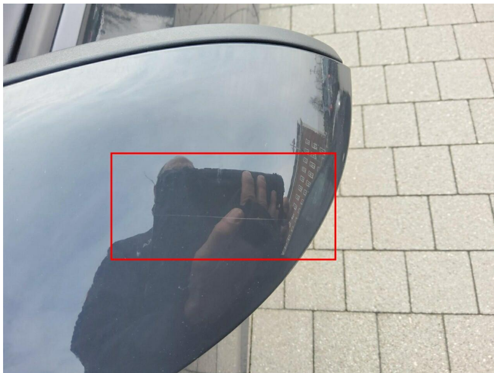
Bild 7 : Außenspiegel links Lackierung, zerkratzt, lackieren
