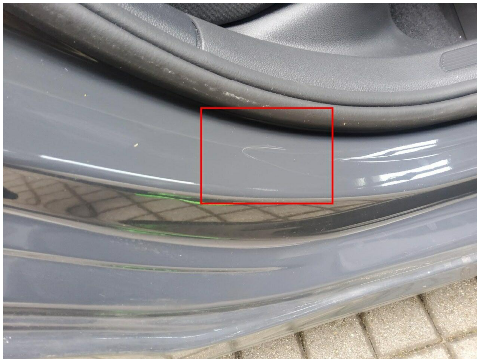
Bild 6 : Tür hinten rechts Einstieg Lackierung, zerkratzt, smart repair
