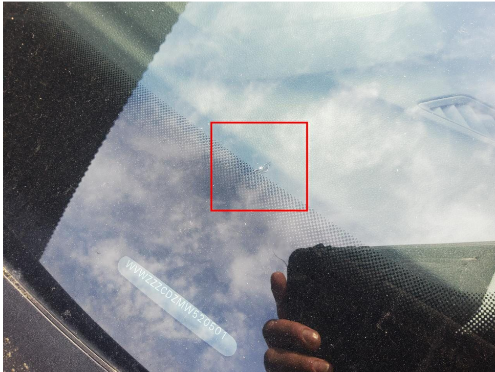
Bild 11 : Frontscheibe Steinschlag mit Rissbildung
