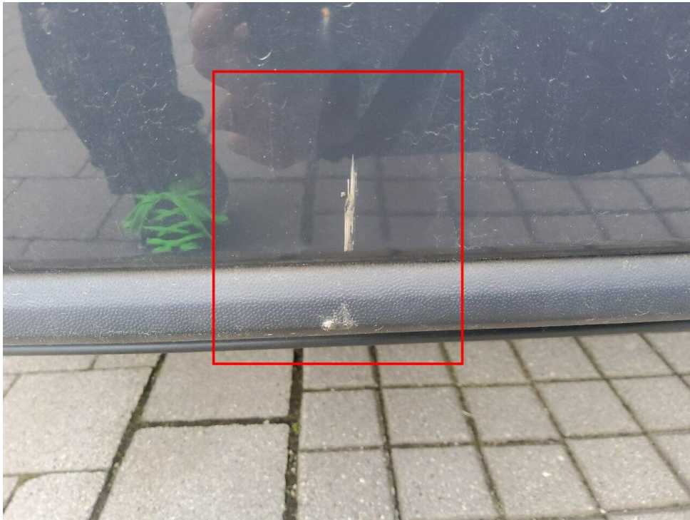
Bild 7 : Spoileransatz hinten verschrammt
