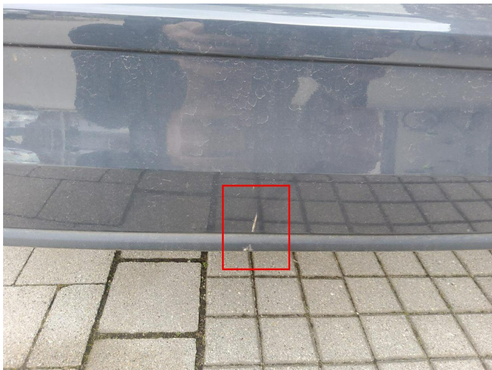
Bild 6 : Stoßfänger hinten Lackierung, zerkratzt, lackieren mit Lackaufbau
