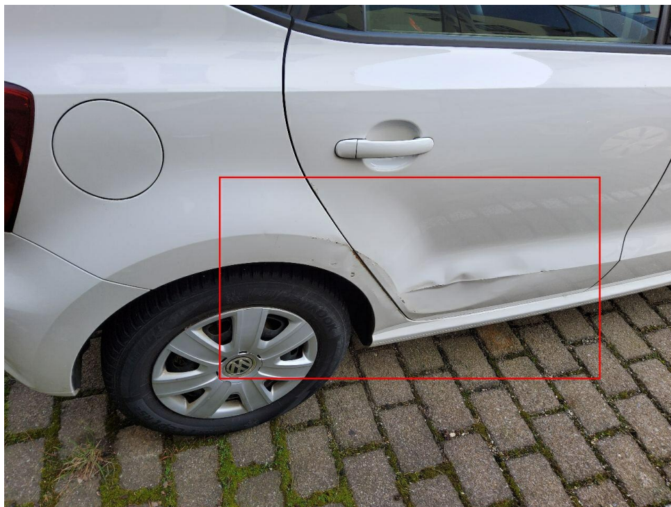
Bild 5 : Anfahrschaden rechts hinten
