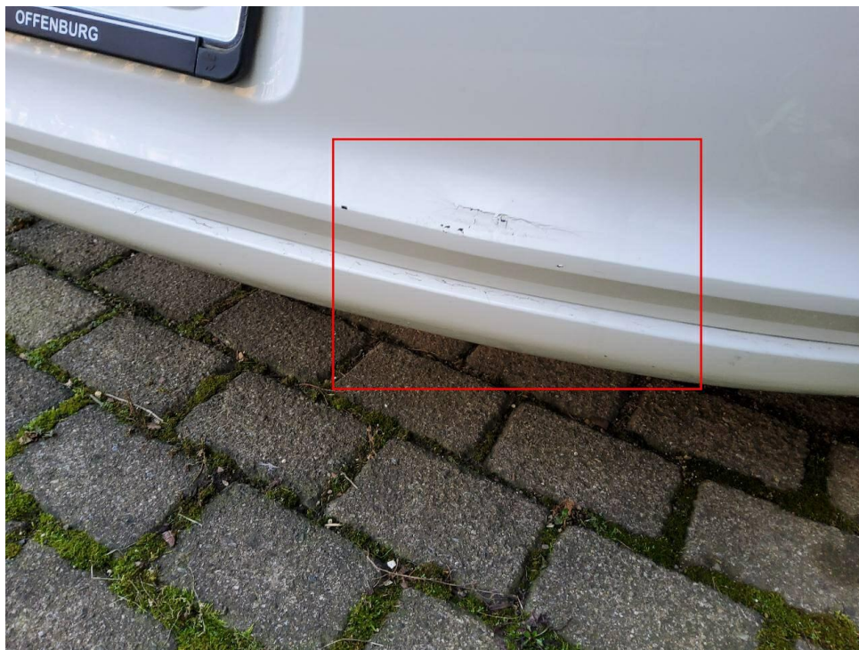
Bild 8 : Anfahrtschaden Stoßfänger hinten
