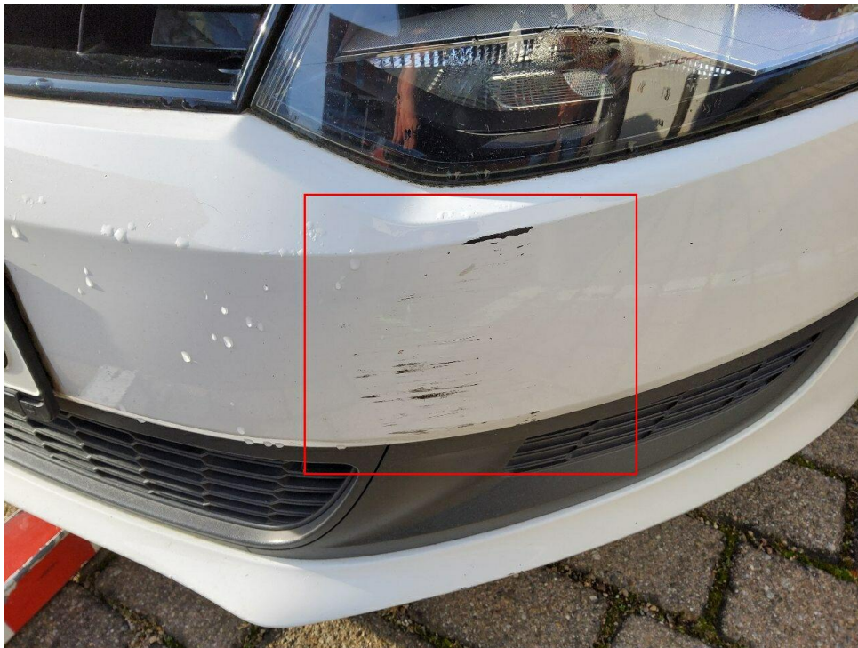
Bild 10 : Stoßfänger vorne verschrammt mit Material abtrag
