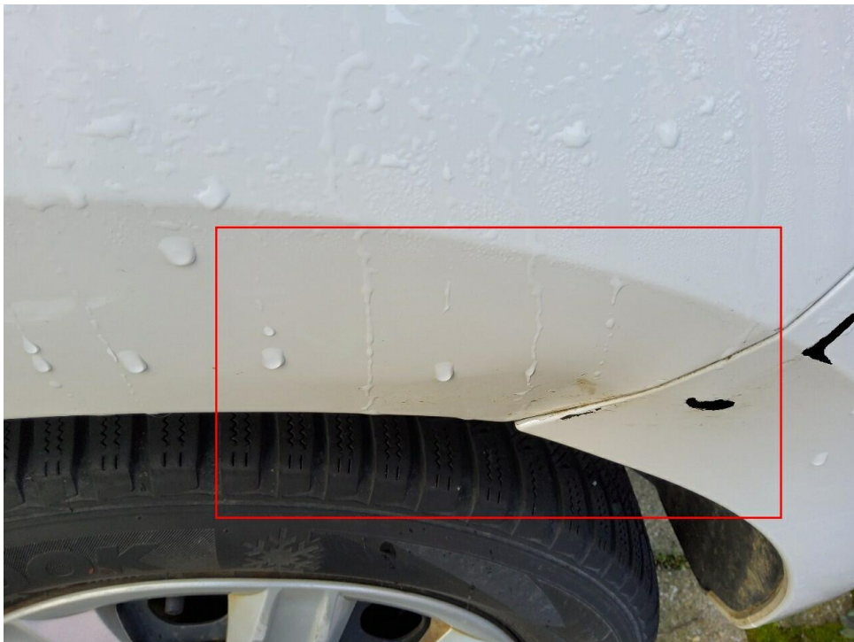
Bild 14 : Seitenwand links deformiert
