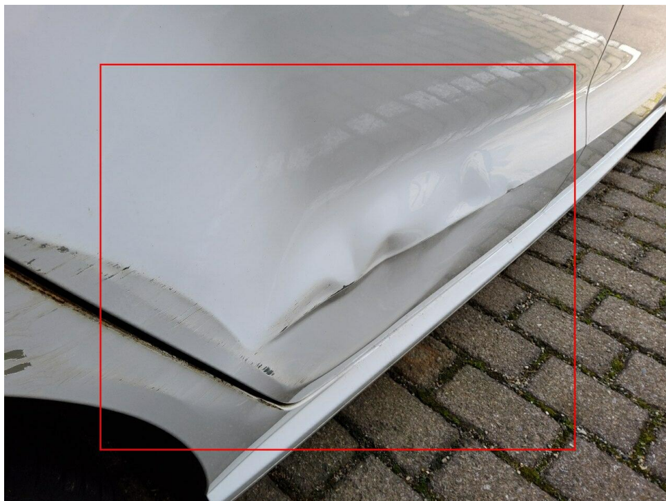
Bild 6 : Anfahrschaden rechts hinten
