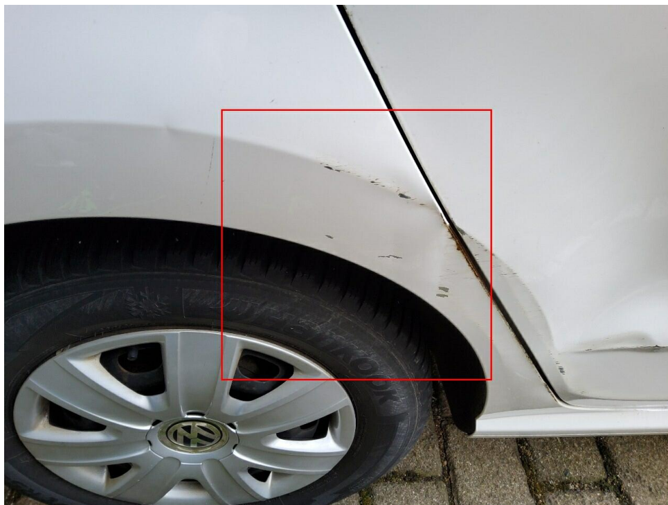
Bild 7 : Anfahrtschaden rechts hinten
