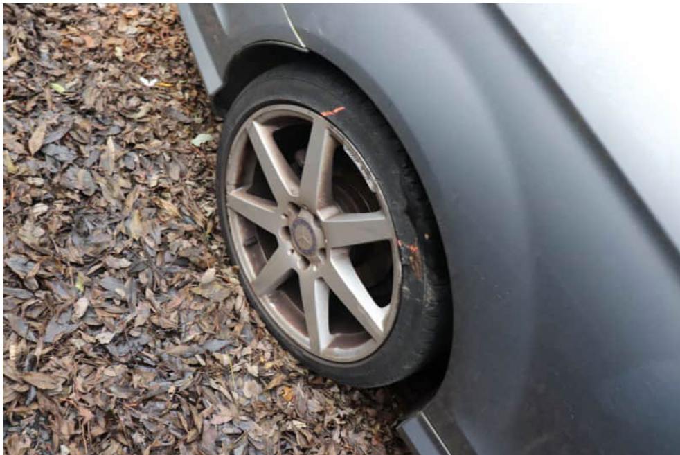
Bild 20 Rad hinten rechts Bordsteinschaden
