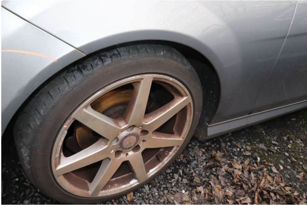
Bild 28 Rad vorne links Bordsteinschaden
