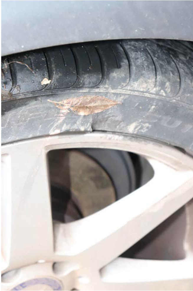
Bild 21 Rad hinten rechts Bordsteinschaden
