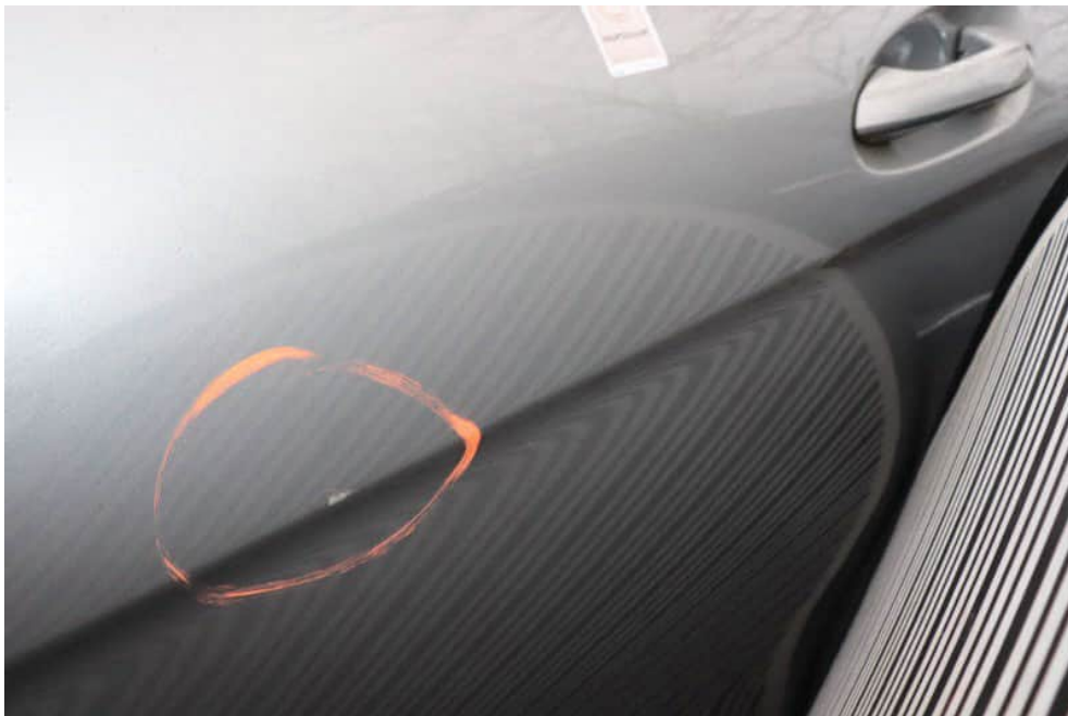
Bild 27 Anstoß und Verformung der Tür links
