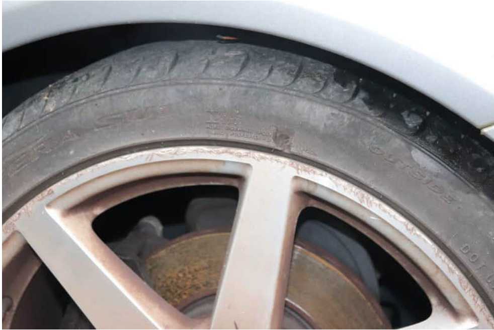
Bild 19 Rad vorne rechts Bordsteinschaden
