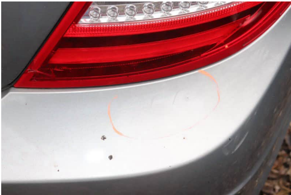
Bild 14 Anstoß und Verformung der Geckverkleidung
