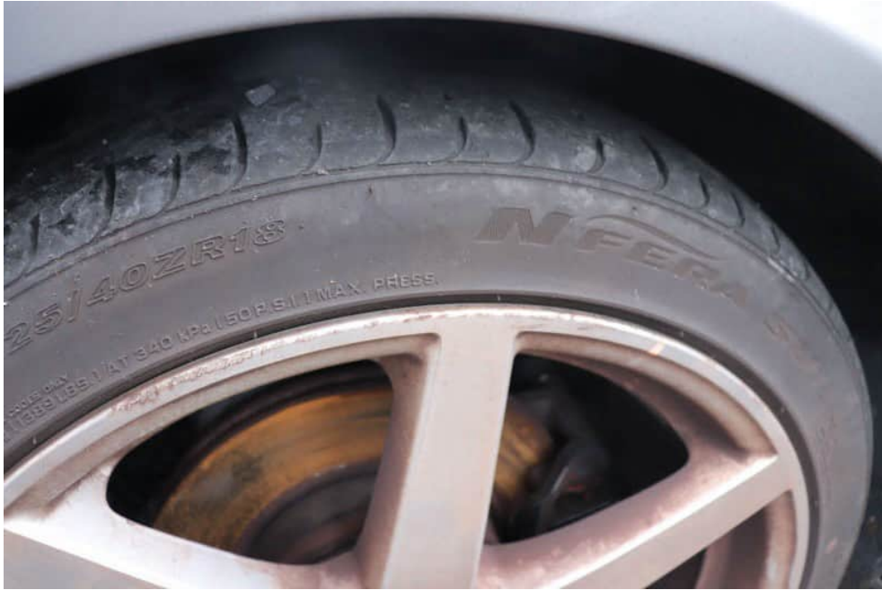
Bild 30 Rad vorne links Bordsteinschaden
