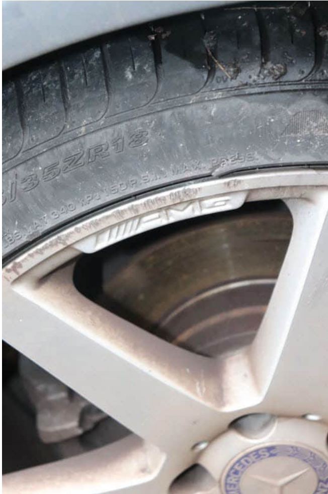
Bild 22 Rad hinten rechts Bordsteinschaden
