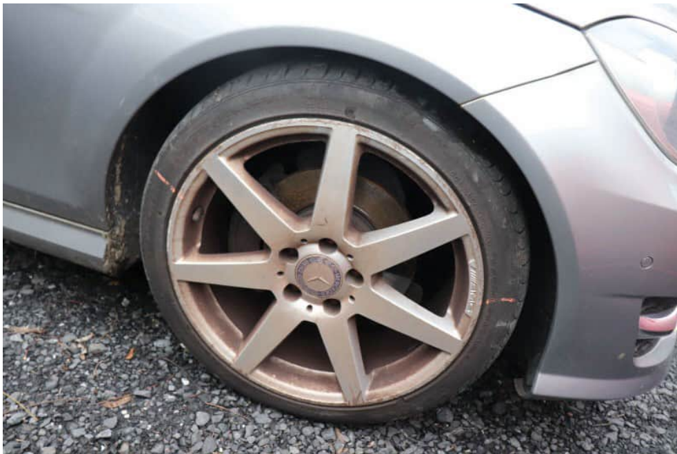
Bild 18 Rad vorne rechts Bordsteinschaden
