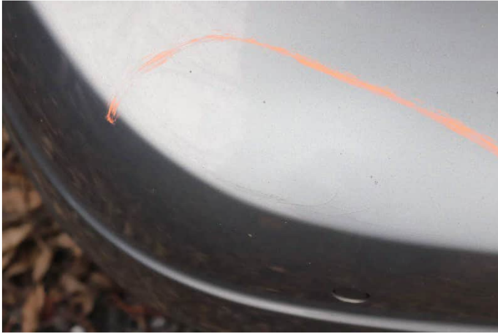
Bild 13 Anstoß und Verformung der Geckverkleidung
