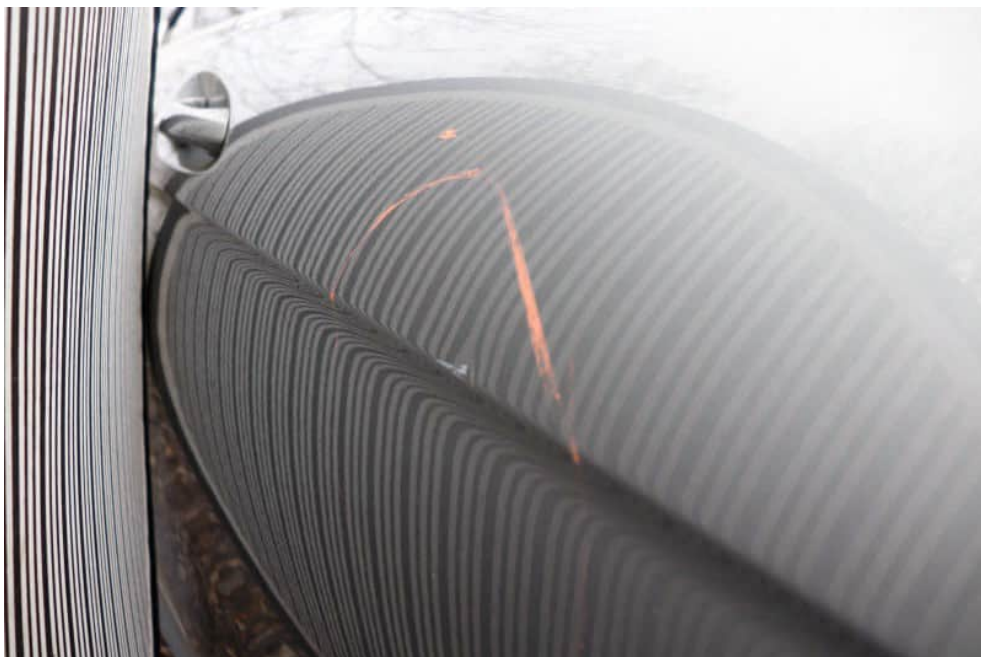
Bild 23 Verformung der Tür rechts
