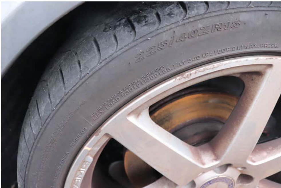
Bild 29 Rad vorne links Bordsteinschaden
