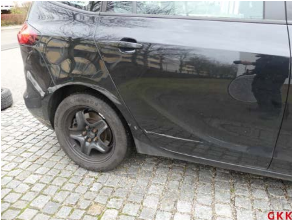
Bild 27 Tür hinten rechts, beschädigt, instand setzen - lackieren
