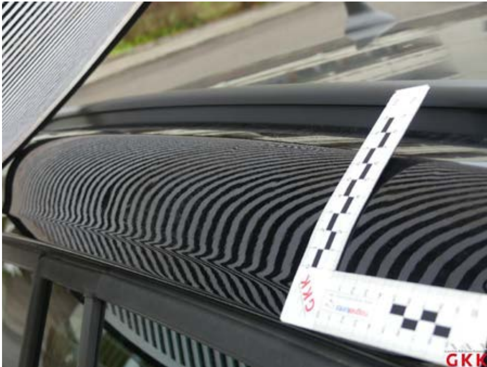
Bild 31 Dach, Holm rechts, beschädigt, kalt drücken
