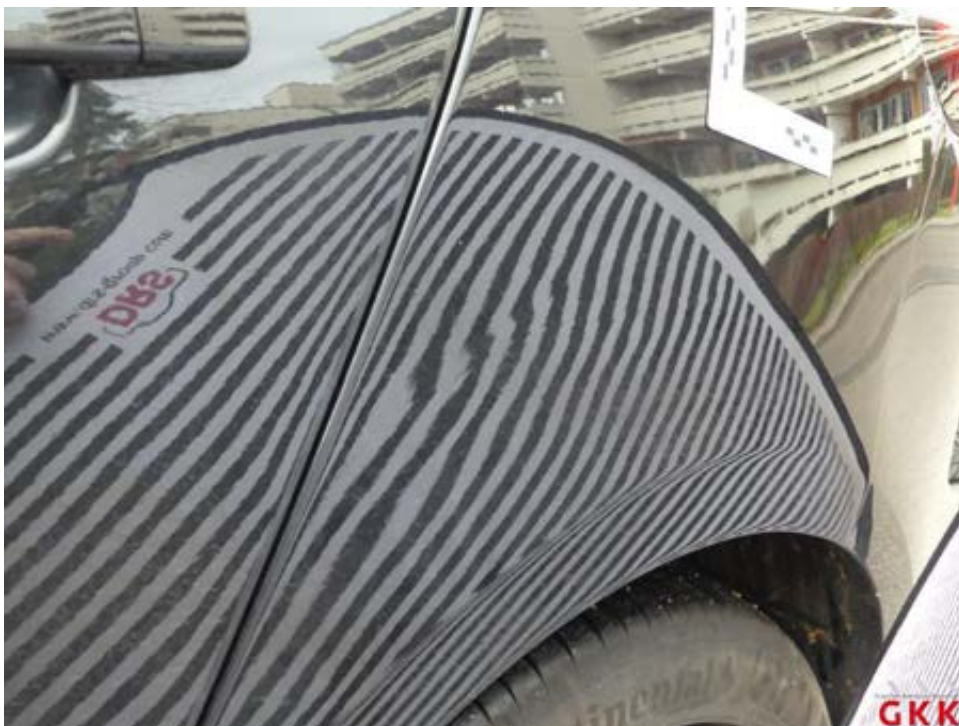
Bild 26 Seitenwand links, Reparaturmangel, lackieren
