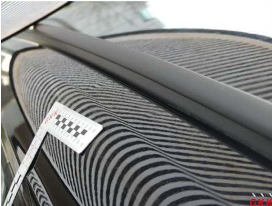
Bild 34 Dach, Holm links, beschädigt, kalt drücken
