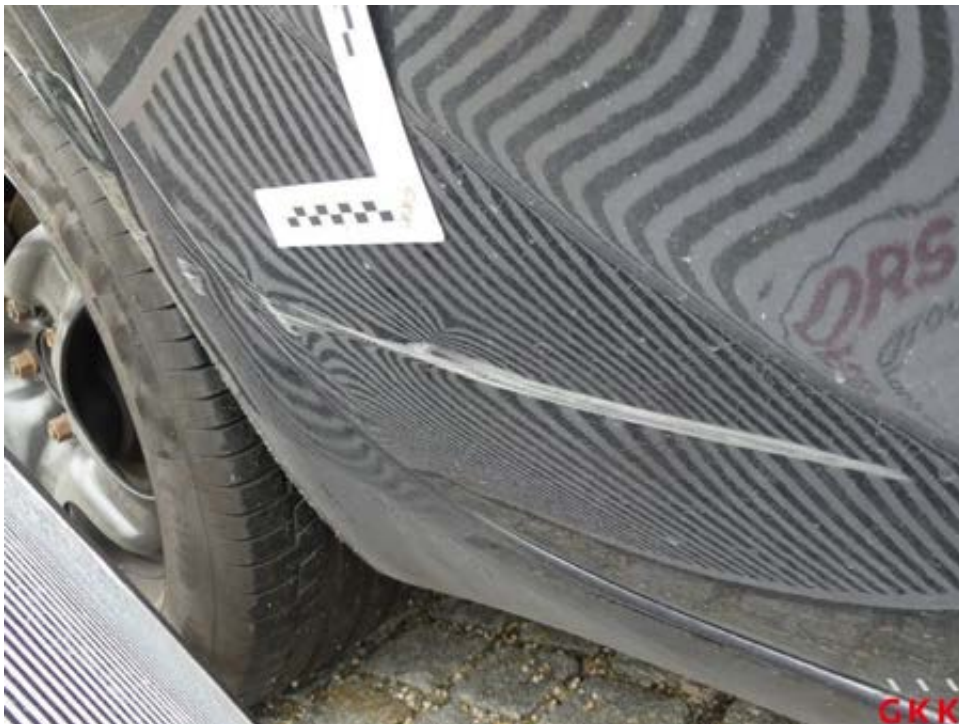
Bild 28 Tür hinten rechts, beschädigt, instand setzen - lackieren
