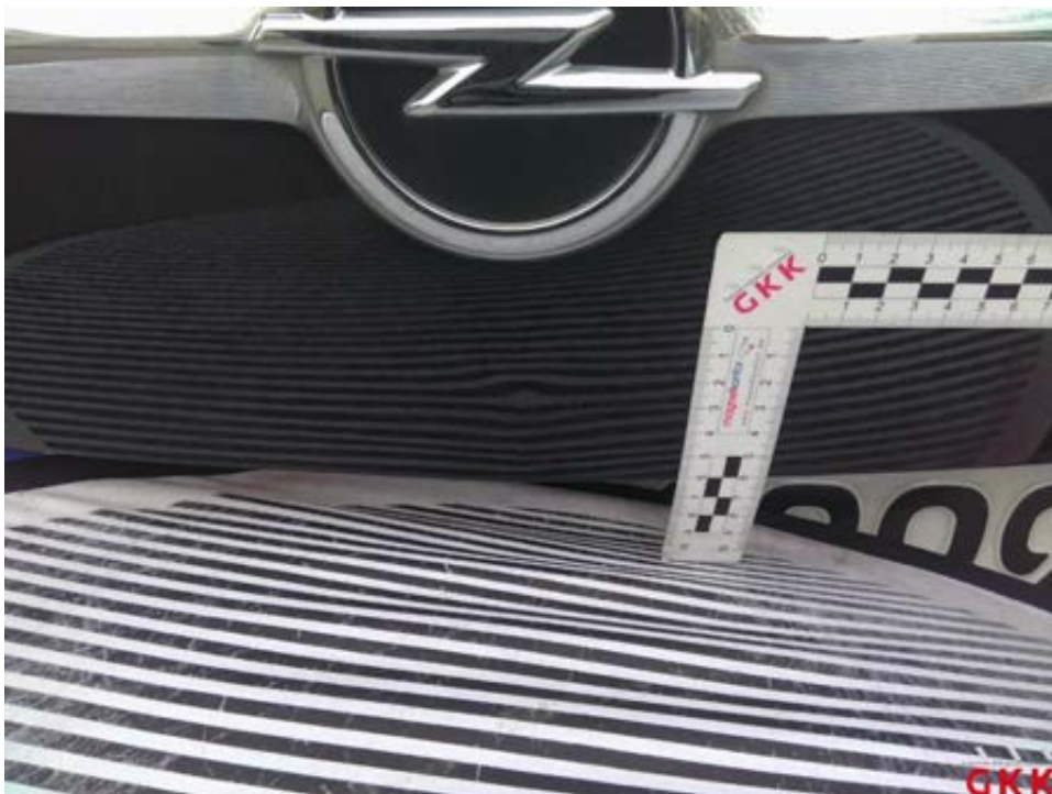
Bild 16 Heckklappe, bis 3 Dellen / Bauteil, kalt drücken
