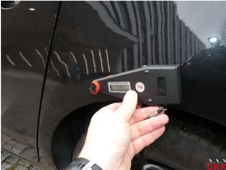
Bild 25 Seitenwand links, Reparaturmangel, lackieren
