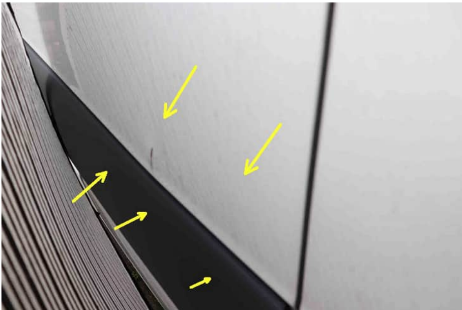
Bild 22 Verformung der Seitenwand links mittig
