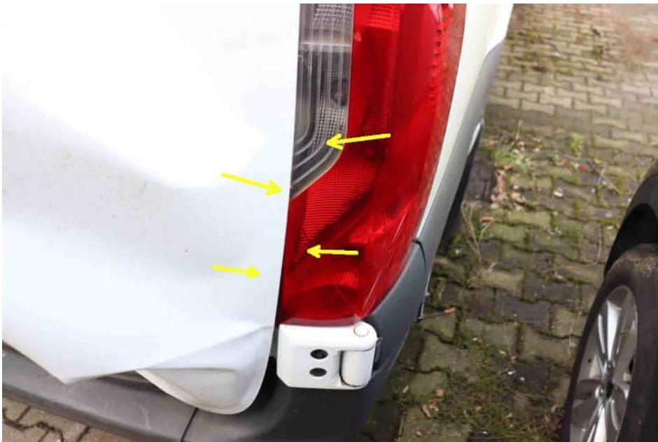
Bild 18 Beschädigung der Rückleuchte rechts
