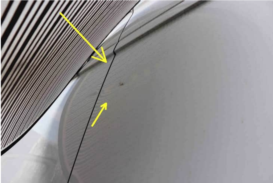
Bild 23 Verformung der Seitenwand links mittig
