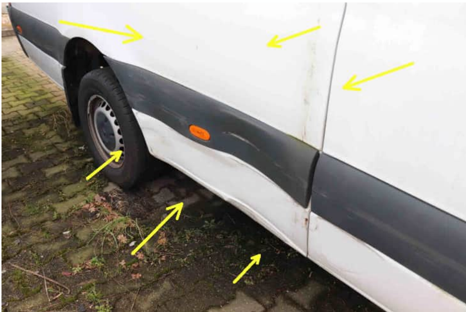
Bild 30 Verformung der Seitenwand rechts
