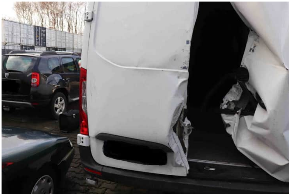
Bild 14 Beschädigung der Hecktür links
