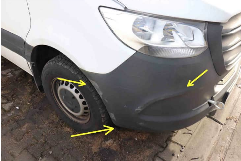
Bild 25 Beschädigung der Frontverkleidung rechts
