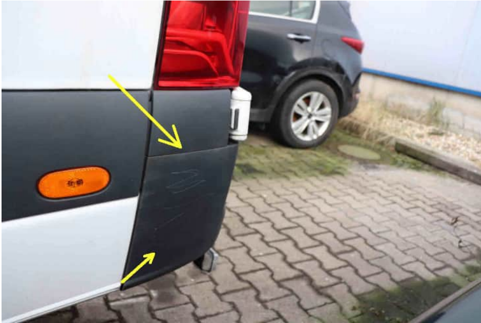
Bild 21 Beschädigung an der Heckverkleidung links
