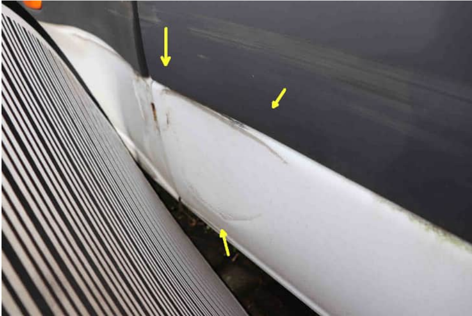
Bild 29 Verformung der Schiebetür rechts
