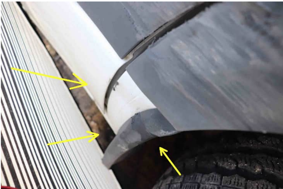
Bild 26 Beschädigung des Radlauf vorne rechts
