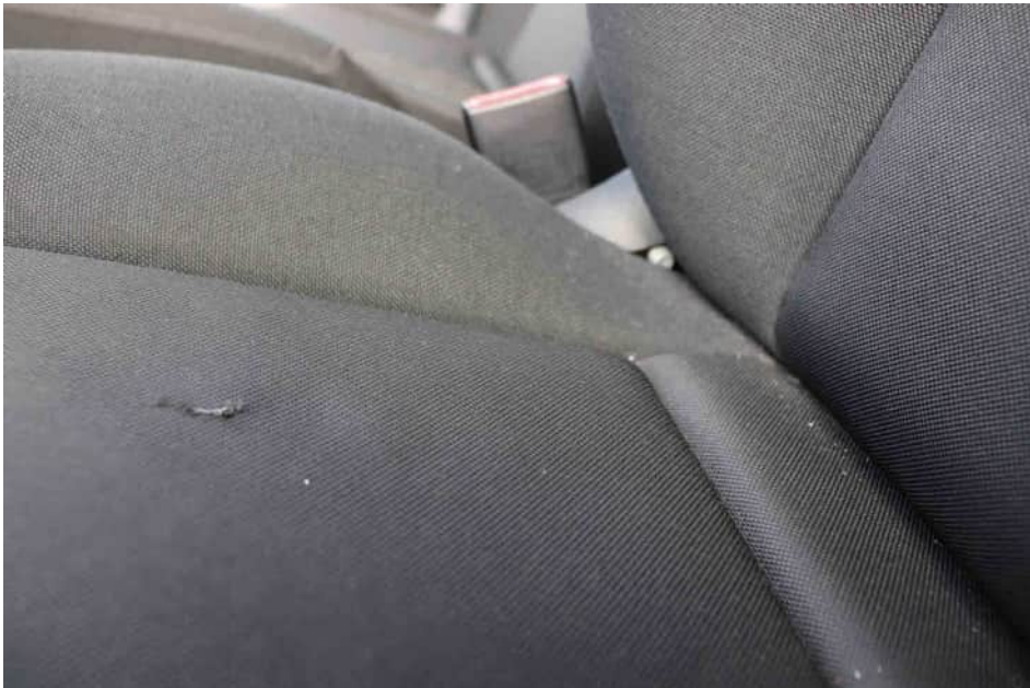
Bild 36 Beschädigung der Sitzfläche links
