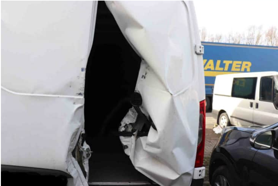
Bild 15 Beschädigung der Hecktür rechts
