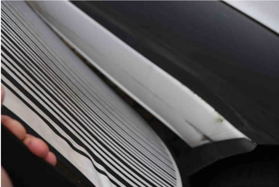
Bild 33 Verformung der Seitenwand rechts
