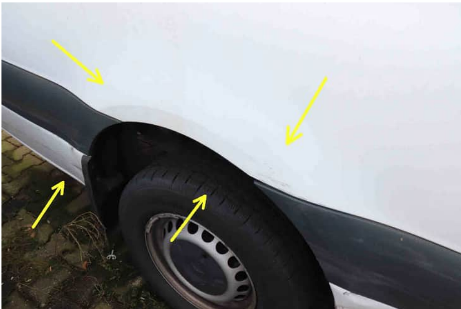
Bild 32 Verformung der Seitenwand rechts
