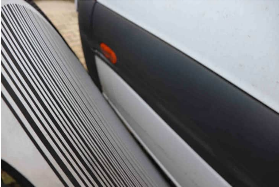
Bild 31 Verformung der Seitenwand rechts
