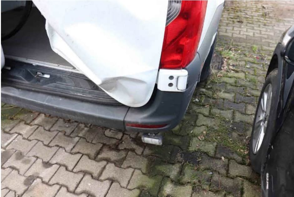
Bild 17 Beschädigung der Hecktür rechts
