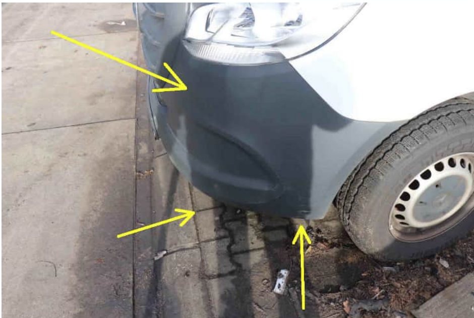
Bild 24 Beschädigung der Frontverkleidung links
