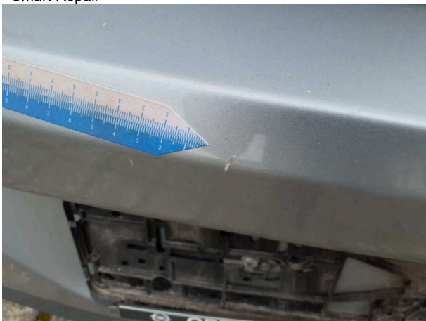
Beschädigung 17: Stossfänger hinten: Stossfänger hinten - Kratzer - lackieren
