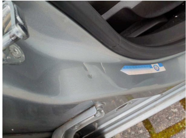
Beschädigung 15: Schweller rechts: Einstieg - Delle / Lackschaden - Smart Repair
