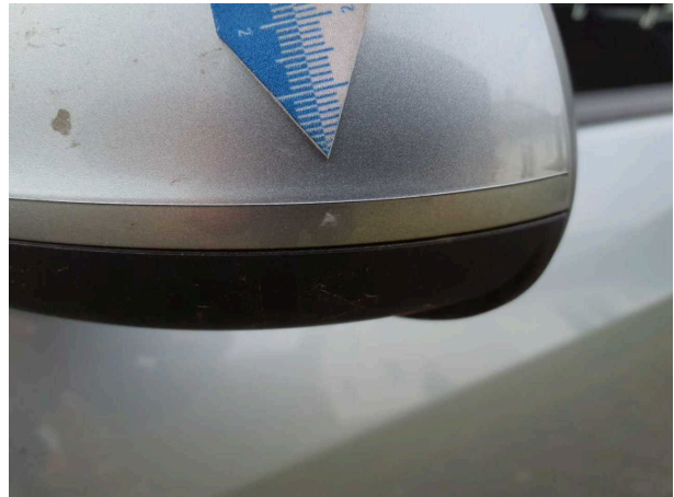
Beschädigung 3: Außenspiegel links: Abdeckkappe - Kratze... Smart Repair
