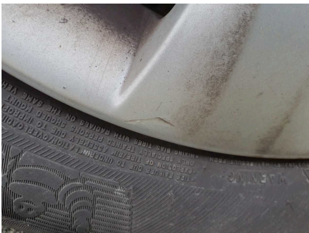
Beschädigung 8: Rad/Reifen: Leichtmetallfelge hinten links - Kratzer - Smart Repair
