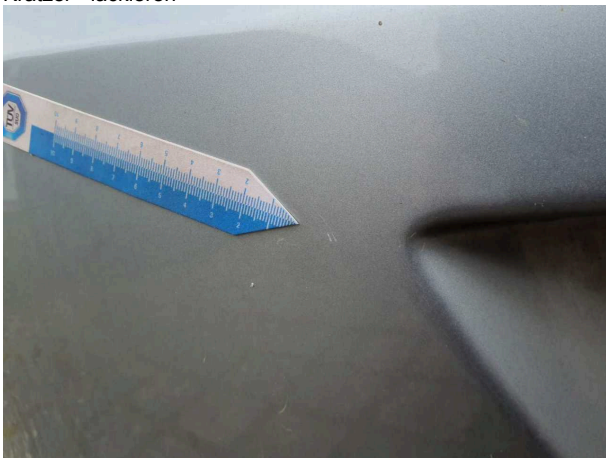
Beschädigung 17: Stossfänger hinten: Stossfänger hinten - Kratzer - lackieren
