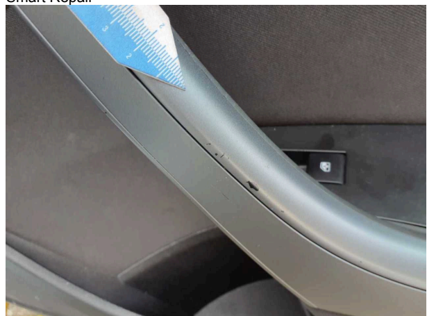
Beschädigung 12: Verkleidungen/Abdeckungen: Türverkleidung vorn rechts - Abrieb - Smart Repair
