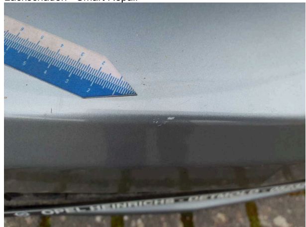
Beschädigung 17: Stossfänger hinten: Stossfänger hinten - Kratzer - lackieren
