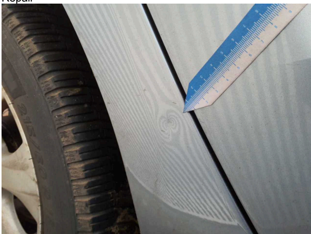
Beschädigung 11: Seitenwand rechts: Seitenwand - Delle / Lackschaden - Smart Repair
