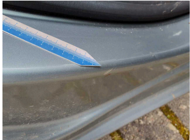
Beschädigung 10: Seitenwand rechts: Einstieg - Kratzer - Smart Repair
