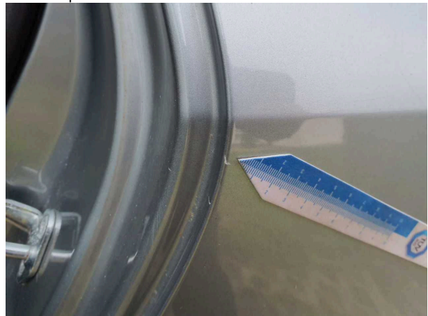
Beschädigung 5: Seitenwand links: Seitenwand - Kratzer - Smart Repair
