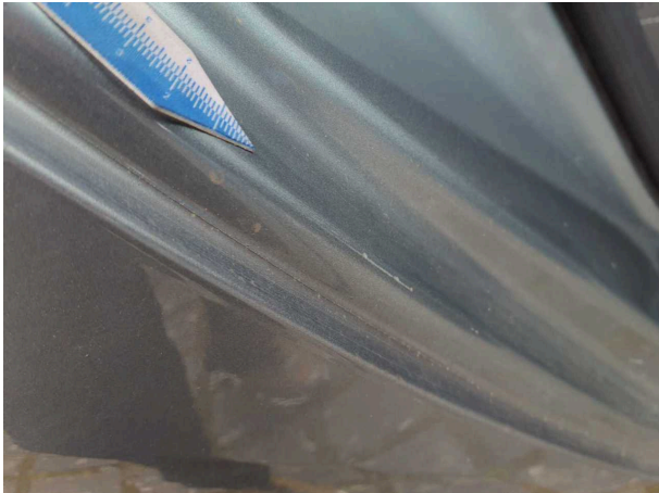
Beschädigung 10: Seitenwand rechts: Einstieg - Kratzer - Smart Repair
