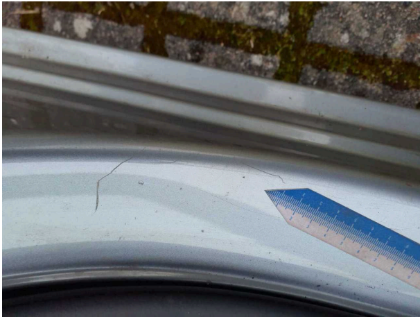
Beschädigung 14: Schweller links: Einstieg - Delle / Lackschaden - Smart Repair
