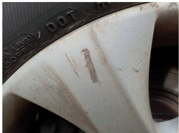
Beschädigung 9: Rad/Reifen: Leichtmetallfelge hinten rech... Kratzer - Smart Repair
