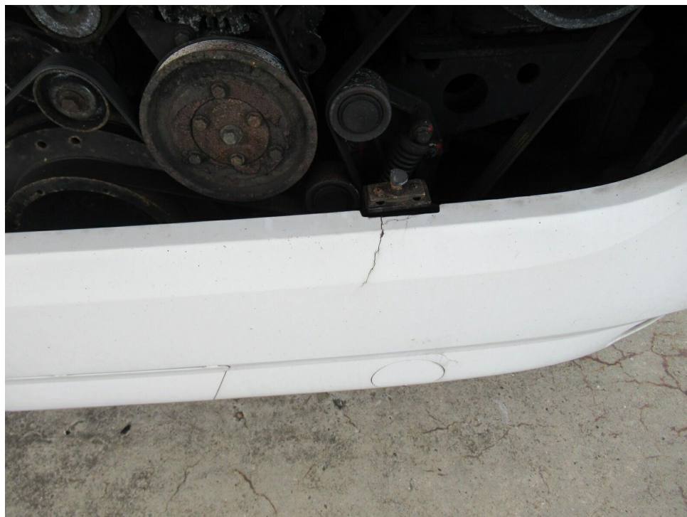
Bild 12 : Stoßfänger-Mittelsegment hinten mehrfach gebrochen
