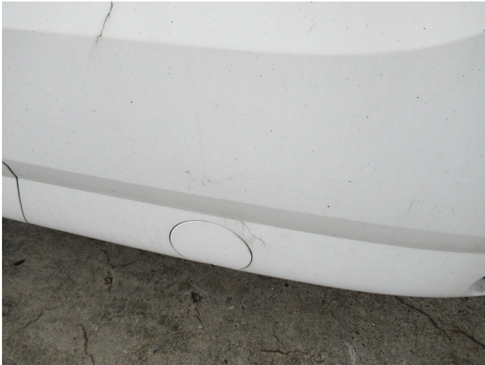
Bild 13 : Stoßfänger-Mittelsegment hinten mehrfach gebrochen
