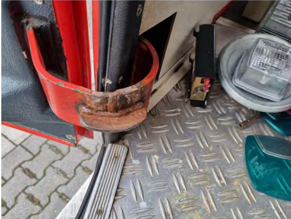
Bild 38 : Scharnier Fondtür links repariert
