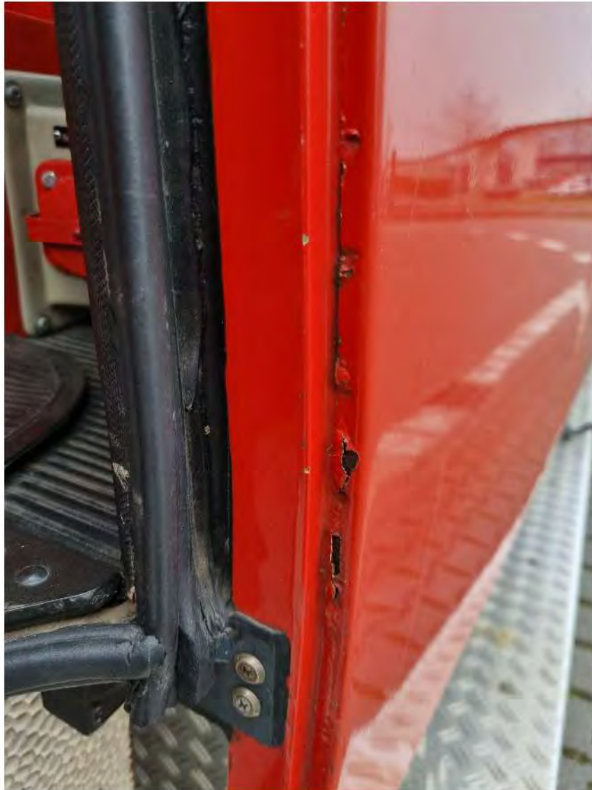
Bild 39 : Fahrerhaus mehrfach korrodiert (Stelle beispielhaft)
