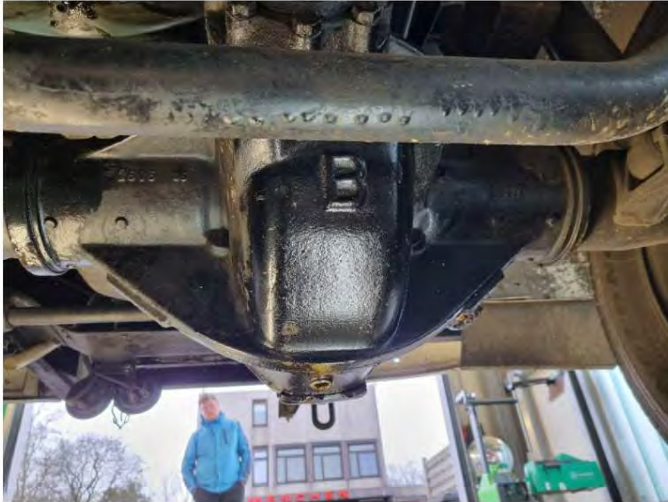
Bild 27 : Differential vorn verölt
