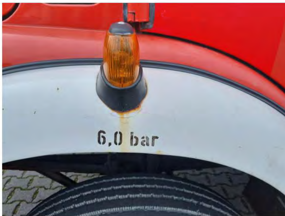
Bild 31 : Kotflügel links korrodiert
