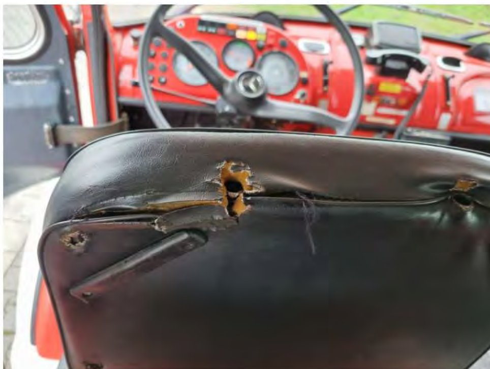
Bild 37 : Fahrersitz Plosterung / Bezug beschädigt
