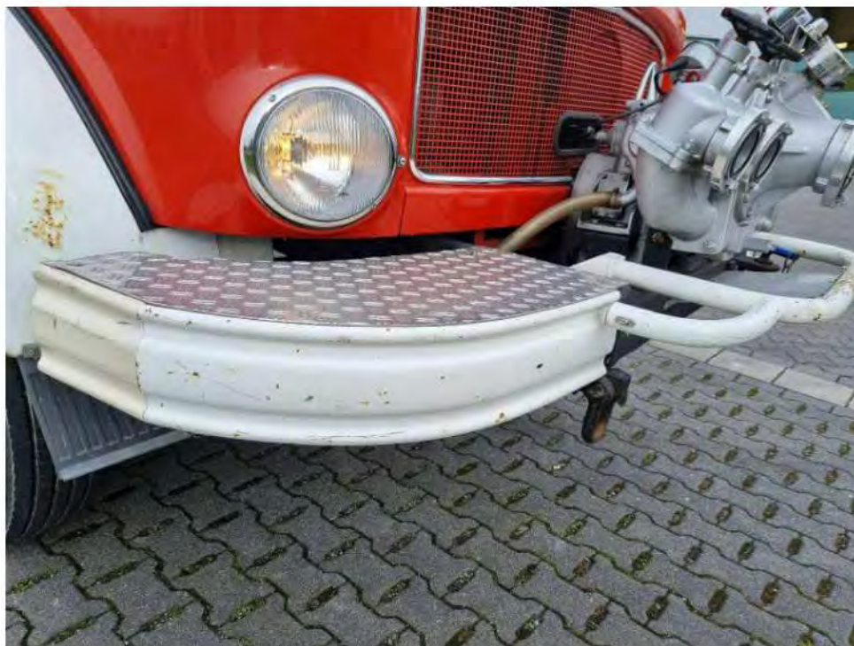
Bild 29 : Kotflügel und Stoßfänger verbeult / korrodiert
