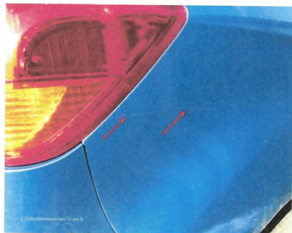
Seitenwand rechts verkratzt
