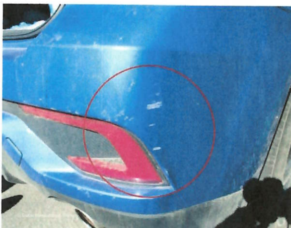
Stoßfängerabdeckung hinten verschrammt
