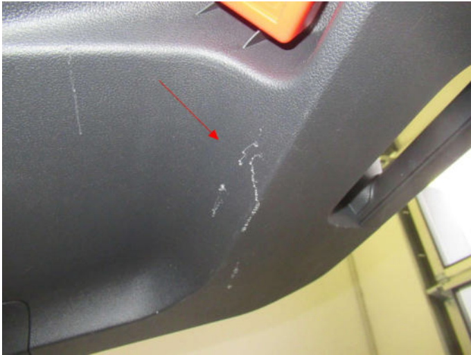
Bild 5: Innen, Verkleidung Heckklappe, verschrammt, erneuern
