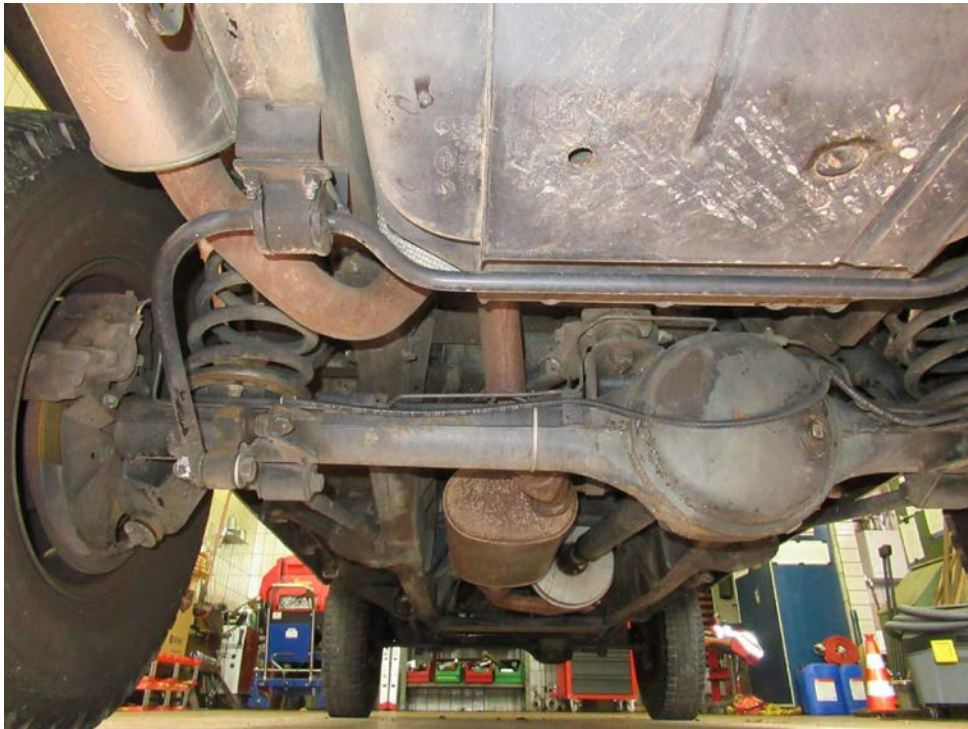
Bild 7 : Radvorgelege Hinterachse links und rechts undicht
