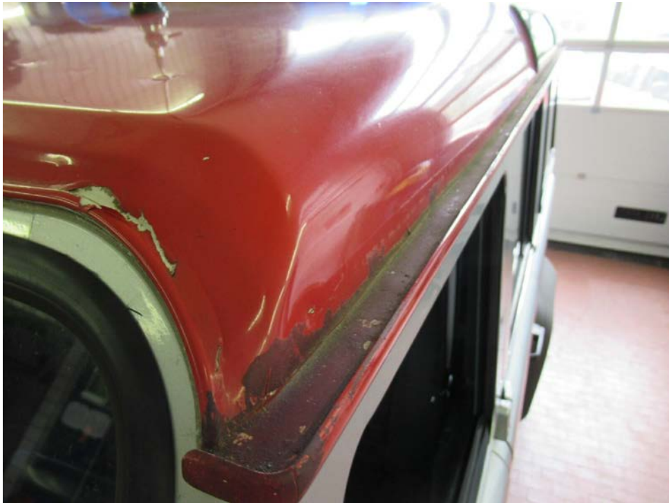
Bild 9 : Lackierung Dach teilweise angeschlagen
