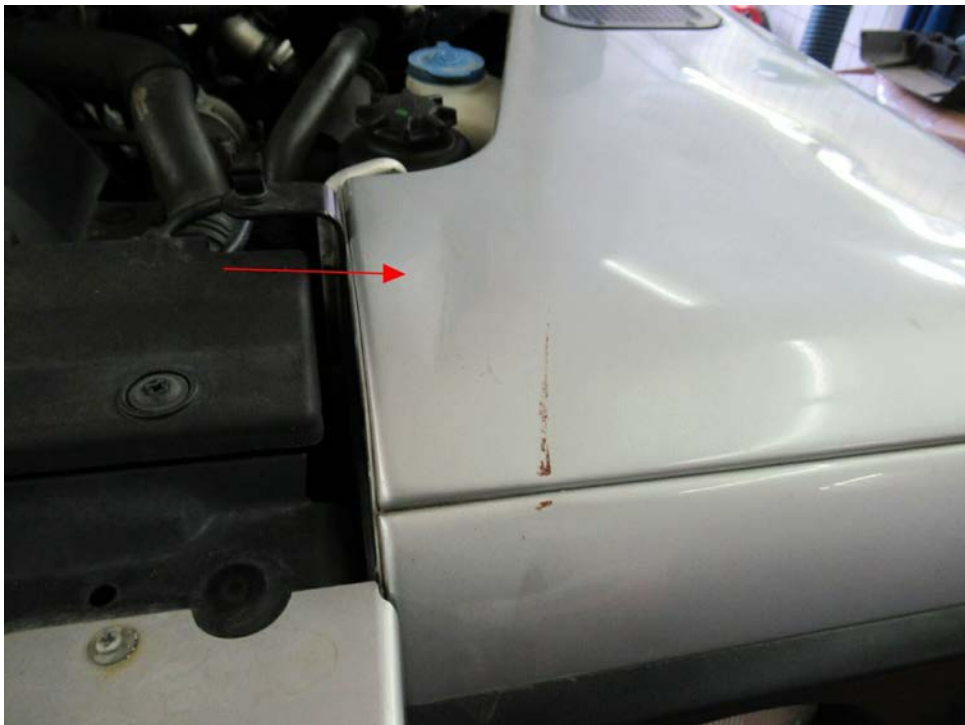
Bild 6 : Kotflügel links eingedellt
