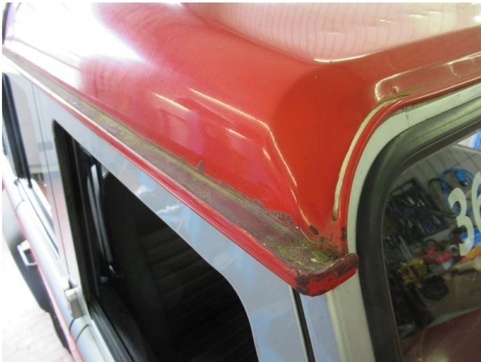
Bild 8 : Lackierung Dach teilweise angeschlagen
