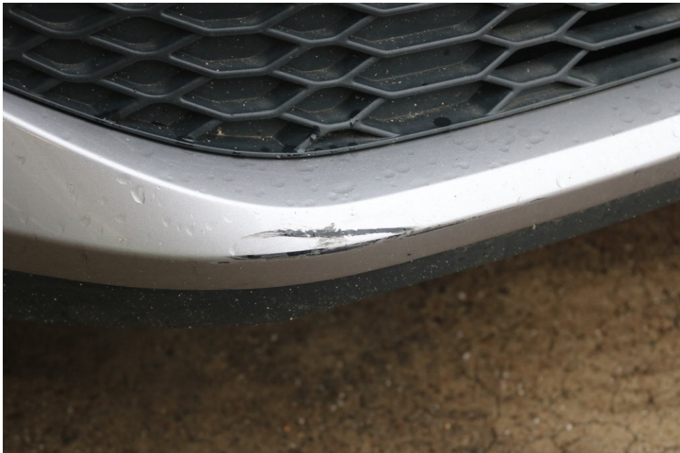
Bild 16 Stoßfängerverkleidung vorne verkratzt / beschädigt
