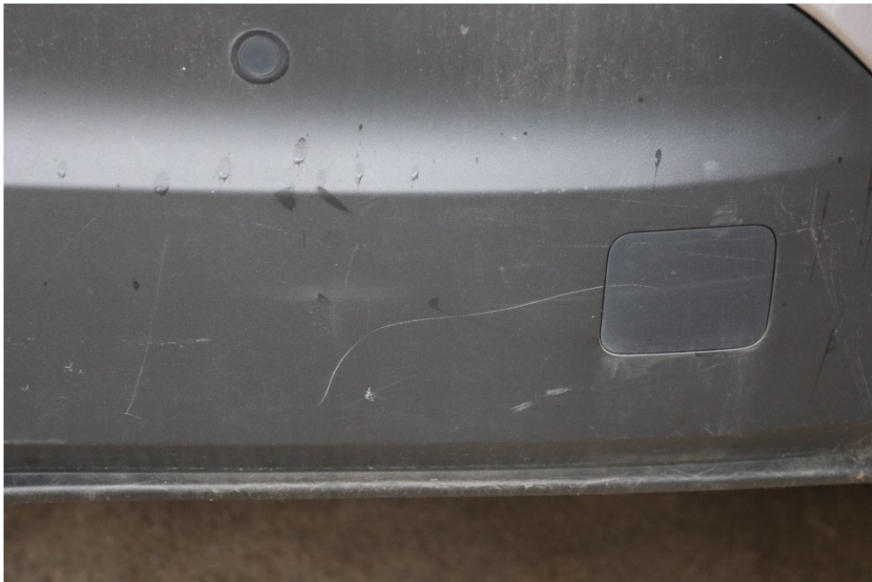
Bild 14 Stoßängerverkleidung vorne verkratzt
