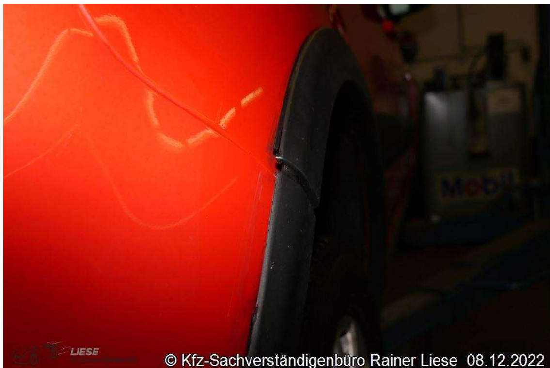
Foto 8: Verbreiterungen hinten rechts lose
