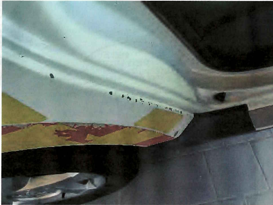
Bild 7 : Radlauf hinten rechts Lackschaden und Stauchungen
