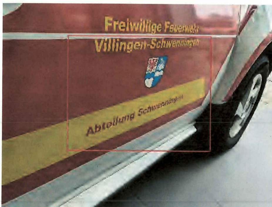
Bild 31 : Tür vorne rechts geknickt/ Delle
