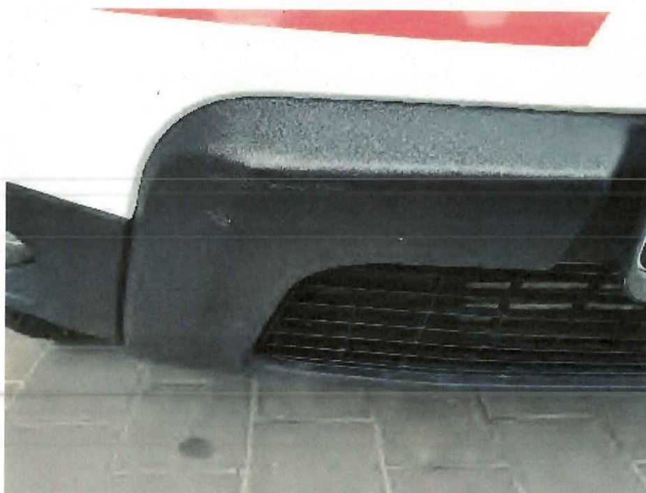
Bild 26 : Stoßfänger vorne gestaut und verformt, verschrammt
