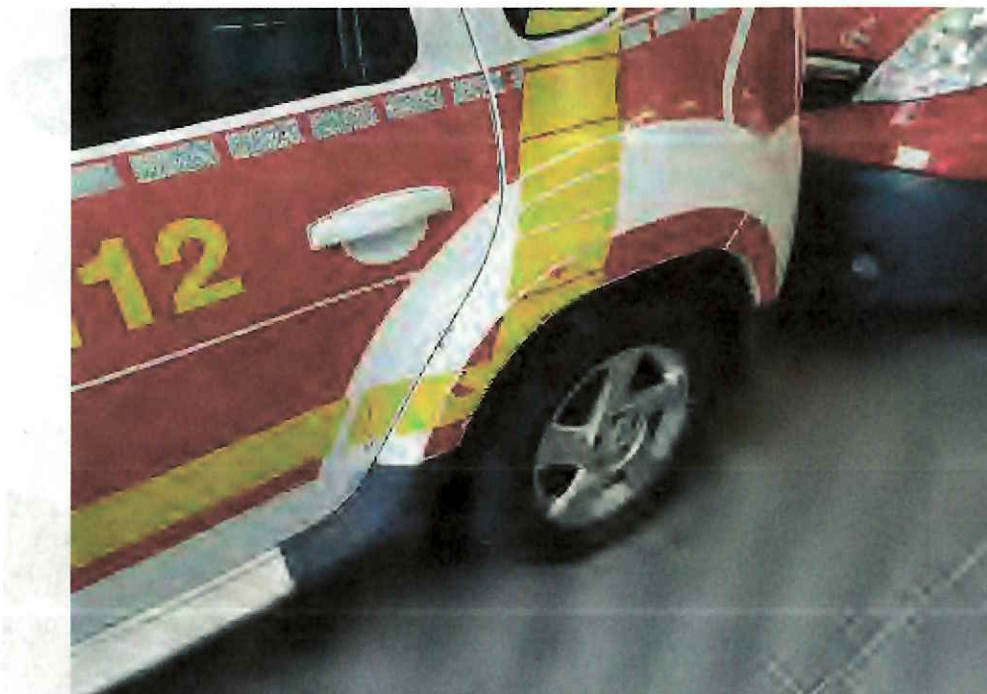
Bild 12 : Radlauf hinten links Lackschaden, Rost und Stauchungen
