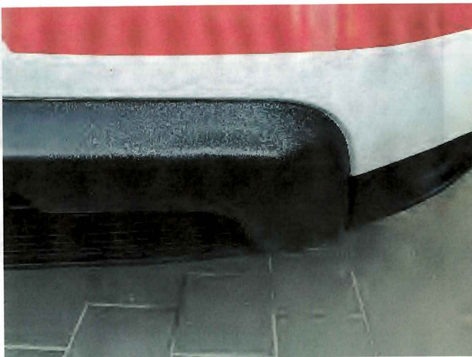
Bild 27 : Stoßfänger vorne gestaucht und verformt, verschrammt
