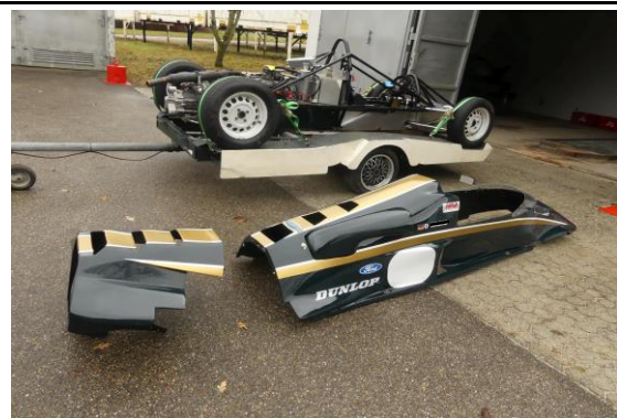
Ansicht Verkleidungen demontiert
