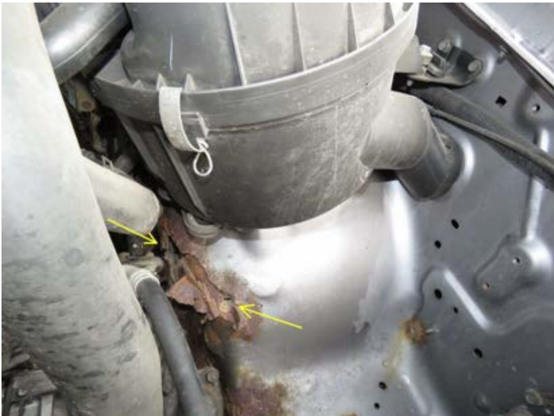
Bild Nr: 13 Radhaus vorne links durchgerostet
