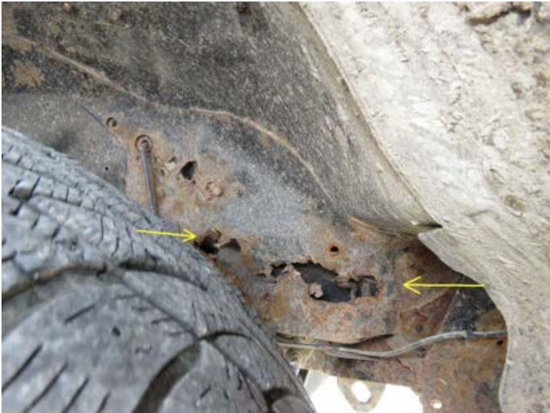
Bild Nr: 23 Radhaus vorne rechts durchgerostet
