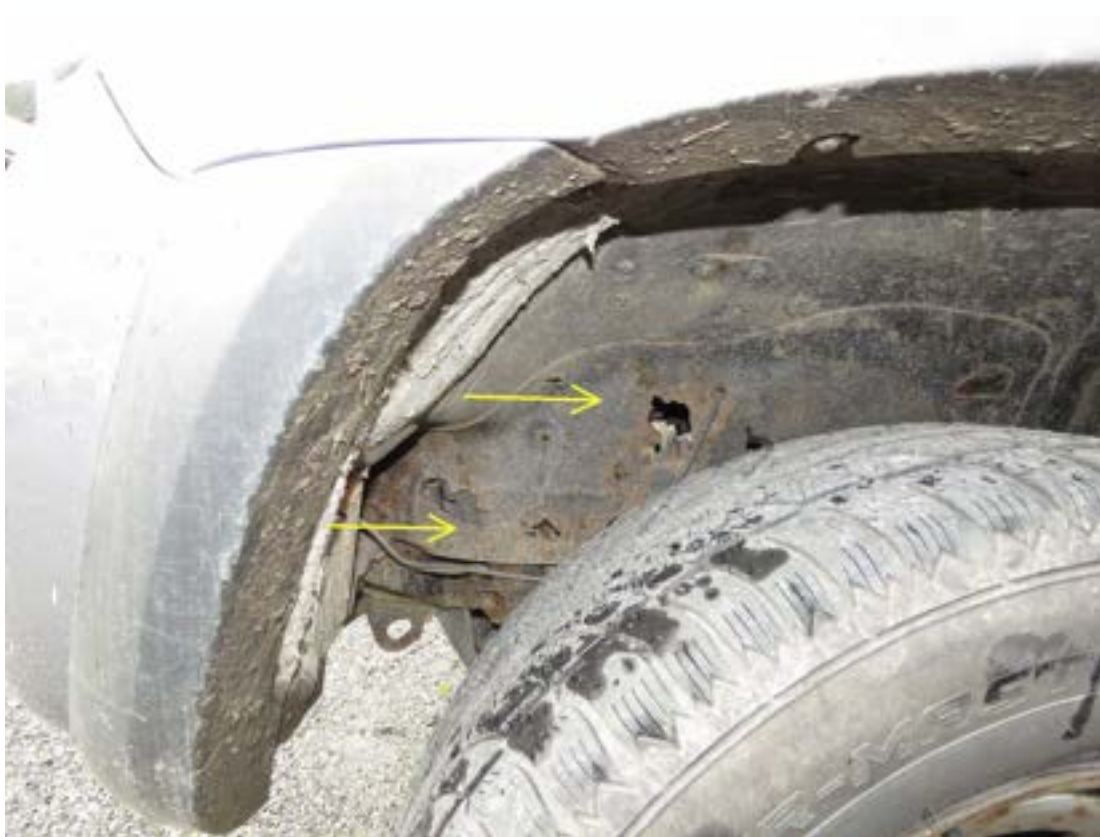
Bild Nr: 12 Radhaus vorne links durchgerostet
