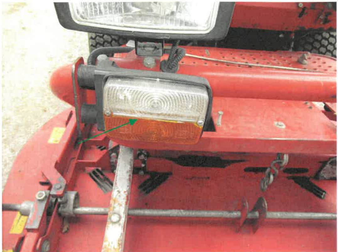
Bild 28 : Glas Blinker / Standlicht vorn rechts gebrochen
