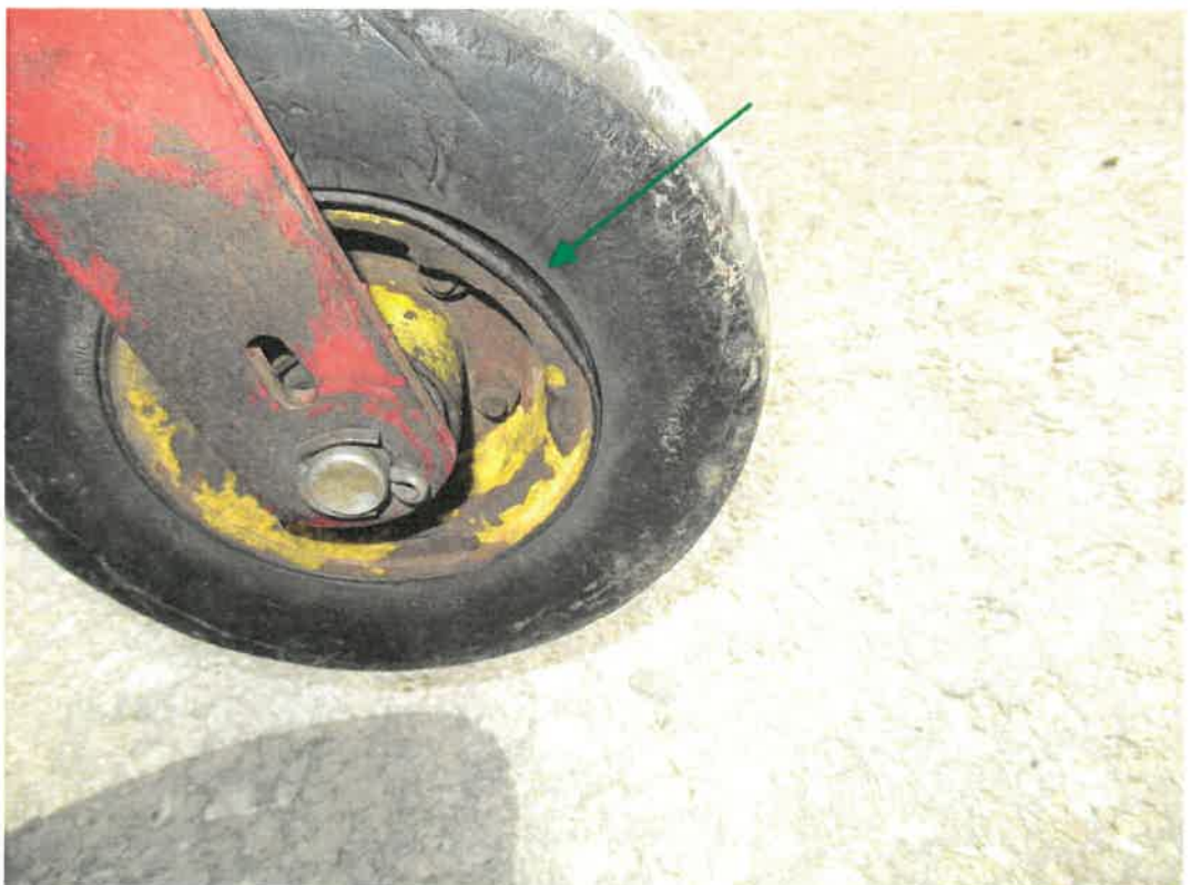
Bild 31 : Felge Mähwerk vorn eingedrückt
