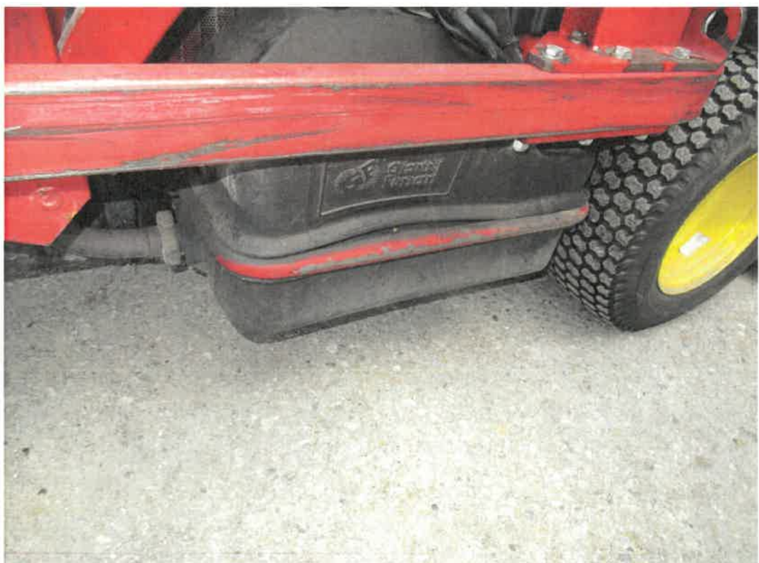
Bild 25 : Kraftstofftank nach innen gezogen
