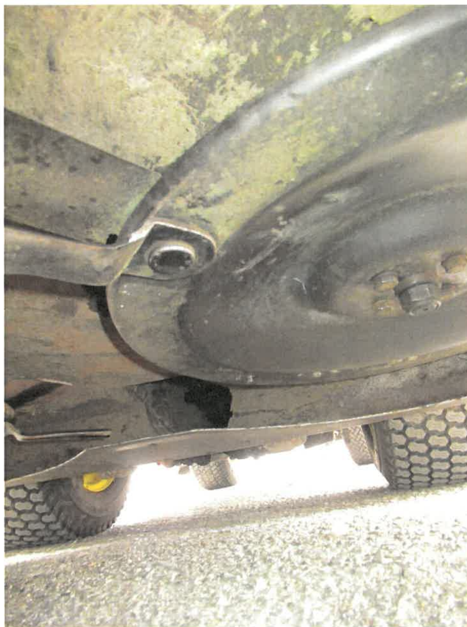
Bild 19 : Verschleiß Frontmähwerk unten
