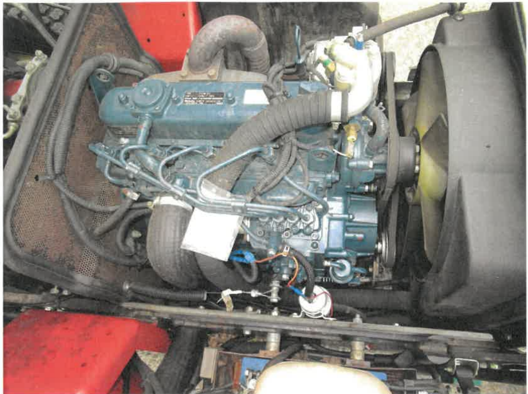
Bild 11 : Tauschmotor 06/15 bei ca 3000 Std erfolgte Tausch
