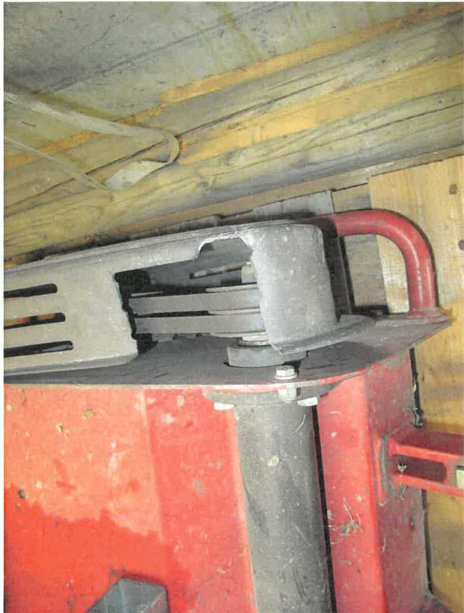
Bild 35 : Keilriemenabdeckung Vertikutierer gebrochen
