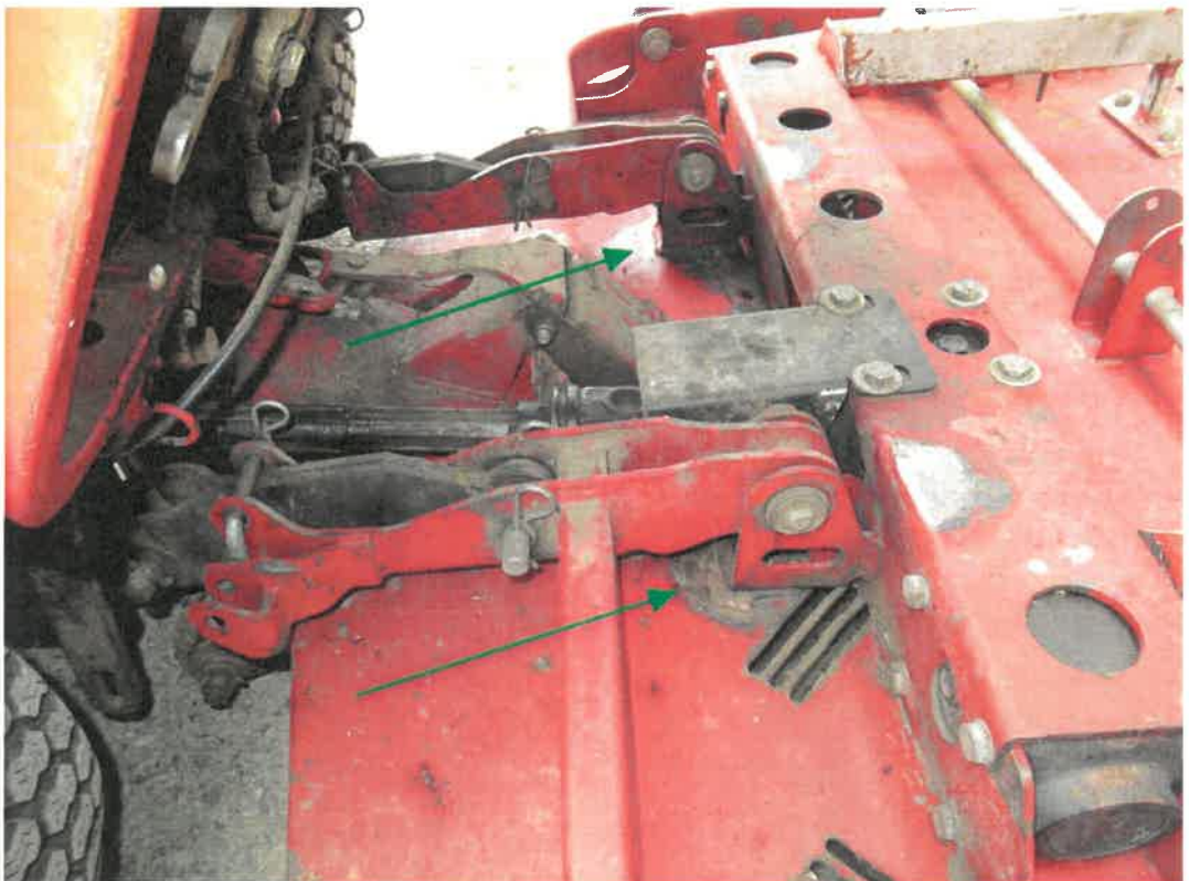
Bild 21 : Frontmäher Reparaturschweißungen exemplarisch
