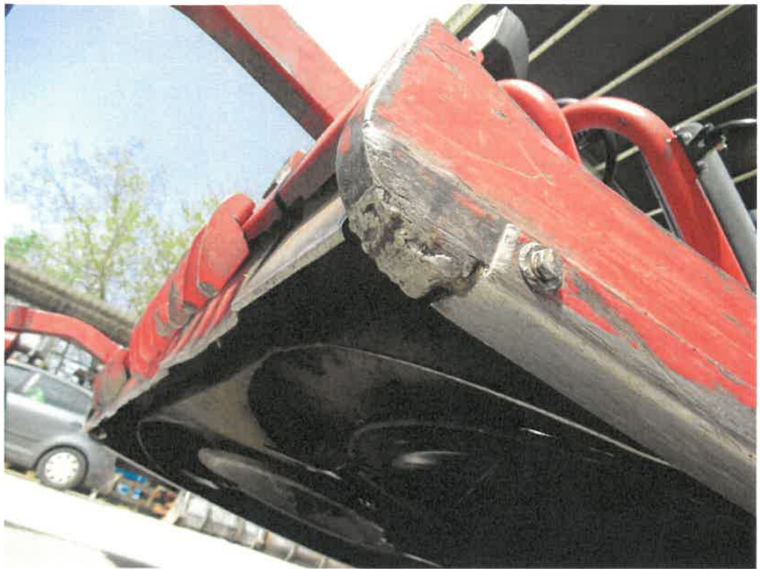
Bild 30 : Aufschweißungen am Frontmähwerk vorn exemplarisch
