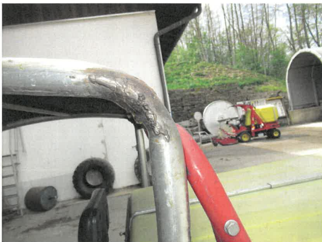
Bild 27 : Sonnenschutzdach mehrmals Halter eingerissen und geschweißt exemplarisch
