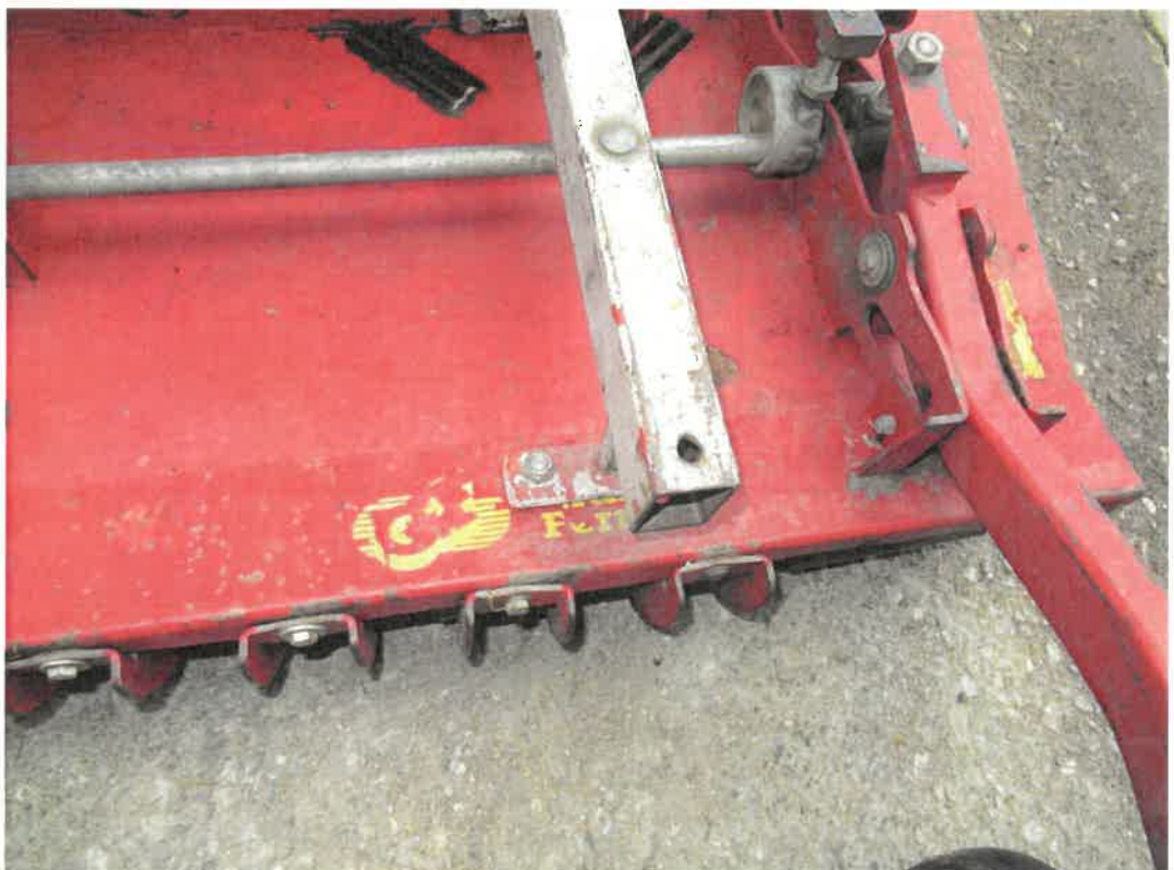
Bild 10 : Typschild Frontmäher fehlt ( Austausch in 2008 erfolgt )
