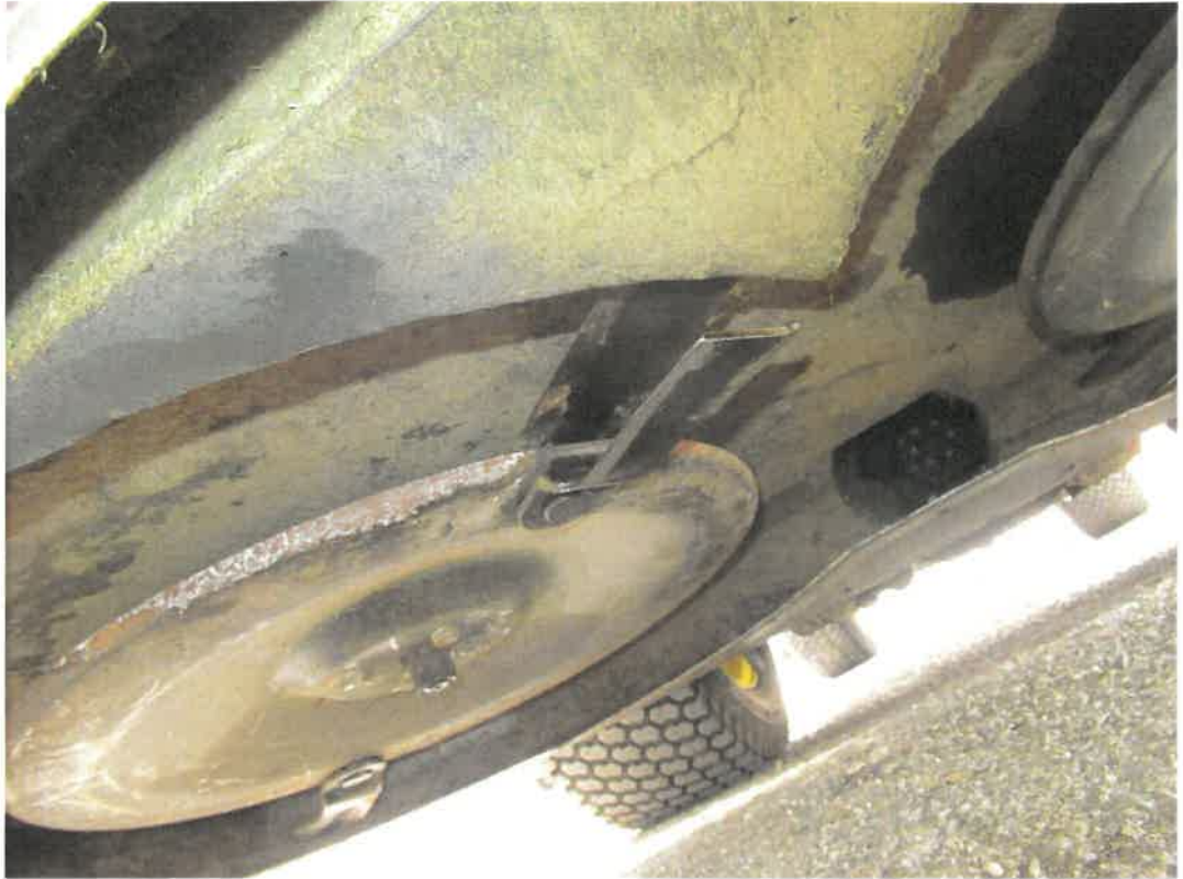
Bild 20 : Zustand Mähteller und Schneidmesser
