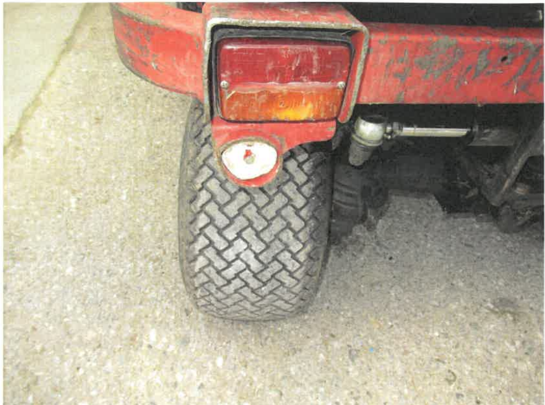
Bild 24 : Rückleuchtenglas links gebrochen Rückstrahler beidseitig gebrochen
