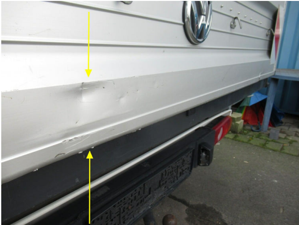
Bild 15 : Aufbau Heckklappe links/mittig/rechts eingedrückt und verschürft
