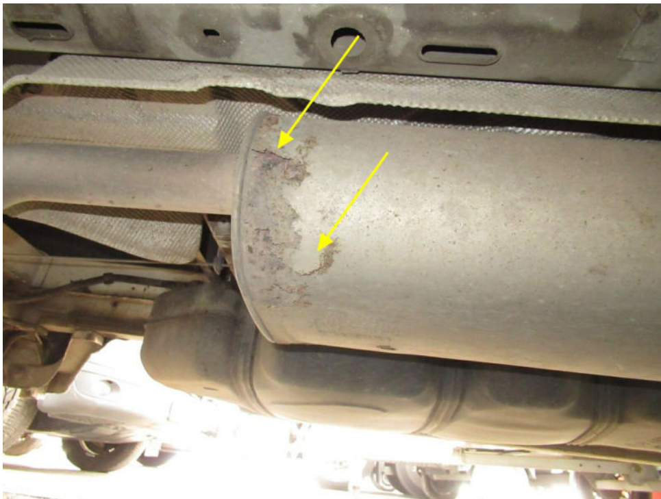
Bild 34 : Abgasenschalldämpfer Aussenhaut korrodiert
