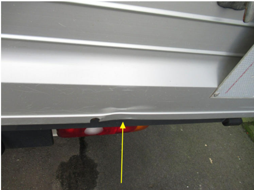
Bild 16 : Aufbau Heckklappe links/mittig/rechts eingedrückt und verschürft
