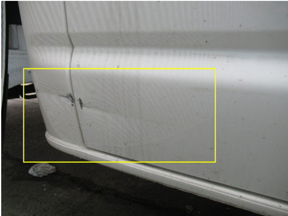
Bild 19 : Heckwand rechts und Fondtür rechts unterhalb eingedrückt und verschrammt
