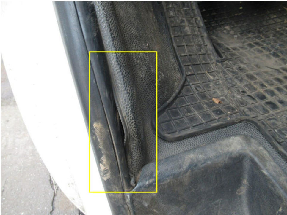
Bild 24 : Bodenbelag Fahrerfußraum verformt
