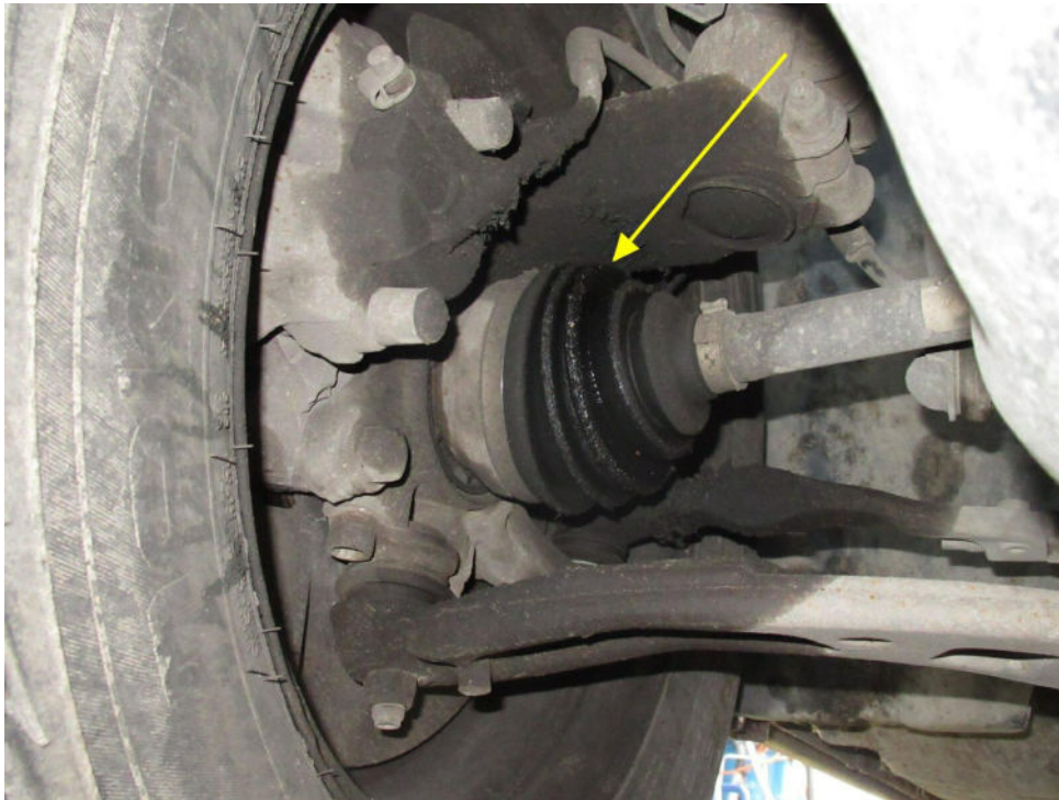
Bild 33 : Antriebswellenmanschette rechts außen Fettverlust
