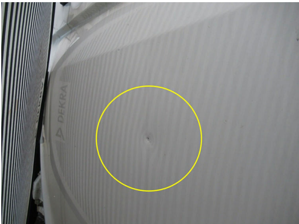
Bild 20 : Fondtür rechts Mitte eingedellt und im Lack beschädigt
