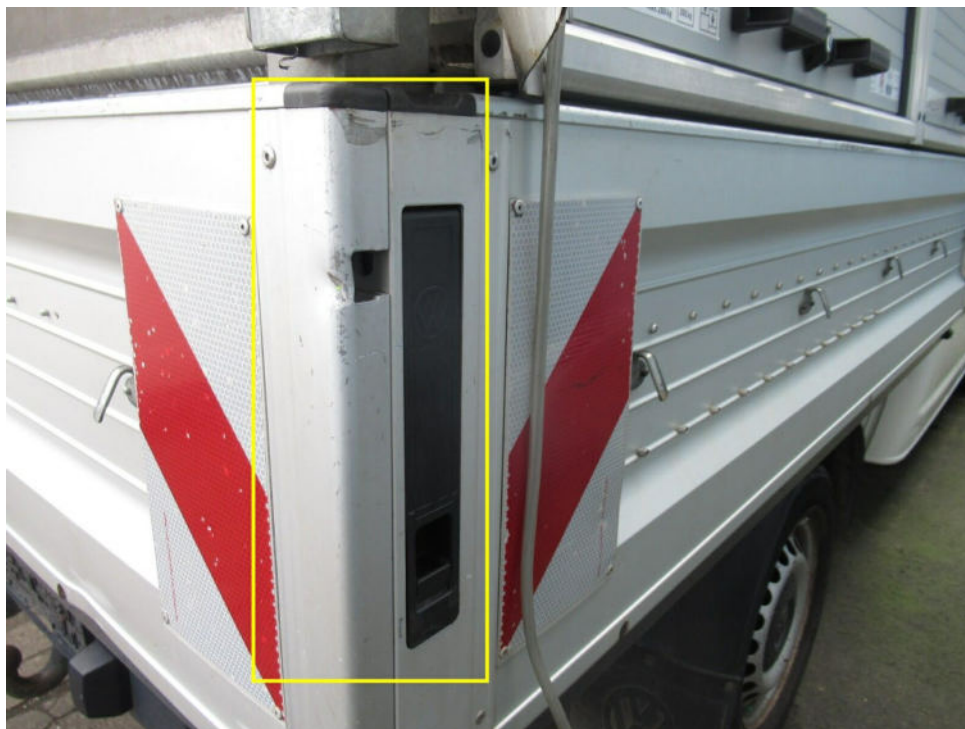
Bild 17 : Aufbau Heckklappe links/mittig/rechts eingedrückt und verschürft
