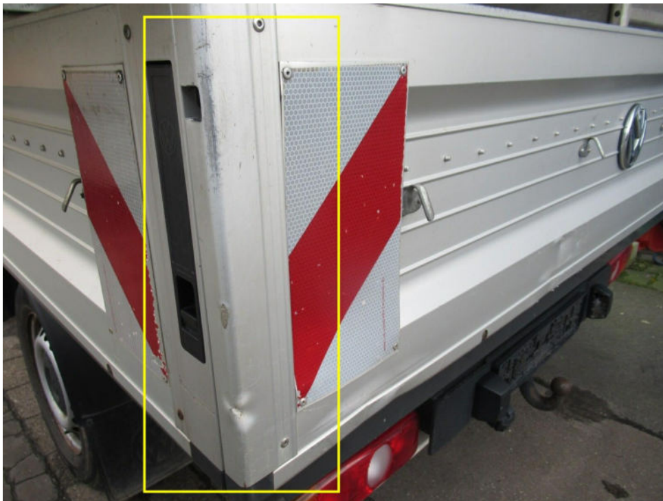
Bild 14 : Aufbau Heckklappe links/mittig/rechts eingedrückt und verschürft
