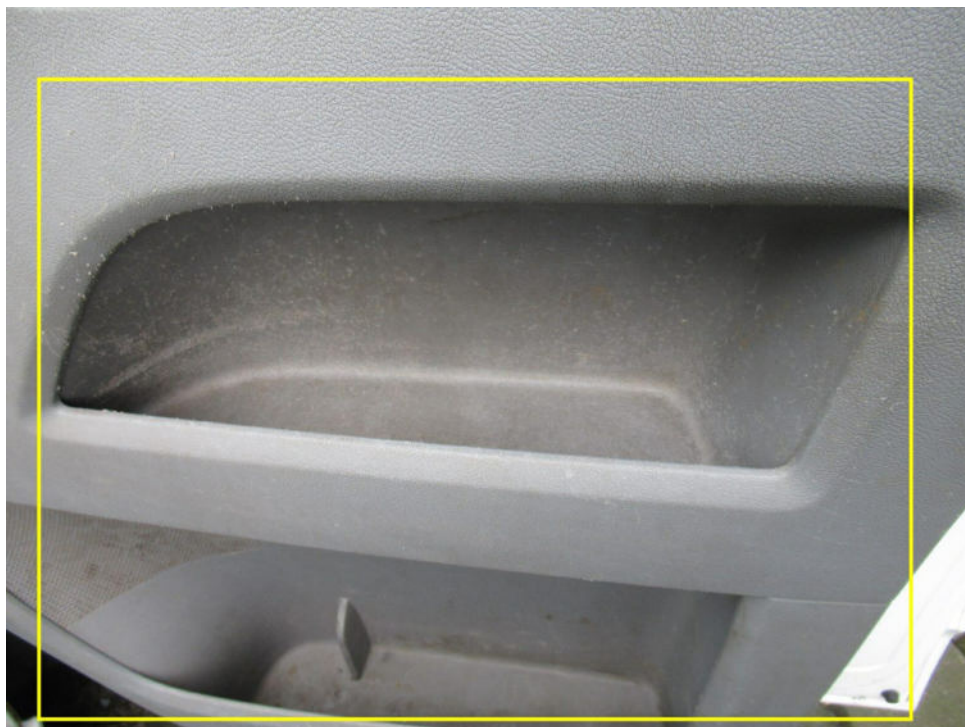
Bild 28 : Beifahrertür Verkleidung innen verkratzt und verunreinigt
