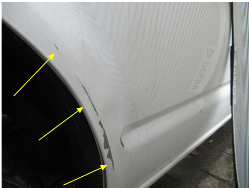
Bild 11 : Fahrertür eingedrückt und verschrammt
