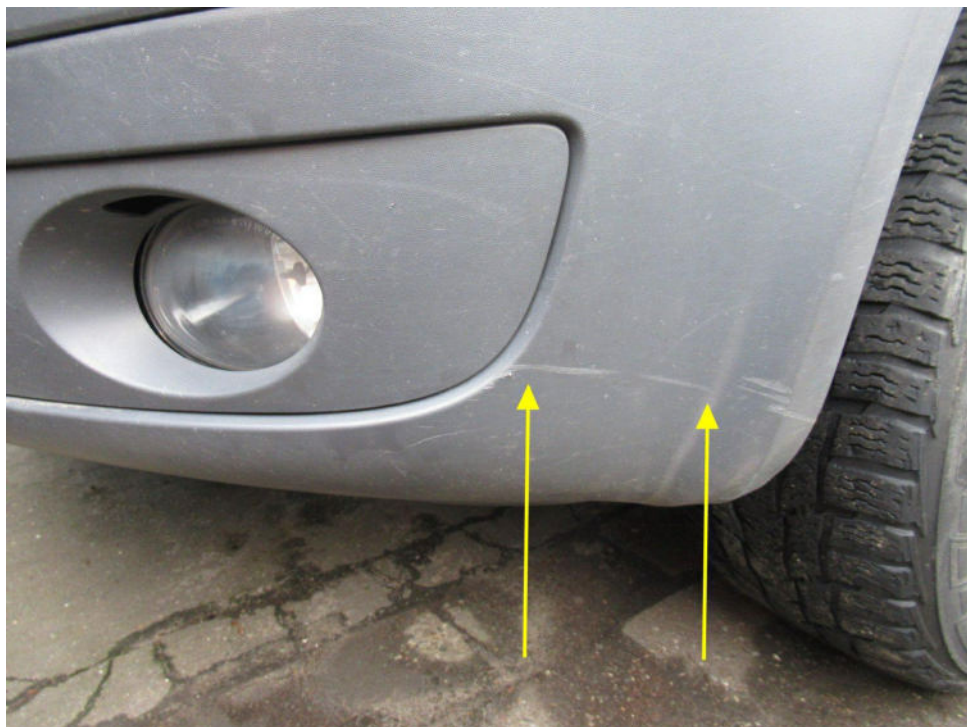
Bild 8 : Stoßfänger vorn links/rechts unterhalb verkratzt
