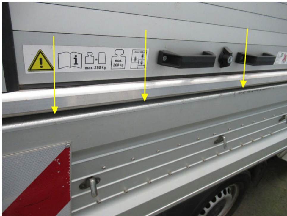
Bild 18 : Aufbau Seitenklappe rechts verschürft
