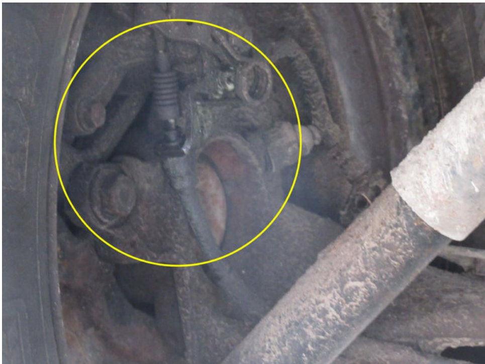
Bild 32 : Hinterachse rechts Bremsflüssigkeitsverlust
