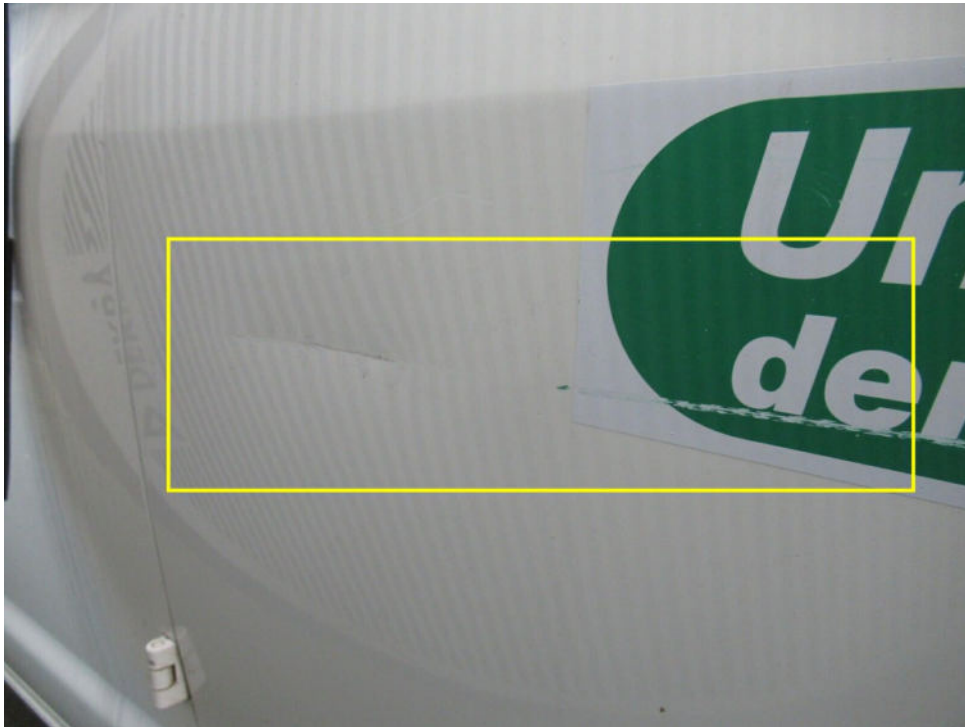
Bild 21 : Beifahrertür mittig eingedrückt und verschrammt
