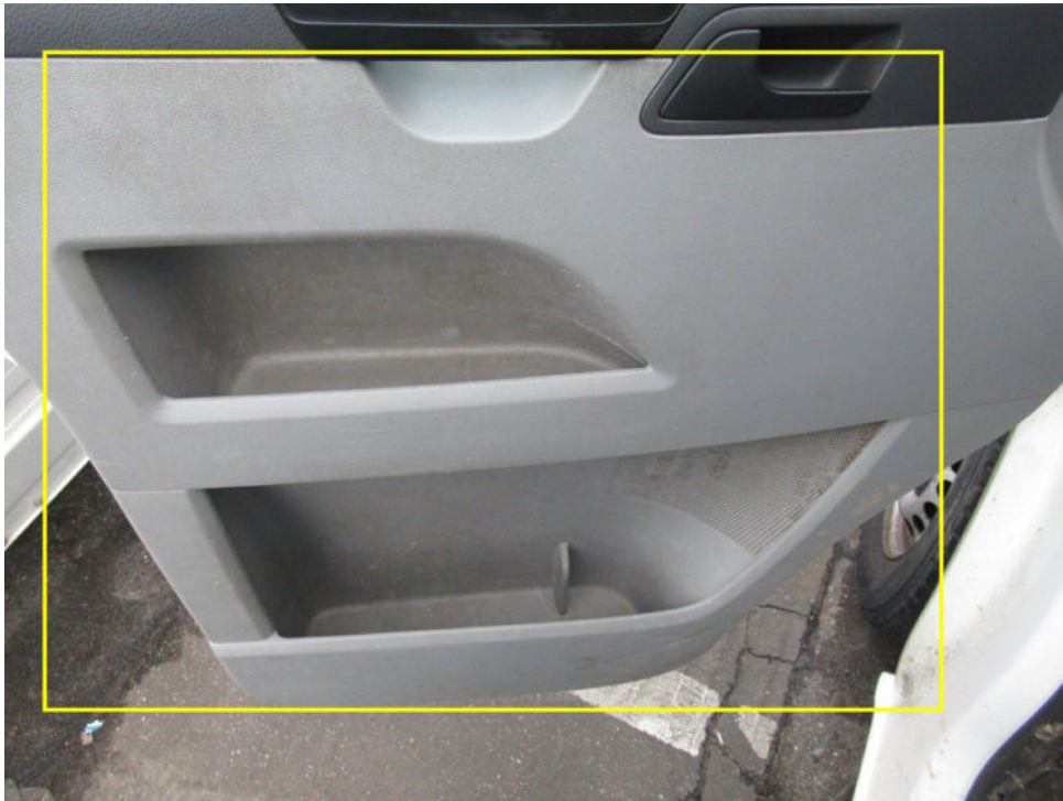
Bild 23 : Fahrertür Verkleidung innen verkratzt und verunreinigt
