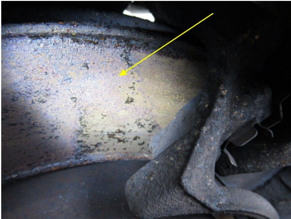
Bild 31 : Hinterachse Bremsscheiben Korrosionsbildung
