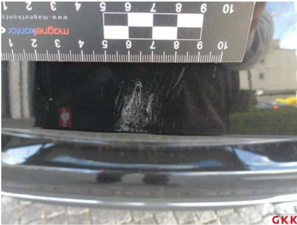
Bild 25 Heckklappe, unterhalb, verkratzt, lackieren
