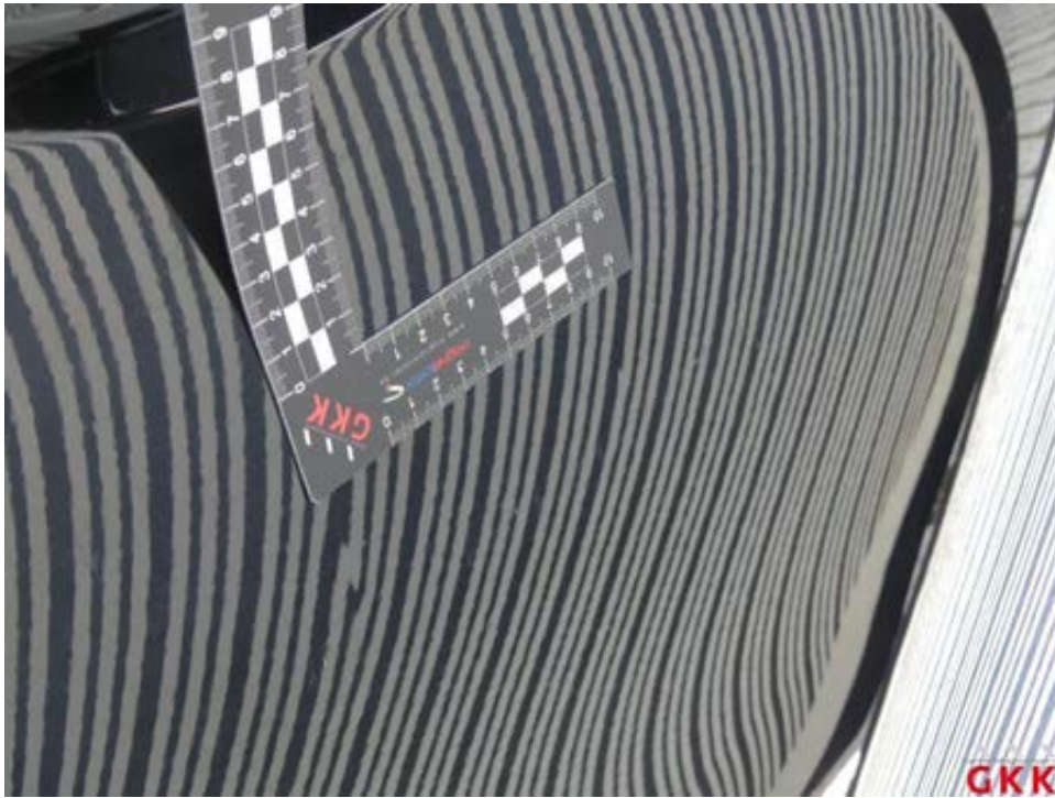
Bild 35 Tür vorne rechts, beschädigt, instand setzen - lackieren
