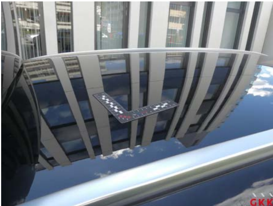
Bild 36 Dach, verkratzt, lackieren
