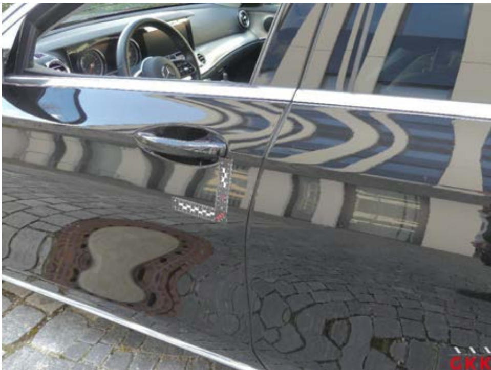
Bild 18 Tür vorne links, beschädigt, instand setzen - lackieren
