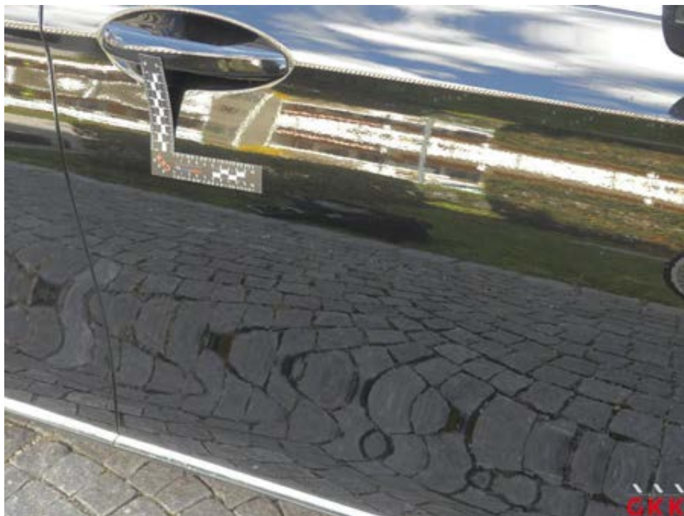
Bild 34 Tür vorne rechts, beschädigt, instand setzen - lackieren
