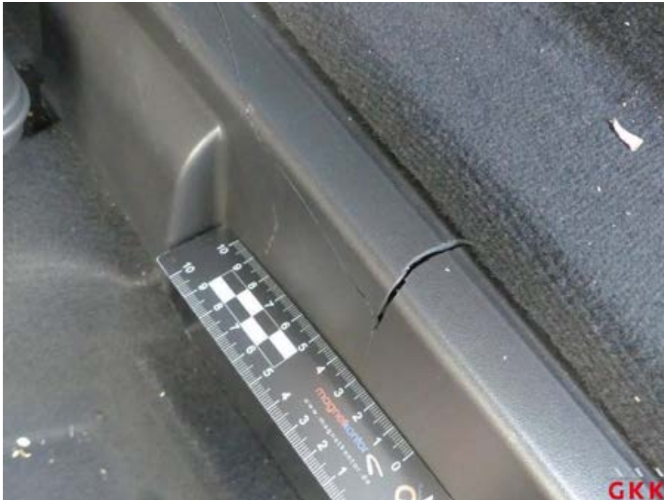
Bild 31 Laderaum, Innenverkleidung, beschädigt, ersetzen
