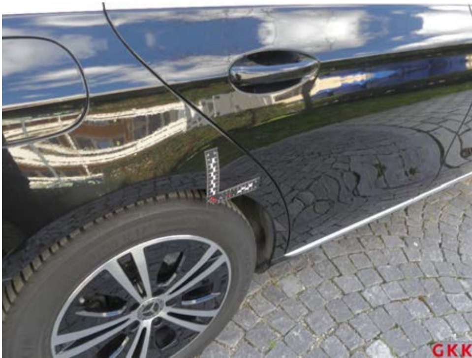
Bild 28 Seitenwand rechts, beschädigt, instand setzen - lackieren
