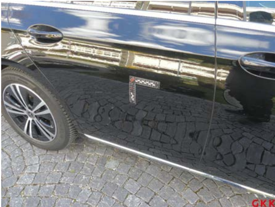
Bild 32 Tür hinten rechts, verkratzt, lackieren
