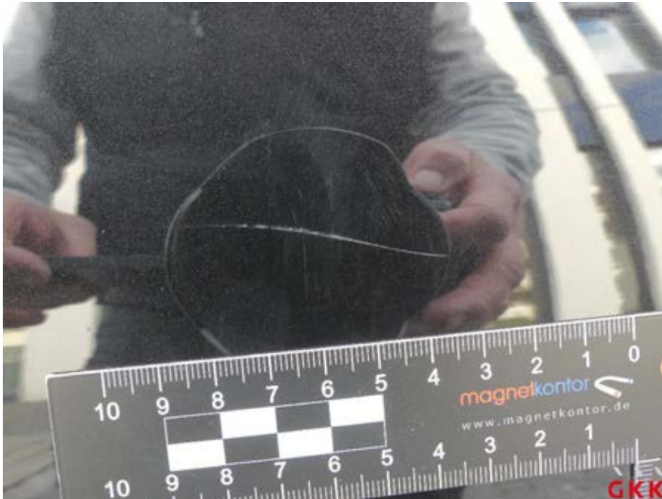
Bild 23 Tür hinten links, verkratzt, lackieren
