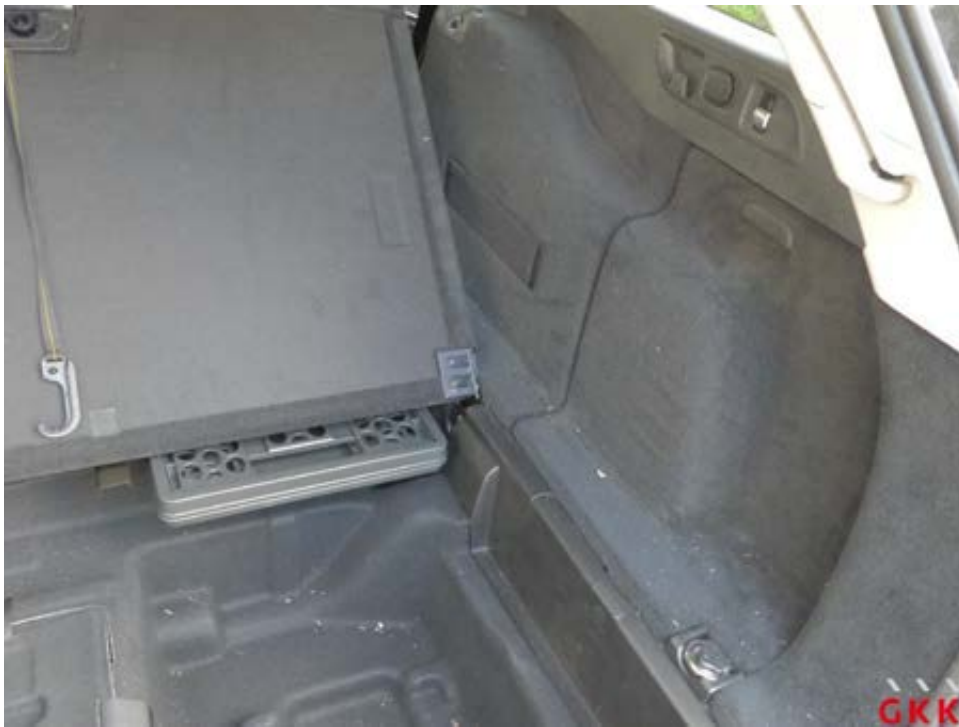
Bild 30 Laderaum, Innenverkleidung, beschädigt, ersetzen
