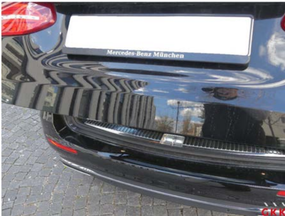
Bild 24 Heckklappe, unterhalb, verkratzt, lackieren
