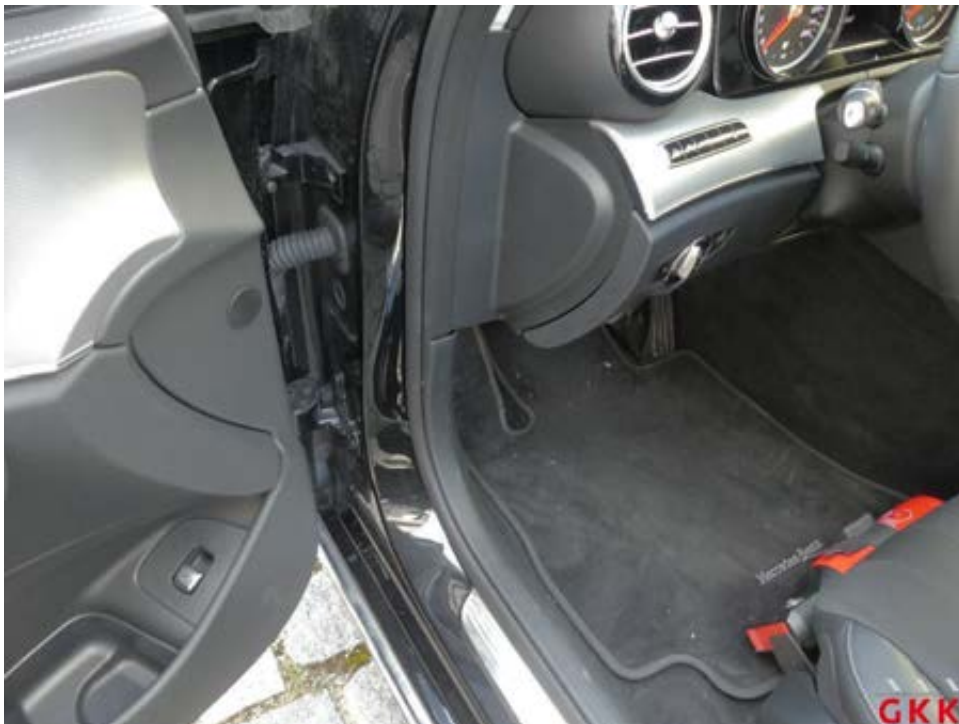
Bild 20 A- Säule links, Innenverkleidung -unterhalb-, beschädigt, ersetzen
