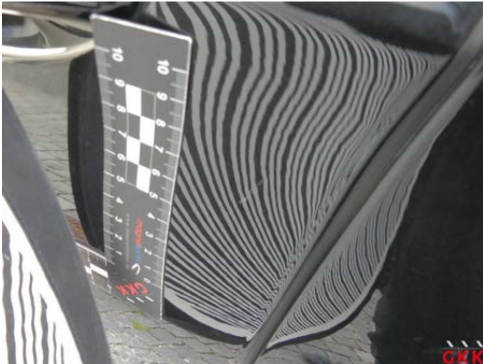
Bild 19 Tür vorne links, beschädigt, instand setzen - lackieren
