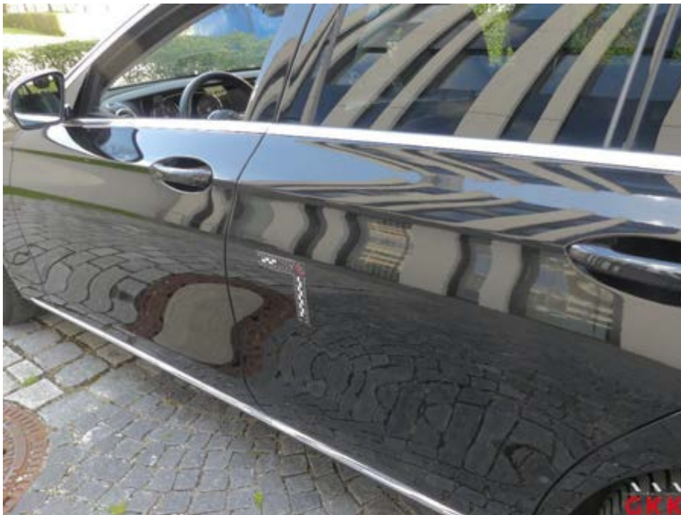
Bild 22 Tür hinten links, verkratzt, lackieren
