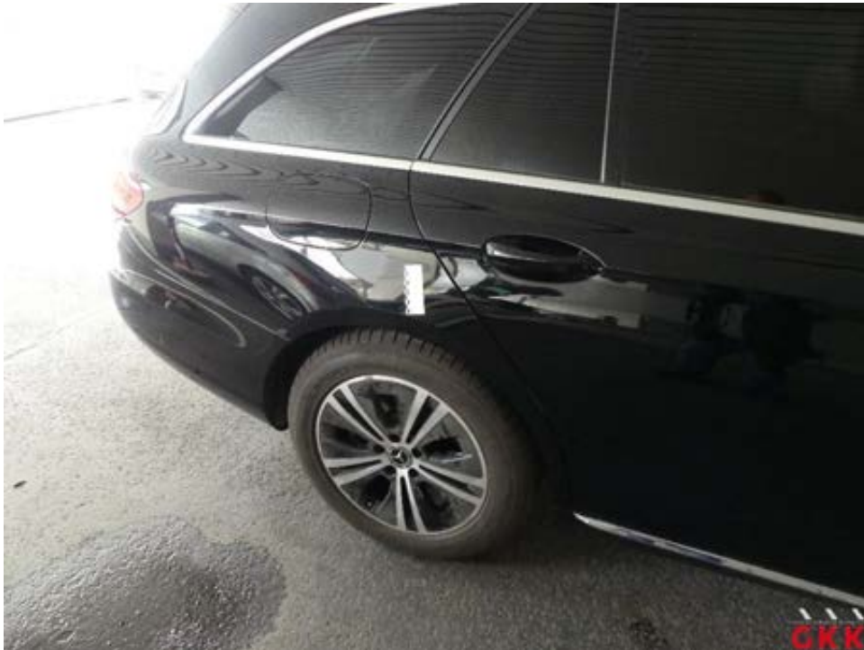
Bild 13 Seitenwand rechts, verkratzt, Smartrepair
