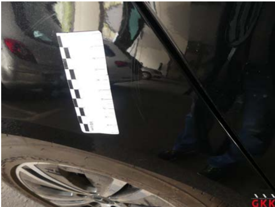
Bild 14 Seitenwand rechts, verkratzt, Smartrepair
