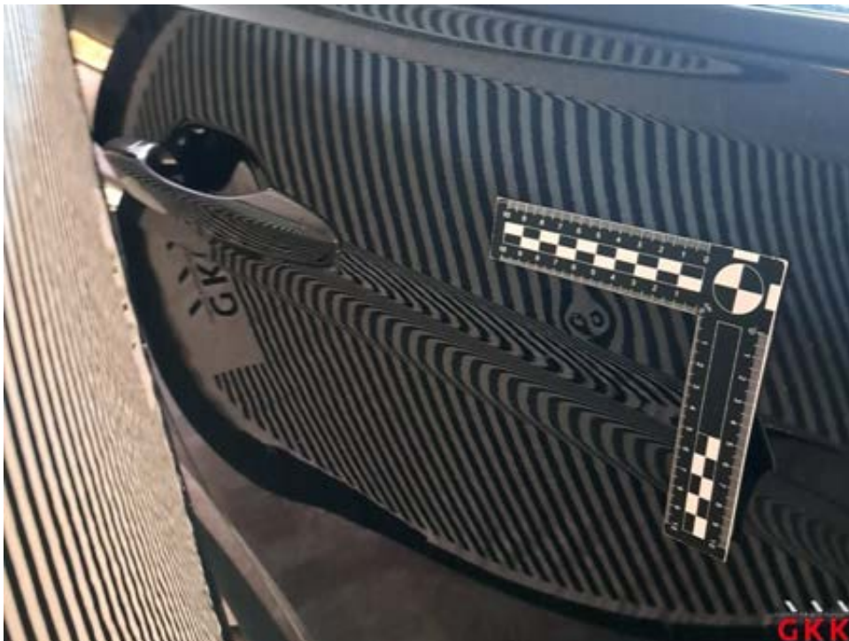
Bild 32 Tür hinten rechts, beschädigt, instand setzen - lackieren
