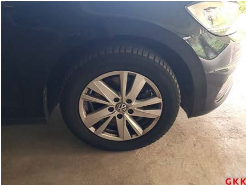
Bild 39 Reifen, vorn links und rechts, Untermaß, ersetzen
