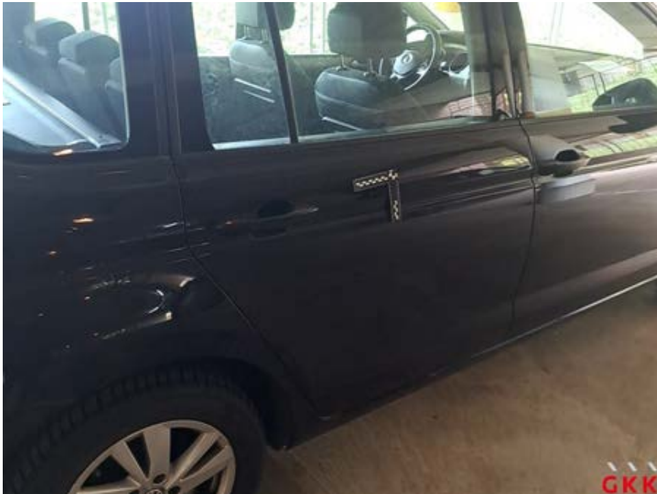
Bild 31 Tür hinten rechts, beschädigt, instand setzen - lackieren
