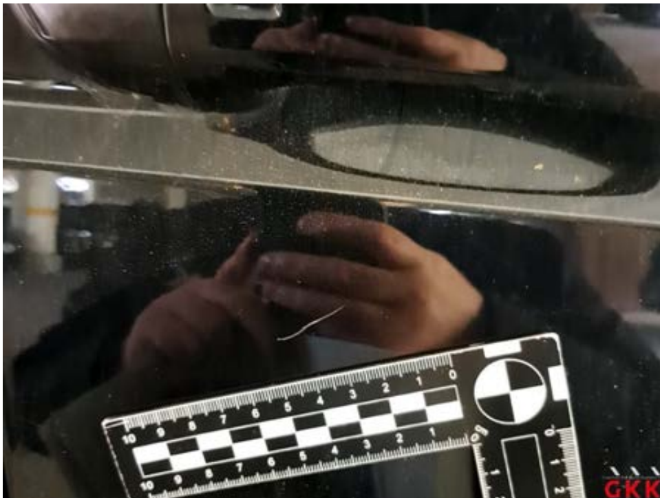
Bild 30 Tür vorne rechts, verkratzt, lackieren
