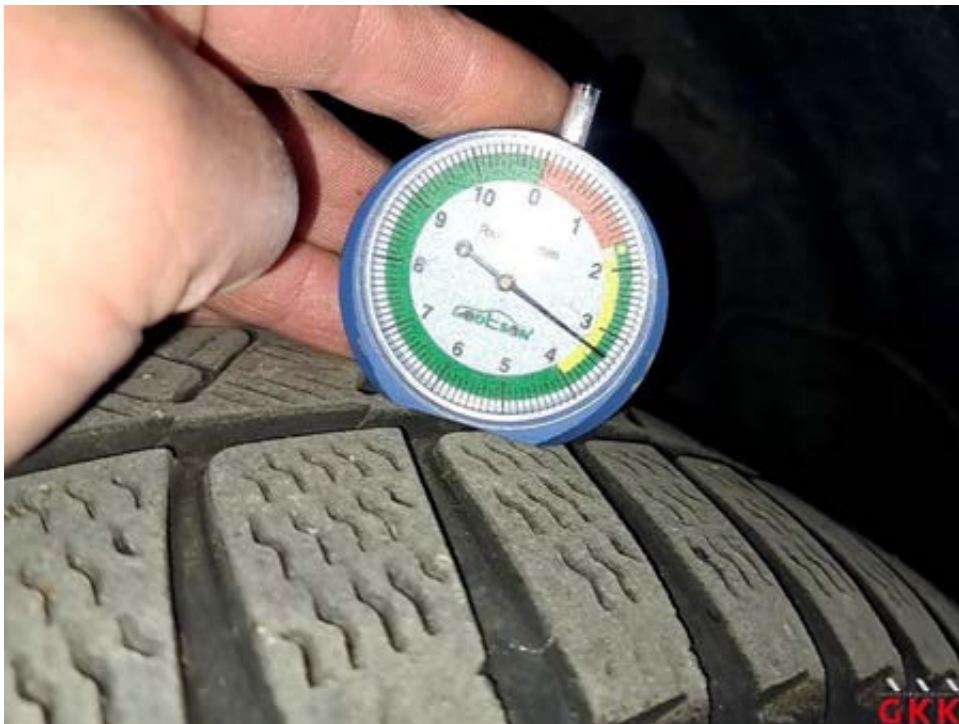
Bild 40 Reifen, vorn links und rechts, Untermaß, ersetzen
