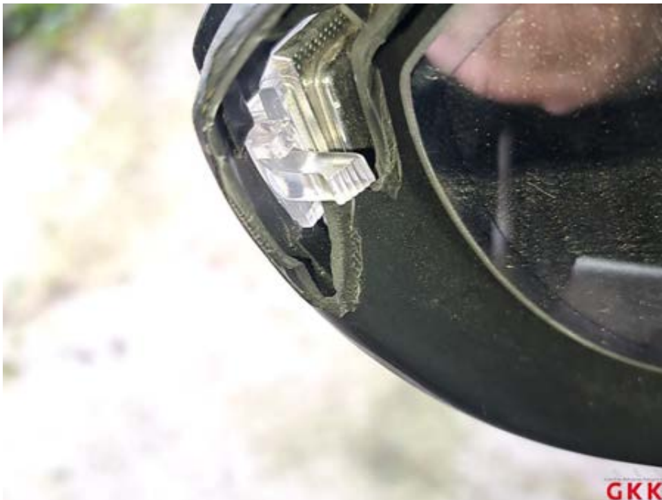
Bild 28 Spiegelgehäuse links, Rahmen, beschädigt, ersetzen
