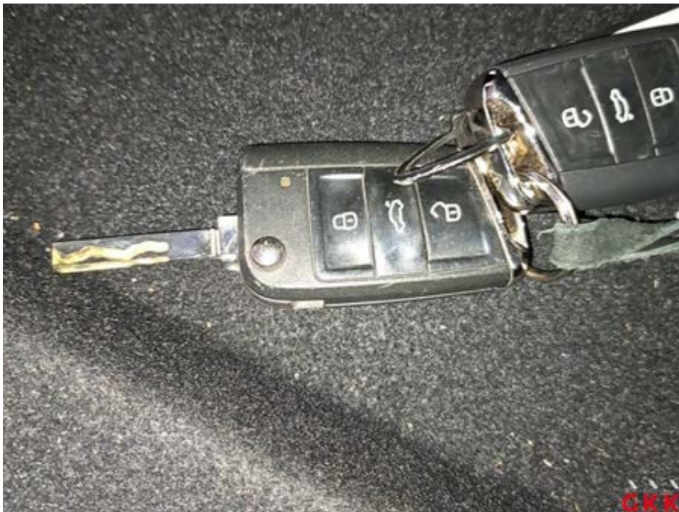
Bild 44 Hauptschlüssel, mit Fernbedienung, beschädigt, ersetzen
