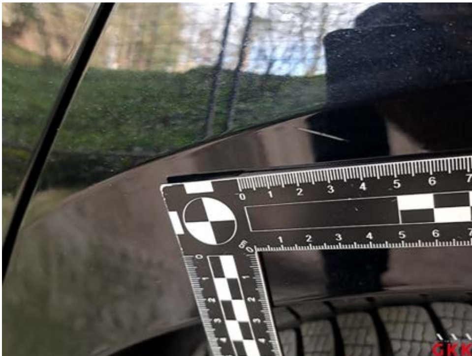
Bild 20 Seitenwand links, verkratzt, lackieren
