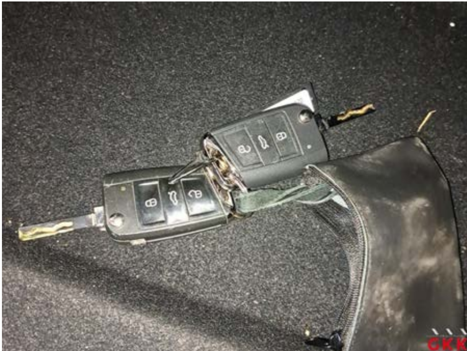
Bild 43 Hauptschlüssel, mit Fernbedienung, beschädigt, ersetzen
