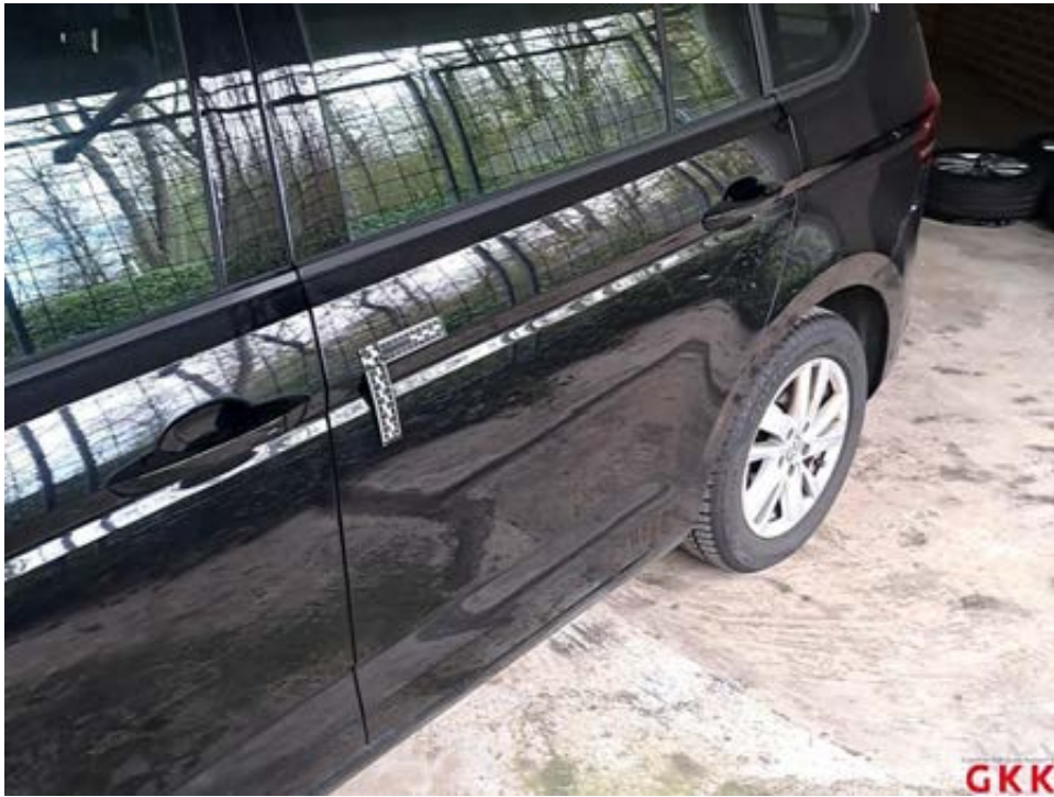
Bild 23 Tür hinten links, verkratzt, lackieren
