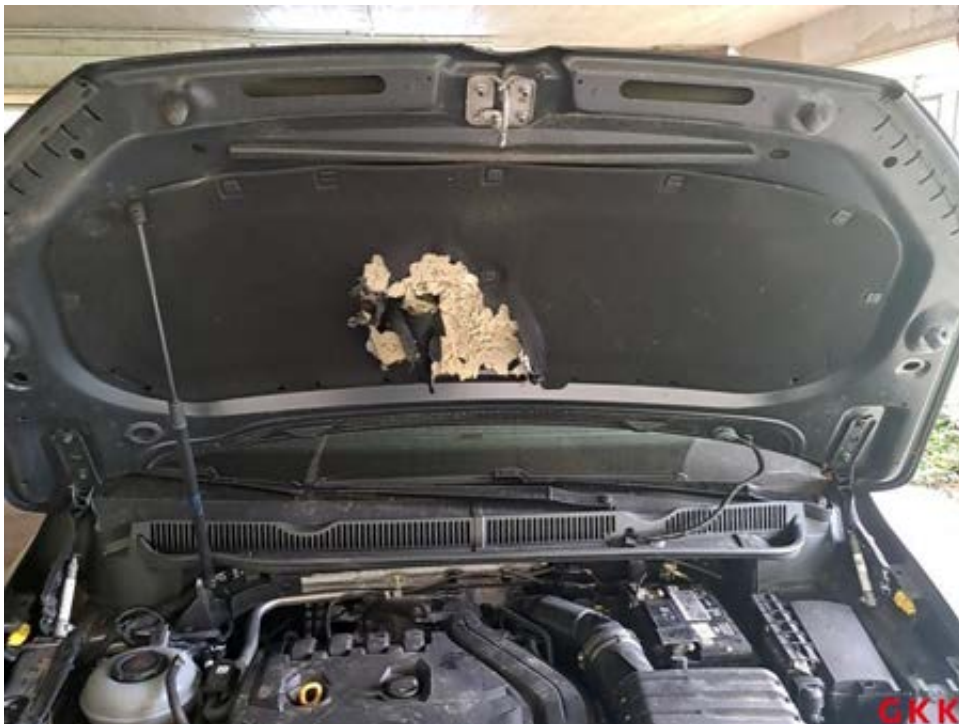
Bild 18 Motorhaube, Dämmmatte, beschädigt, ersetzen
