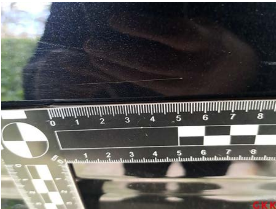
Bild 24 Tür hinten links, verkratzt, lackieren
