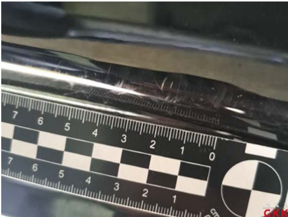
Bild 26 Tür vorne links, Einstieg, verkratzt, Smartrepair
