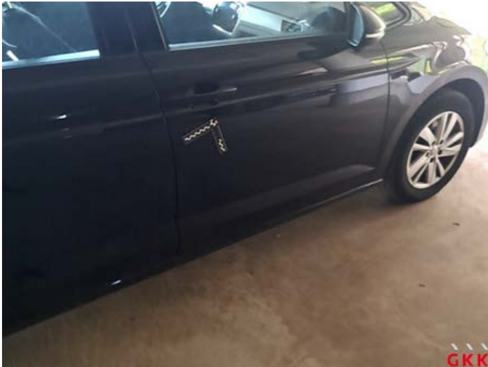
Bild 29 Tür vorne rechts, verkratzt, lackieren
