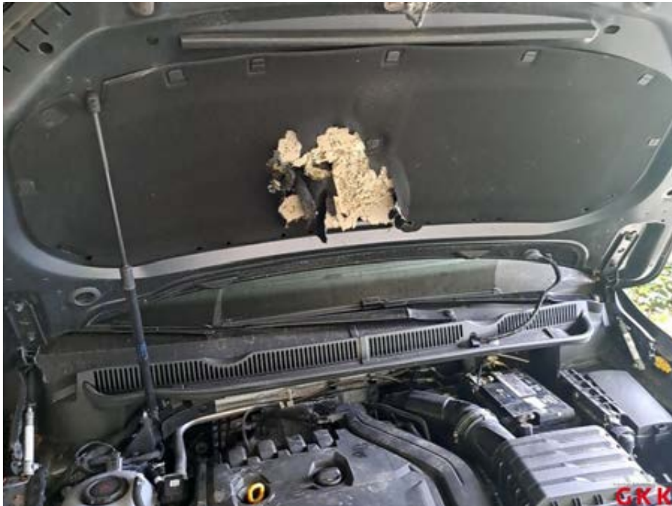
Bild 17 Motorhaube, Dämmmatte, beschädigt, ersetzen
