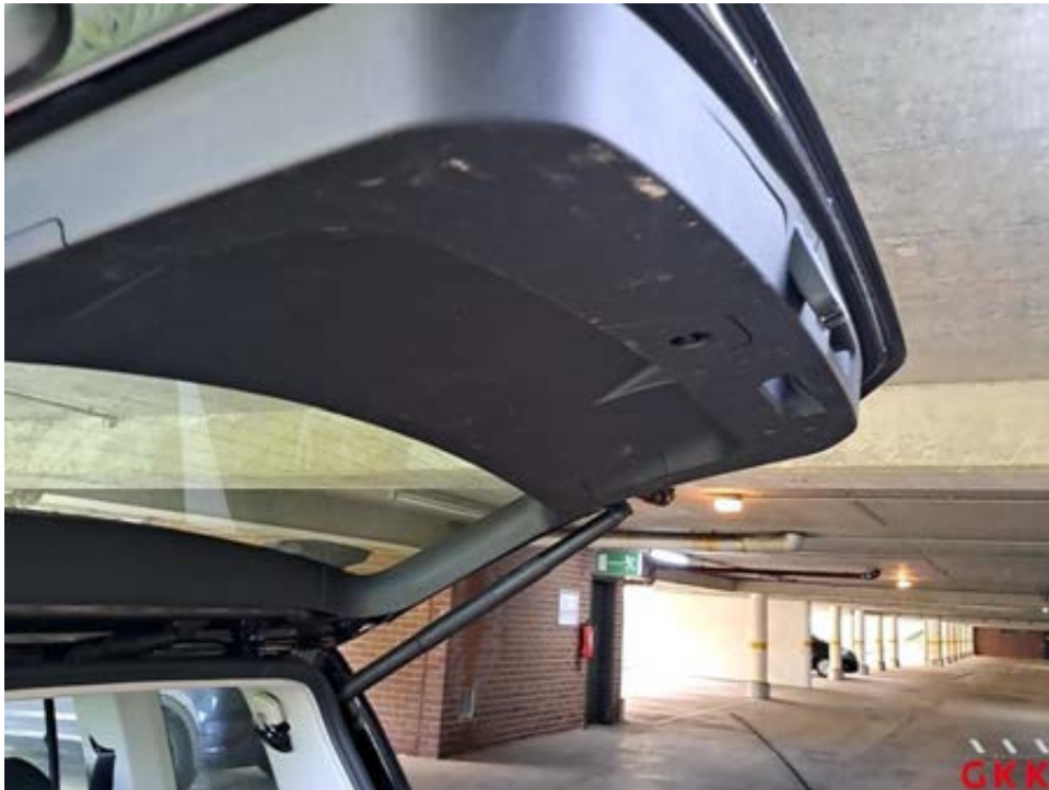
Bild 35 Heckklappe, Innenverkleidung, verkratzt, Smartrepair
