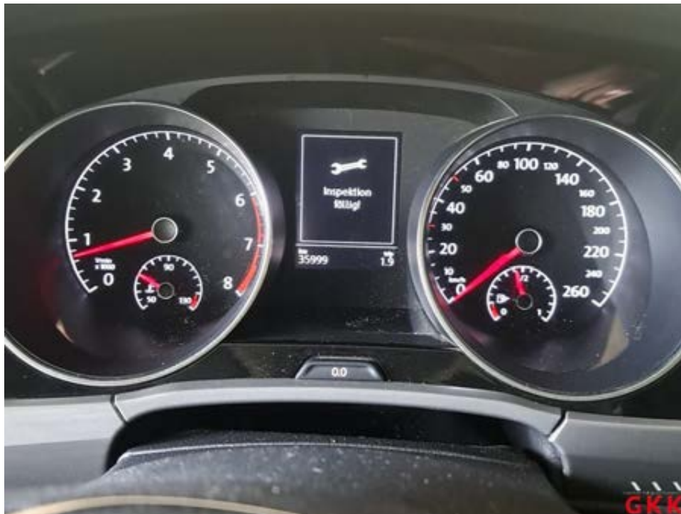
Bild 16 Inspektion klein, Mittelklasse, fällig, durchführen
