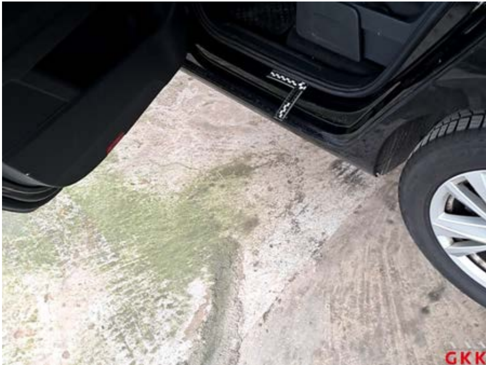
Bild 21 Tür hinten links, Einstieg, verkratzt, Smartrepair
