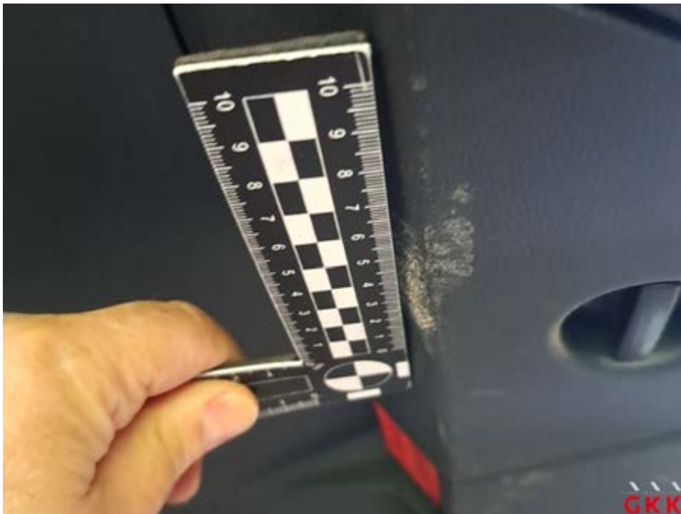
Bild 36 Heckklappe, Innenverkleidung, verkratzt, Smartrepair
