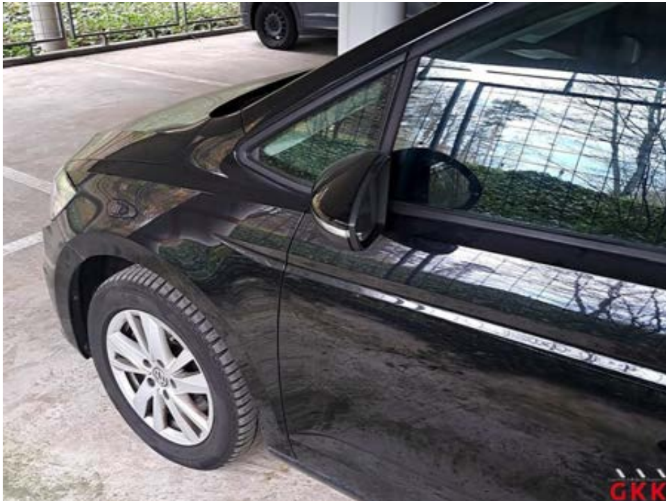
Bild 27 Spiegelgehäuse links, Rahmen, beschädigt, ersetzen
