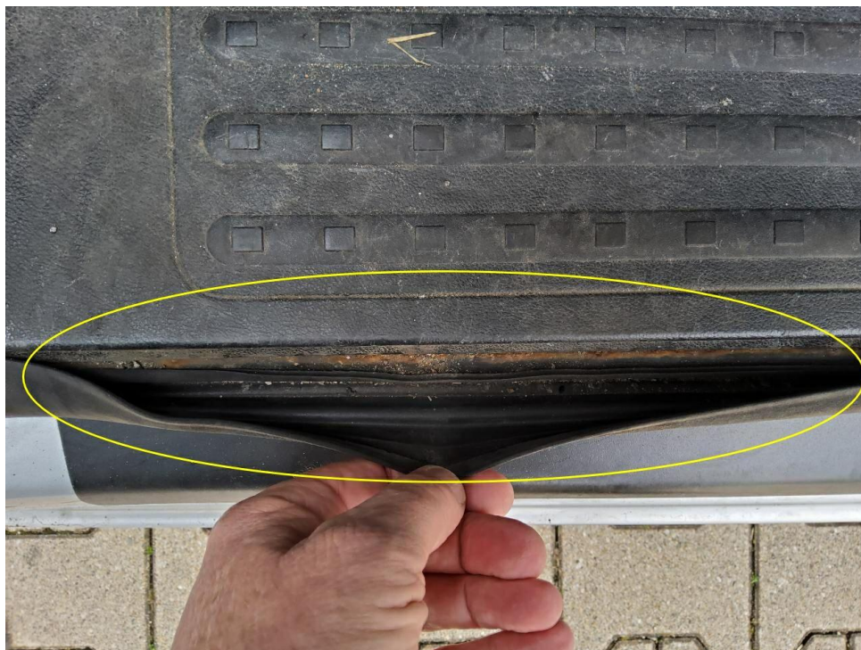
Bild 11 : Türkantenschutztür vorne links unten eingerissen
