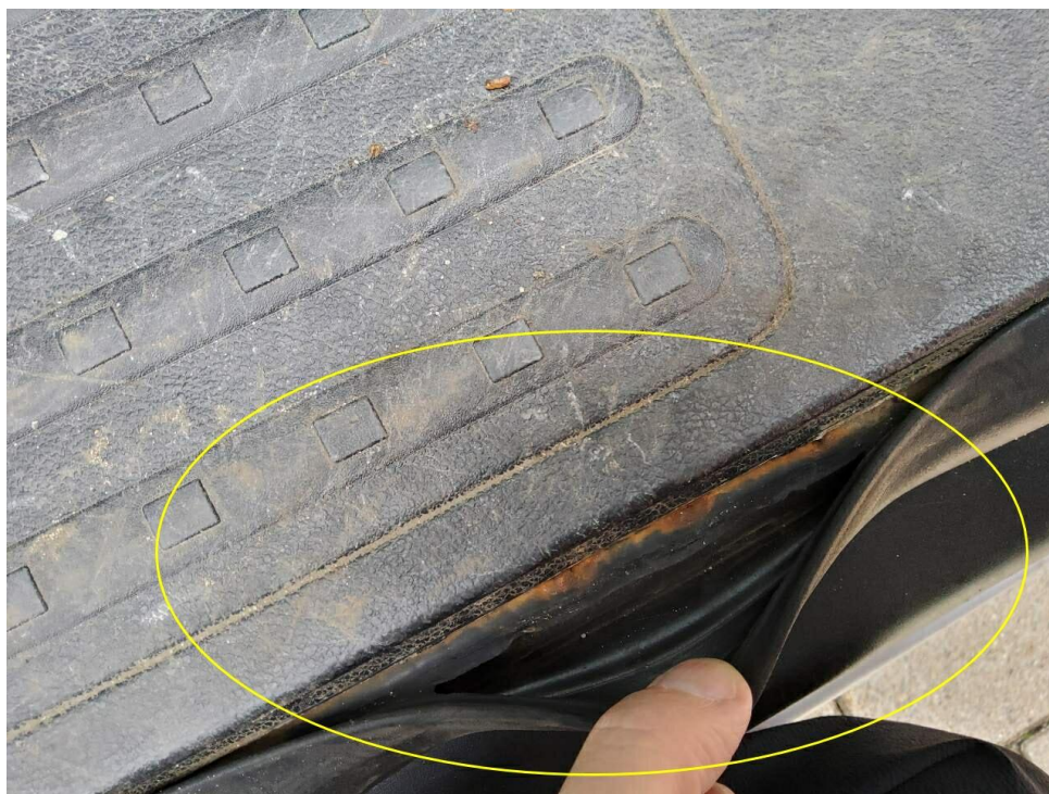
Bild 10 : Türkantenschutz Tür vorne rechts unten eingerissen
