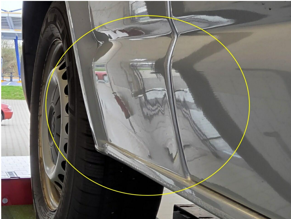
Bild 15 : Seitenteil hinten rechts unten wurde bis 4 mm gespachtelt, dadurch schleift die Schiebetür am Seitenteil
