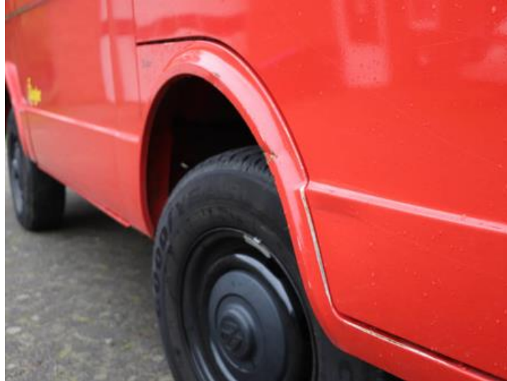
Schadenbereich Deformation Korrosion Radlauf vorne rechts
