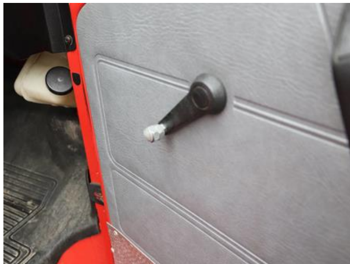
Fensterkurbel Not- und Behelfsinstandgesetzt
